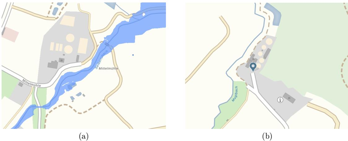
Abbildung 4.47: Hochwassergefahrenflächen an den Kläranlagenstandorten Mitterteich ( $R_1 = 1$ ) (a) und Neualbenreuth ( $R_1 = 0$ ) (b) [56]
