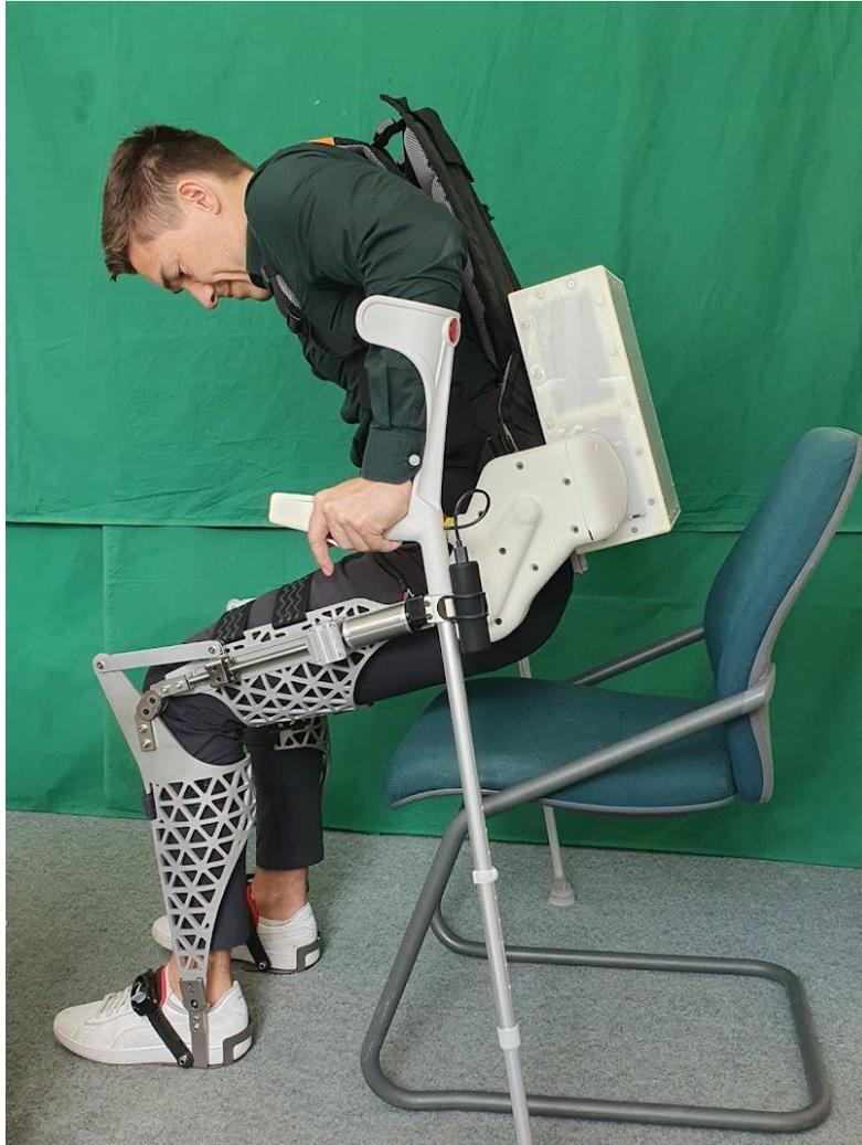
Abb. 6.29: Test der Aufstehbewegung aus einem Stuhl. Die Abstützung mit den Krücken ist notwendig, um den Schwerpunkt im Laufe der Bewegung über die Füße zu verlagern.
