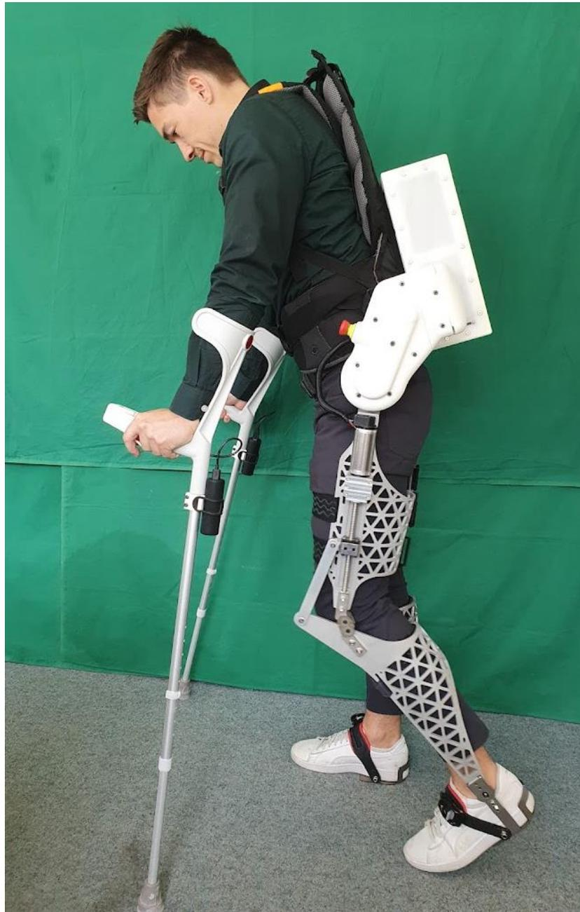
Abb. 6.30: Test der Gangfunktion des Exoskeletts. Die beidseitig positionierten Not-Aus-Schalter können selbst bei der Benutzung von Krücken jederzeit mit dem Ellenbogen erreicht werden.
