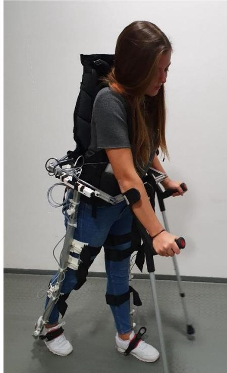
Abb. 6.10: Das Messexoskelett während der Aufnahme von Gangtrajektorien unter Verwendung von Krücken. Die an den Gelenken montierten Encoder nehmen die Bewegungen im Gelenkraum auf.
