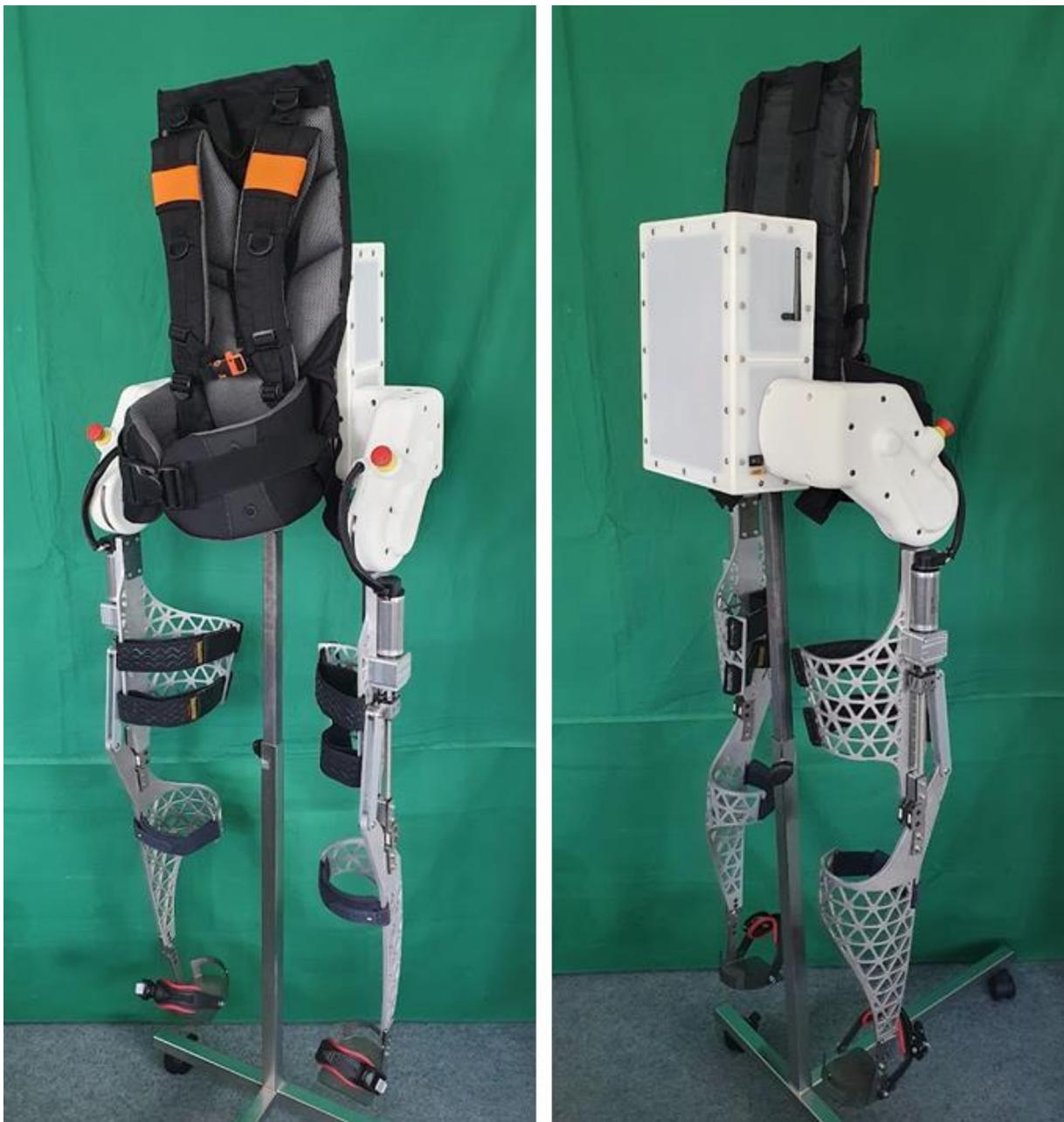
Abb. 6.26: Der Prototyp des Exoskeletts nach der vollen Integration aller Komponenten.
