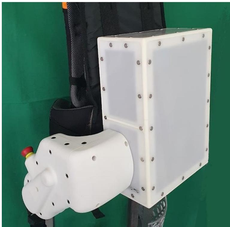
Abb. 6.21: Der Hüftbügel und die Rucksackeinheit werden primär aus Aluminiumprofilen zusammengesetzt. Für die Hüftgehäuseteile und zur Verblendung der Kanten kommt lasergesintertes PA12 zum Einsatz. Die Paneele werden aus lasergeschnittenem Plexiglas hergestellt.
