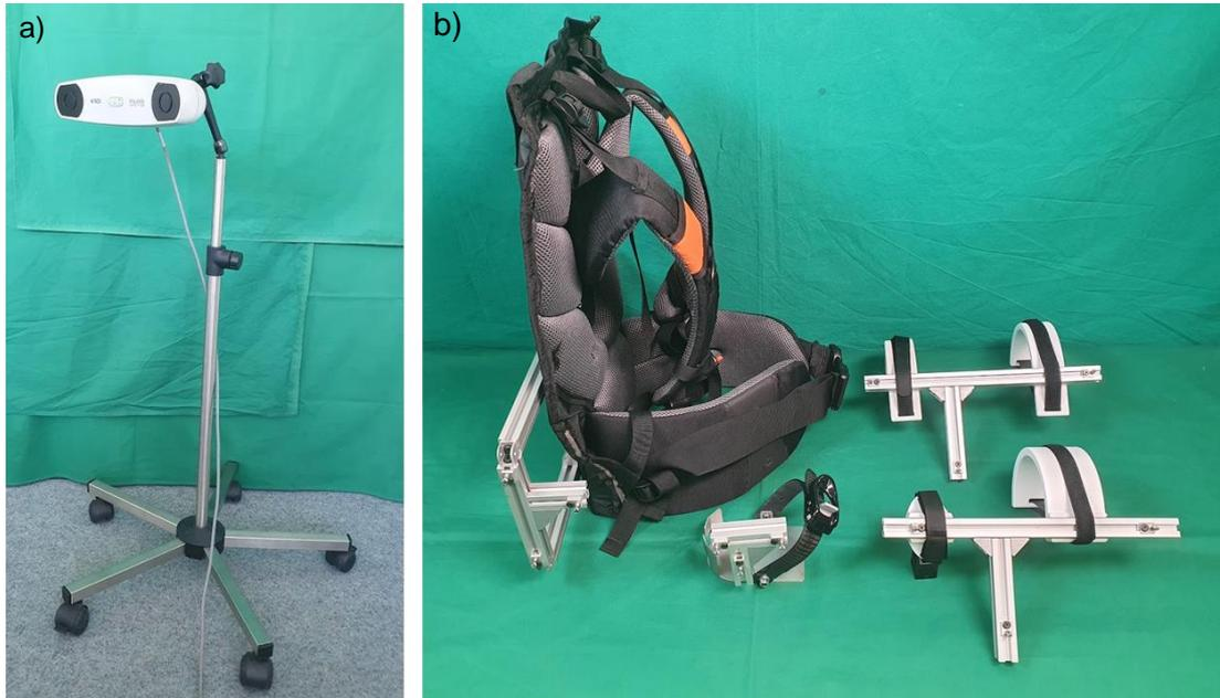
Abb. 6.4: a) Die NDI Polaris Vicra Kamera ist für die einfache Anwendung an einem Gelenkarm auf einem Rollstativ befestigt. b) Die vier Tracker zur Erfassung der relativen Position der Glieder der unteren Extremitäten werden mithilfe eines Rucksackgestells, modularen Beinschalen und einer Fußplatte am Körper befestigt. An jedem Tracker befinden sich drei gläserne Reflektorkugeln, anhand derer die Position und Orientierung jedes Trackers von der Kamera bestimmt werden kann.
