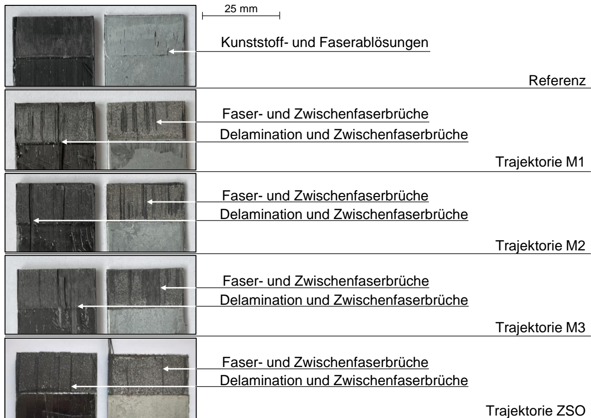
Abbildung 9-2: Bruchbilder der MKV für die maximalen trajektorispezifischen Zugscherfestigkeiten gemäß Tabelle 9-1
