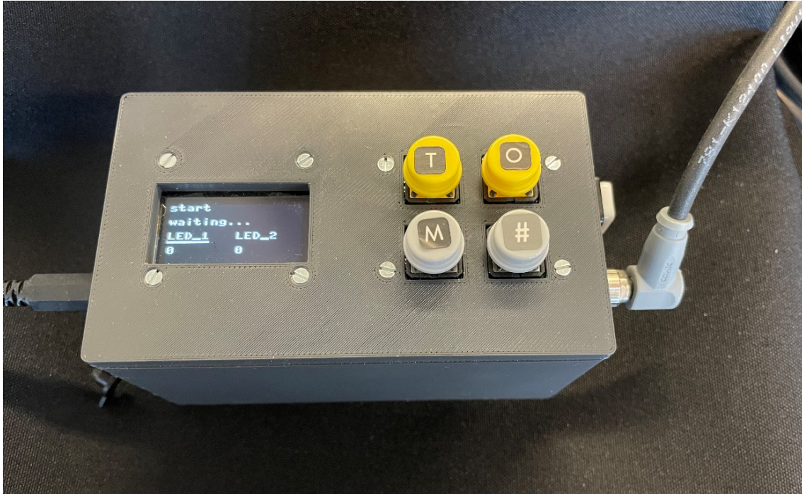
Abb. 27: Steuereinheit mit Drucktasten, EIN/AUS-Schalter, OLED-Display, Stromversorgung und Stromausgang zum Beleuchtungsmodul. Die Tasten dienen zum Umschalten zwischen den Beleuchtungsmodi (Taste M: Start, konstanter Beleuchtungsmodus und Tag-Nacht-Beleuchtungsmodus) und den LED-Reihen (Taste #: Reihe 1 und Reihe 2). Die beiden anderen Tasten sind Zähler für schnelle und präzise Einstellung der Lichtintensität. Der erste Zähler erhöht die Intensität in 10%-Schritten (Taste T). Der zweite erhöht die Intensität in 1%-Schritten (Taste O).
