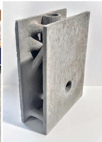
Bild 1: Versuchsdrucker V2 (links) und im Gerät gefertigtes Wandelement (rechts) | Fig. 1: Experimental 3D printer V2 (left) and wall element fabricated with the device (right) | Source: Daniel Talke, Klaudius Henke
