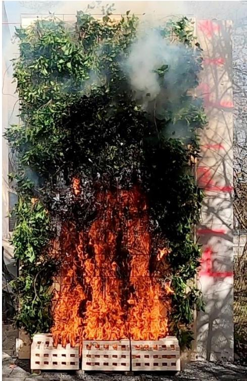
Abb. 5: Fotodokumentation des Brandversuchs Test 3 mit Holz- und Grünfassade zur 3. Prüfminute
