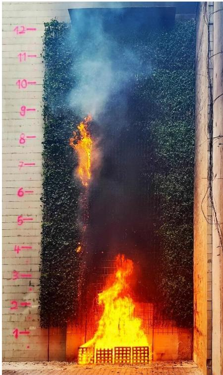
Abb. 8: Foto des abschließenden Großbrandversuchs V1 des Forschungsvorhabens FireSafeGreen mit der 12 m hohen flächigen Anordnung und vitalen Kletterpflanzen
