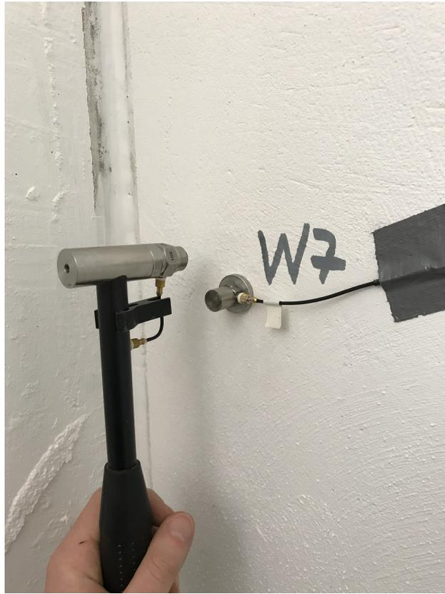
Abb. 20: Beschleunigungssensor sowie Impulshammer zur Admittanzbestimmung der Installationswand in Prüfstand P12
