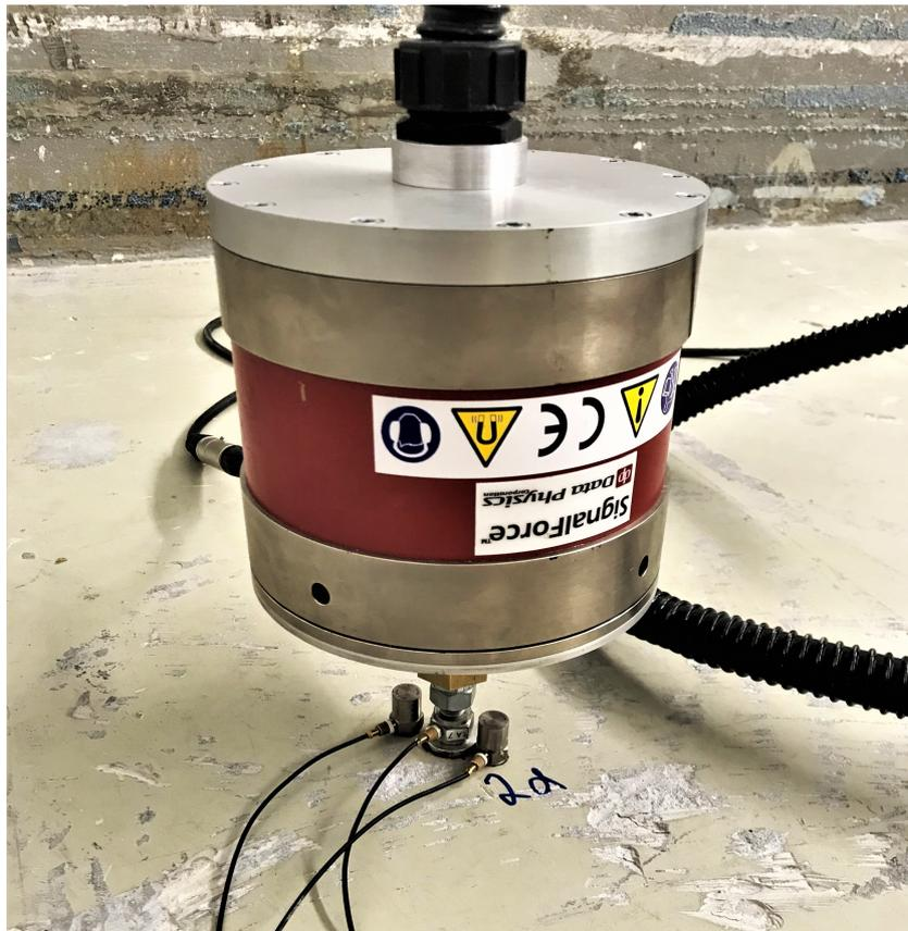
Abb. 13: Beschleunigungssensoren, Kraftsensor sowie Shaker für die Admittanzbestimmung der Bodenplatte in Prüfstand P9
