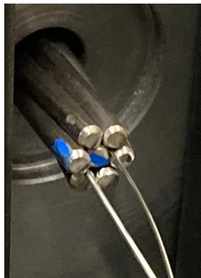
Abb. 1: In Spannstahl-Litze integrierte Glasfaser zur Dehnungsmessung
