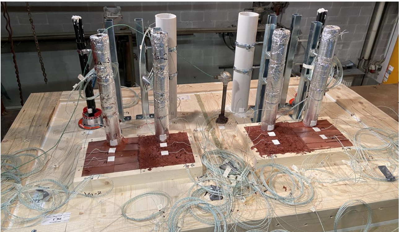
Abbildung 3-1 Prüfung 1 im Ofenraum (analog zu Prüfung 2) vor dem Versuch
