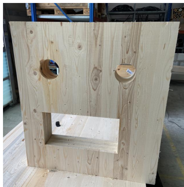
(b) Ansicht eines Prüfkörpers vor dem Einbau der Messtechnik sowie der Abschottungen
