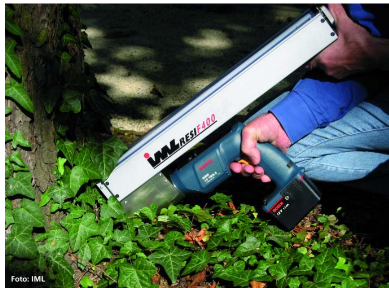
Abbildung 3: Resistograph zur Bestimmung der Holzdicke; eine Bohrnadel wird in den Holzkörper getrieben. Die dabei auftretenden Bohrwiderstände werden kontinuierlich aufgezeichnet. Sie geben Aufschluss über die Holzbeschaffenheit.
