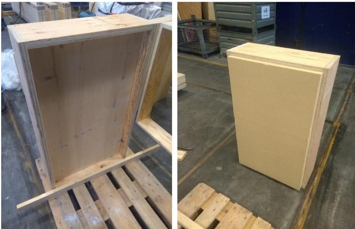
Abbildung 61 Holzrahmenbauwand teilbefüllt (links) mit Dämmfaserplatte (rechts)
