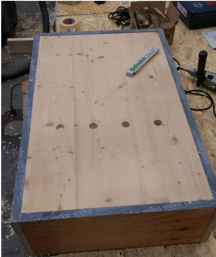
Abbildung 68 Wandtestelement mit Bohrungen für die Sensoren
