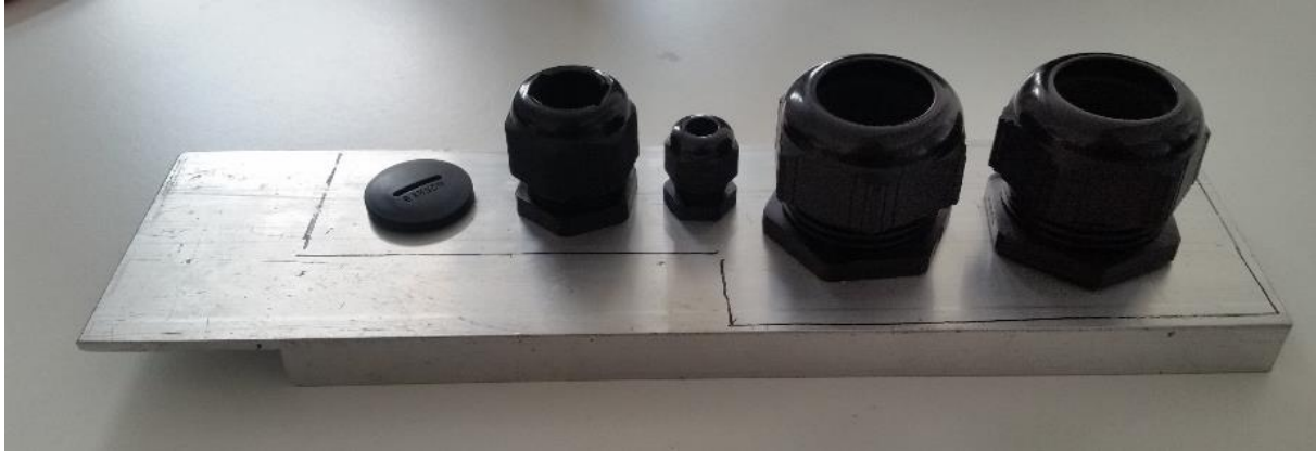
Abbildung 73 Aluminiumplatte mit eingebauten Verschraubungen
