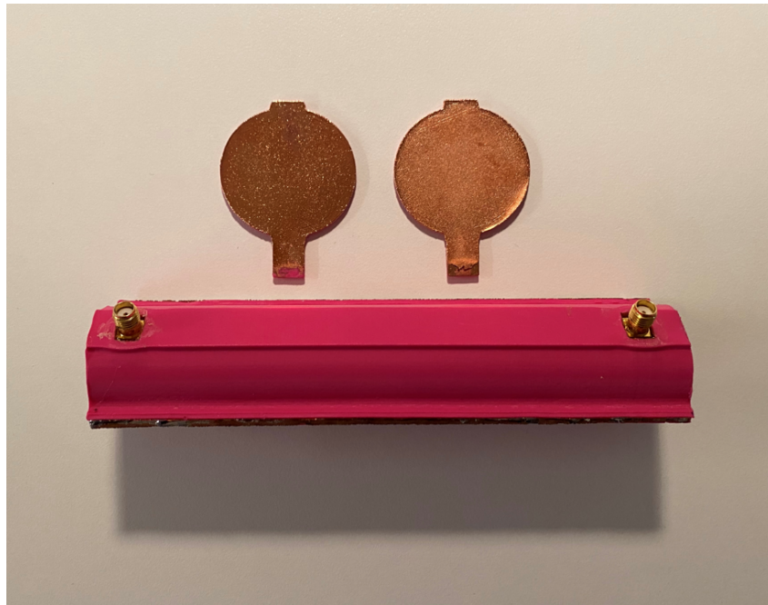
Abb. 2–35: Prototyp des Wellenleiters mit der Hauptstruktur in Form eines Hohlleiters und den kreisrunden Endstücken
