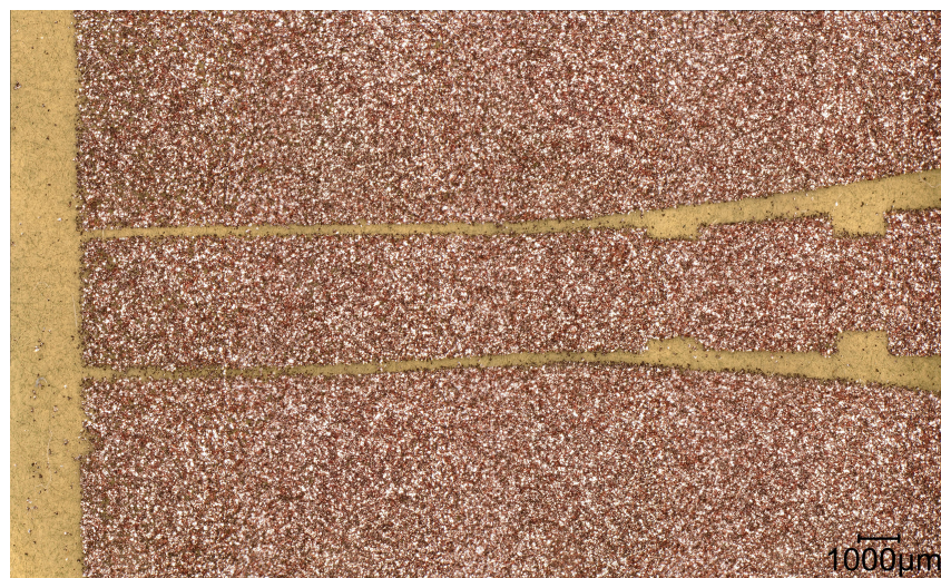
Abb. 2–28: Ergebnis der Lackierung der Anbindung des planaren Wellenleiters bei Befestigung der Schattenmaske mit Magneten
