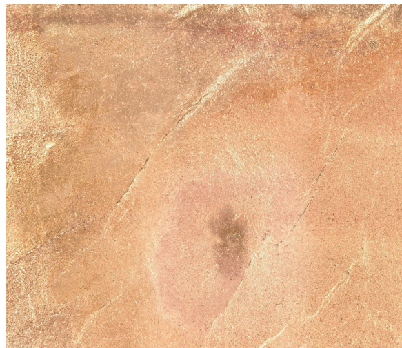
Abb. 2–1: Anlauferscheinungen nach Galvanisierung, Spülung und Trocknung von PET34 durch Oxidationsprozesse auf der Oberfläche
