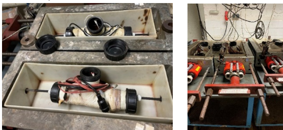
Abbildung 1: Aufbau der Prüfvorrichtung für den CLT
