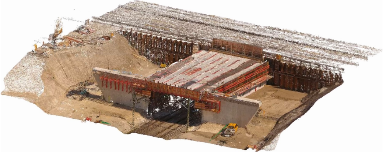
Abbildung 4: Photogrammetrisch erzeugte Punktwolke eines Brückenbauwerks (Quelle: TUM).
