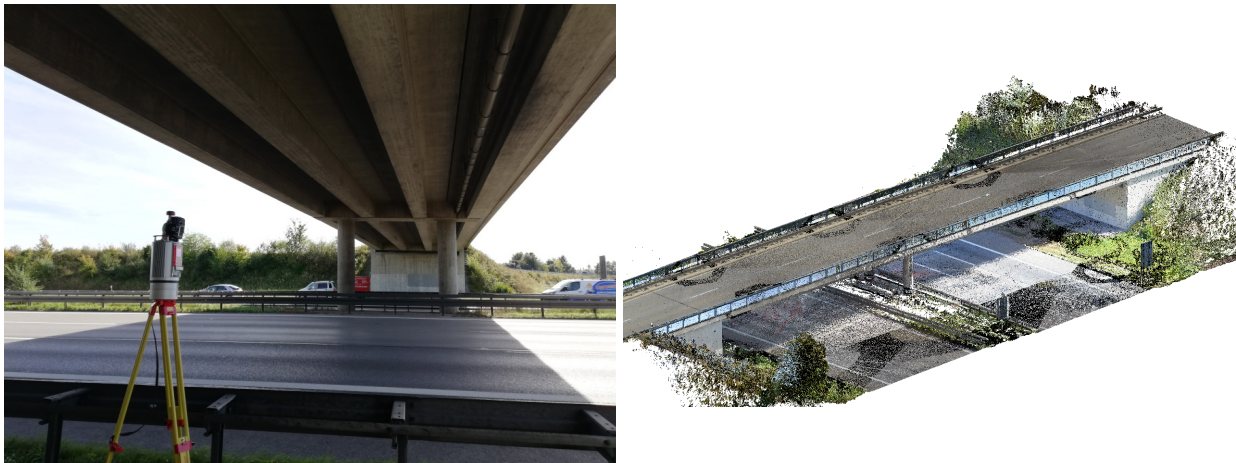
Abbildung 9: Beispielfoto und Punktwolkenausschnitt des erfassten Referenzobjekts, welches am 01.10.2021 an der A99 erfasst wurde.
