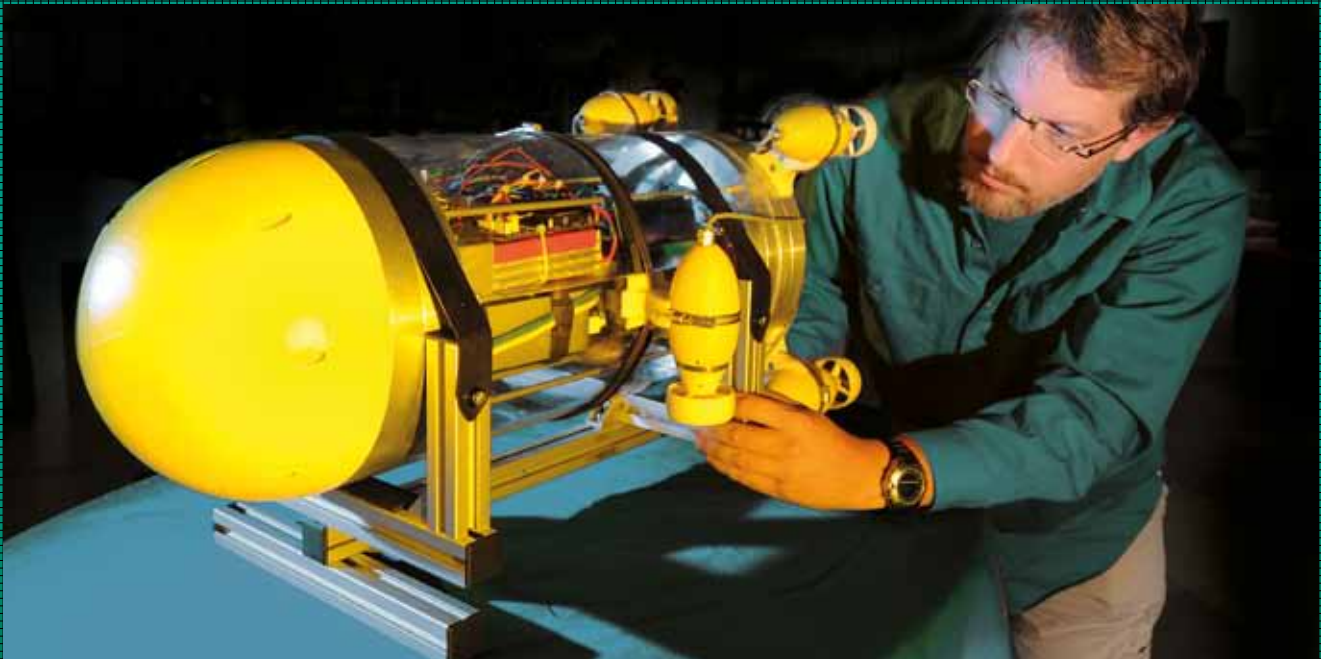
Letzter Feinschliff vor dem Gang ins Wasser: Bevor Snookie ins Becken darf, überprüft der Physiker Moritz Franosch die Technik. Unter Wasser orientiert sich das wendige Mini-U-Boot mittels einer Sensorik, die dem Seitenlinienorgan der Fische nachempfunden ist
