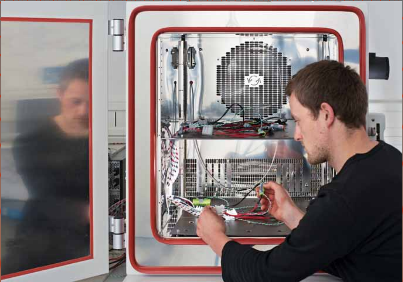
Auf der Suche nach der optimalen Ladestrategie hilft eine Klimakammer, in der das Verhalten von bis zu 32 einzelnen Batteriezellen bei Temperaturen zwischen - 20 °C bis 50 °C untersucht wird
