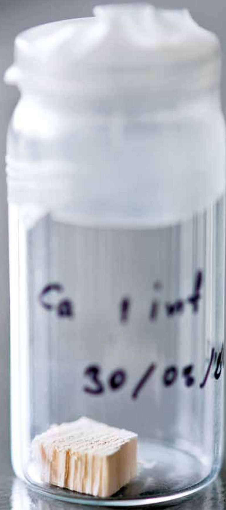
Holzprobe nach der Infiltration. Nach dem anschließenden Verbrennen des Holzes bleibt ein Abbild der Struktur aus Calciumcarbonat zurück
