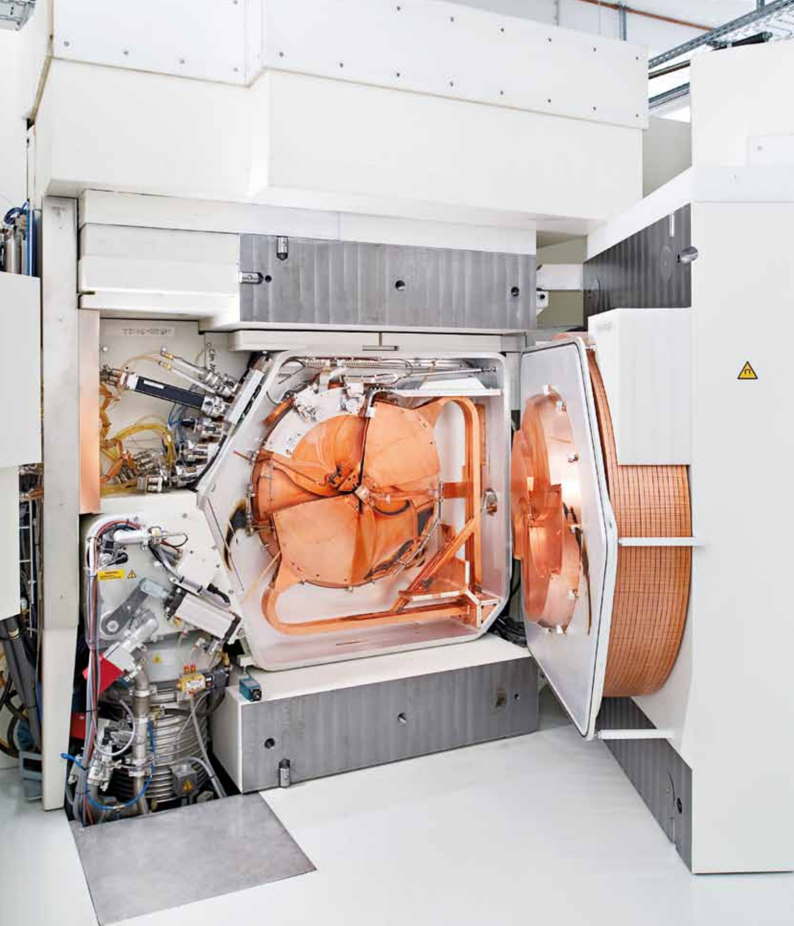
Innenleben des Kompaktzyklotrons am Klinikum rechts der Isar: Hier werden Wasserstoffionen beschleunigt und mittels Kernreaktionen radioaktive Isotope produziert. Diese werden dann als Gas oder in Flüssigkeit gelöst in dünnen Kapillaren zur Weiterverarbeitung in das benachbarte GMP (Good Manufacturing Practice) Labor geleitet
