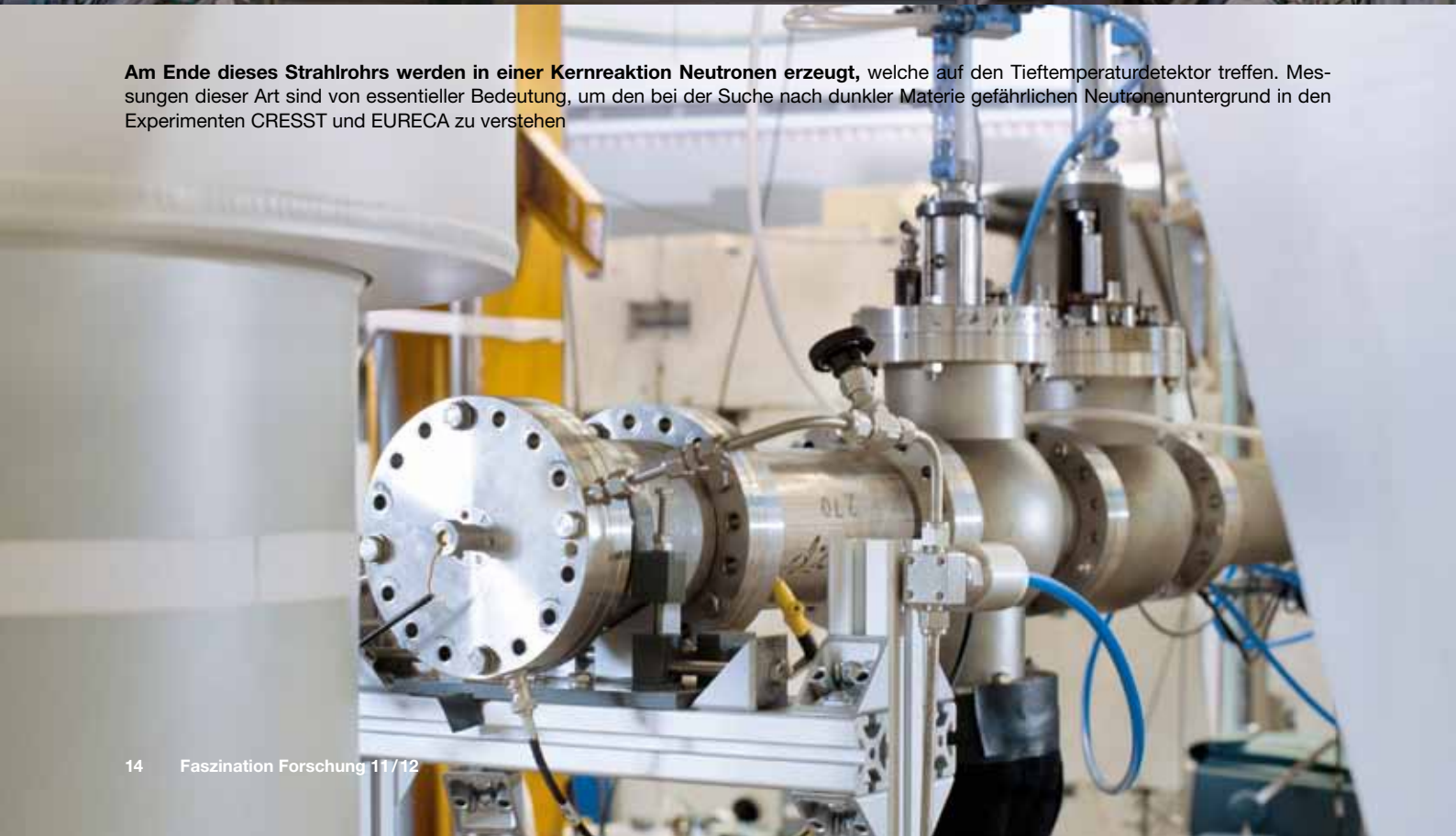
Am Tandem-Beschleuniger in Garching charakterisiert das Team von Jean-Côme Lanfranchi die Detektoren. Man schießt Neutronen darauf und misst die Reaktion. Diese Anlage ist einmalig auf der Welt
