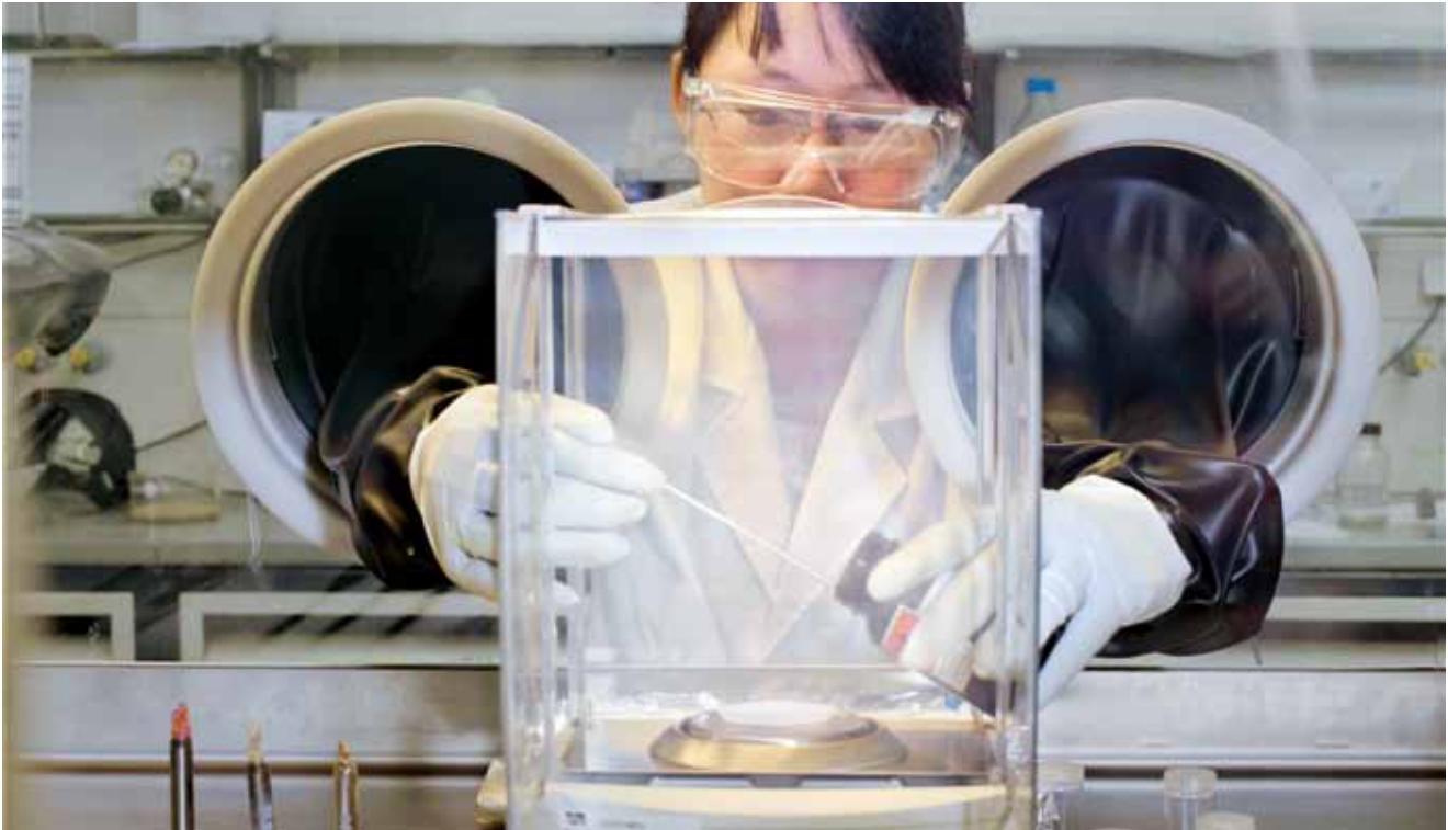
Das sorgfältige Abwiegen der Bestandteile für eine neue Legierung erfolgt in einem Handschuhkasten unter Schutzgas, damit die Substanzen nicht ungewollt oxidieren
