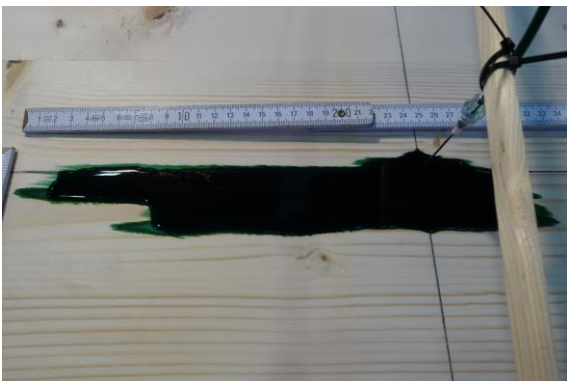
Abbildung 4-16: Feuchteausbreitung nach 3,5 h
