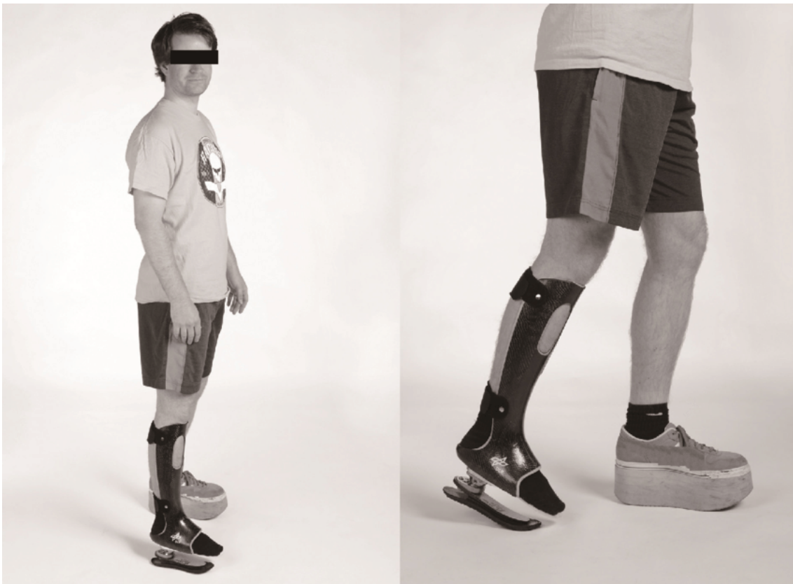
Abbildung 3: Proband mit Hephaistos: Ein Versuchsteilnehmer trägt die Hephaistos-Orthese am Interventionsbein und am kontralateralen Bein den entsprechenden Plateauschuh (Weber, Ducos et al. 2013)
