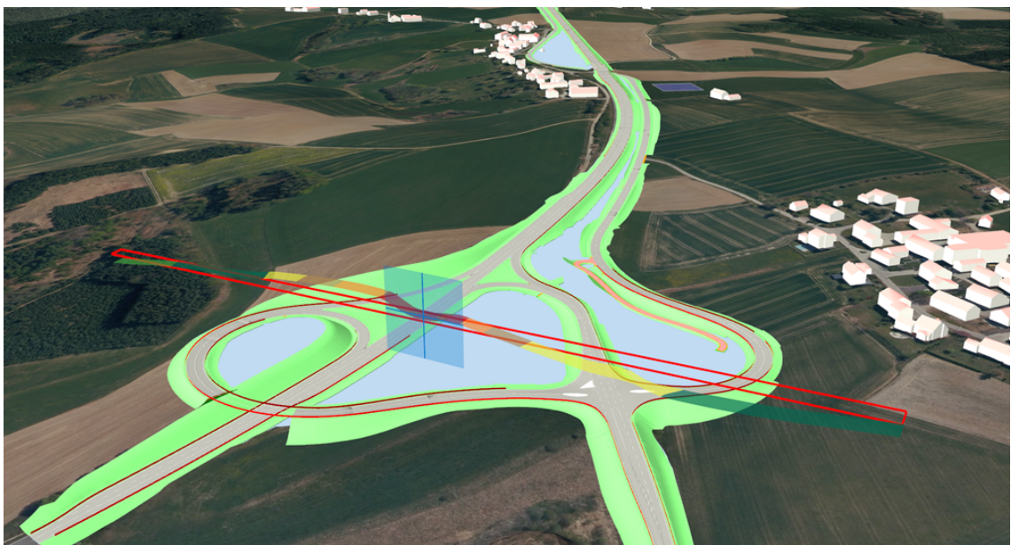
Abbildung 8.7: Schallberechnung nach realisierter Auszustanzung im DGM
