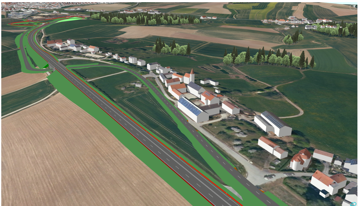
Abbildung 8.4: Aus Fachmodellen der Ausbauplanung und Bestandsmodell zusammengesetztes GM
