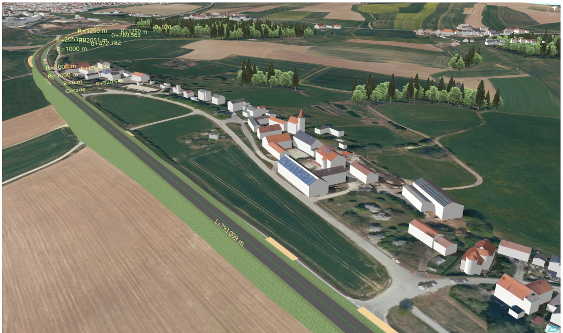
Abbildung 8.3: Aus Achse und Regelquerschnitt generierter Trassenkörper im GM
