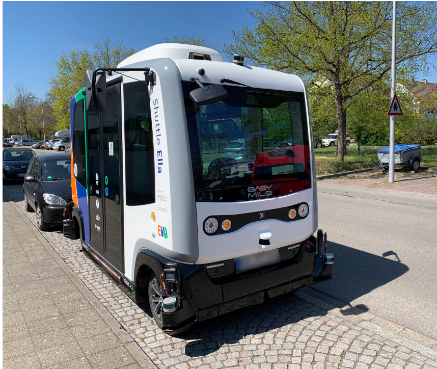
Abbildung 1.1: Prototyp eines autonomen Kleinbusses ausgestattet u.a. mit LiDAR-Sensoren und Kameras
