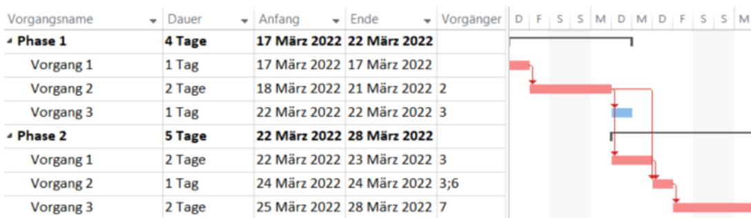
Abbildung 2.9: Beispiel eines vernetzten Balkenplans
