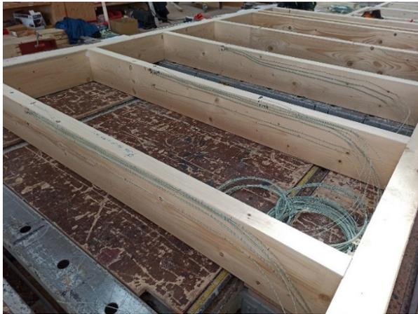
**Abbildung A.11.2-1: HTB-Element mit Thermoelementen (feuerzugewandte Seite ist im Bild nach oben gerichtet)**
