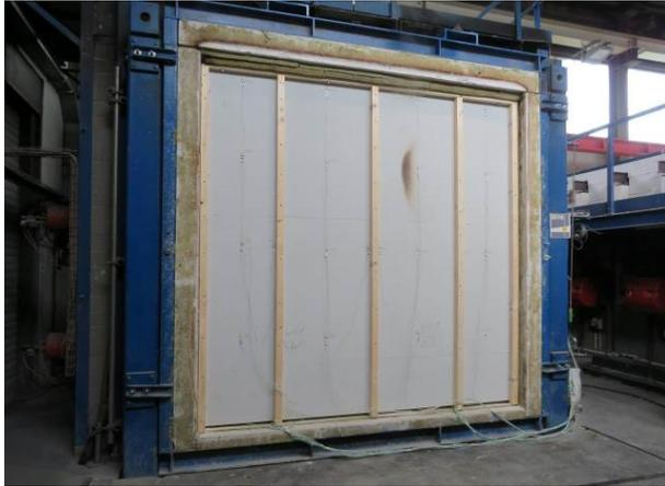
**Abbildung A.5.7-11: Prüfminute 92, Schwarzfärbung GF im 835er-Gefach ZF**
