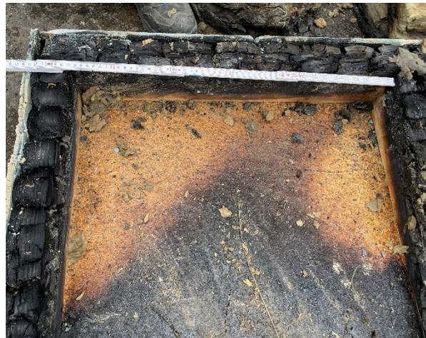
**Abbildung A.14.7-28: Wand nach Versuchs-ende feuerzugewandte Seite ohne Dämmung; Detail Ecke**
