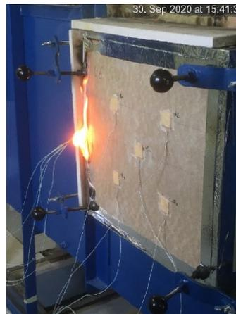
**Abbildung A.10.5-18: Feuerabgewandte Seite von V7 (Prüfminute 109)**
