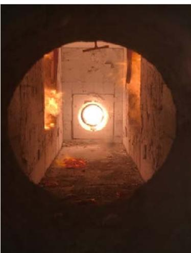
Abbildung A.19.7-11: Prüfminute 22, weitere größere Teile platzen ab PK 8
