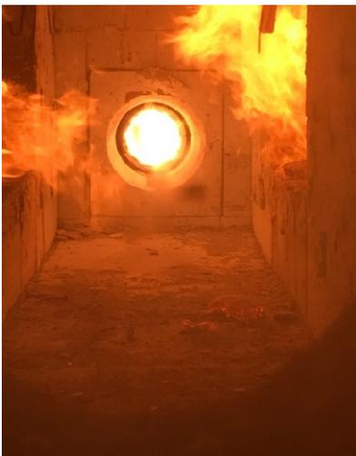
Abbildung A.18.7-9: Prüfminute 26, erste Teile LVL PK 6 fallen ab
