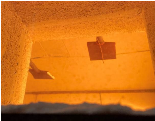
**Abbildung A.14.7-9: Prüfminute 27, Verformung der GKF in der Decke**
