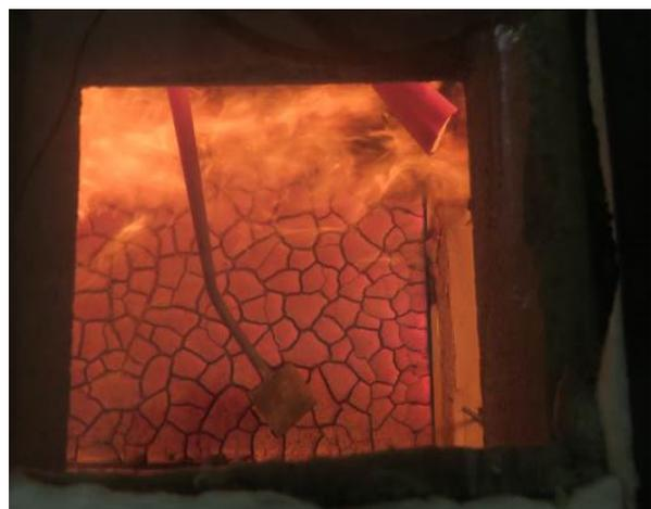
**Abbildung A.3.7-10: Prüfminute 10, starke Rissbildung der MDF in der Wand**
