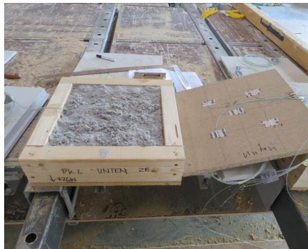
Abbildung A.1.7-4: PK 2 mit Zellulosefüllung
