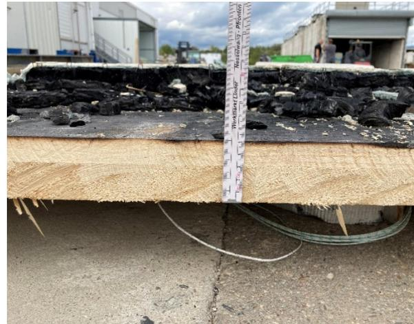
Abbildung A.13.8-20: Restquerschnitt der Decke nach der Brandprüfung
