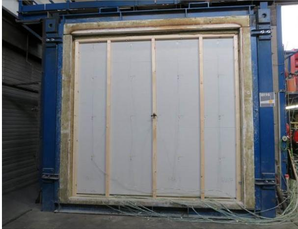
**Abbildung A.6.7-5: Eingebauter Prüfkörper vor Versuchsbeginn, FA**
