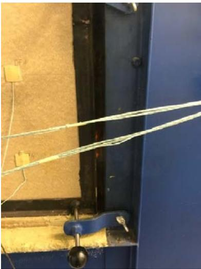
Abbildung A.19.7-15: Prüfminute 40, PK 8 leichter Flammenaustritt rechter Rand unten bei Ende des Versuchs
