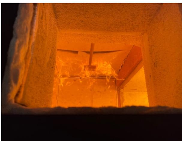
Abbildung A.15.7-5: Prüfminute 57:13, Durchbiegung GKF an der Decke
