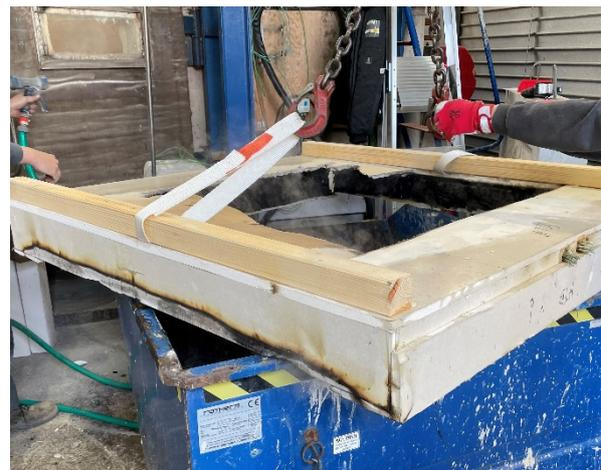
**Abbildung A.12.7-30: Decke nach Versuchs-
