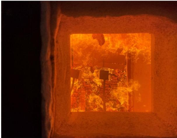
Abbildung A.15.7-13: Prüfminute 96:00, teilweise Abfallen der ersten Schicht BSP an der Decke
