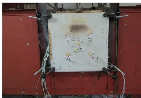
Abbildung A.1.7-12: Prüfminute 114, Schwarzfärbung der GF im PK2 ZF
