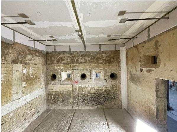
Abbildung A.11.7-1: Probekörper, eingebaut im Brandprüfstand feuerzugewandt
