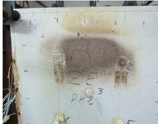
Abbildung A.1.7-14: Prüfminute 116, Schwarzfärbung und Rissbildung der GF des PK 2 ZF
