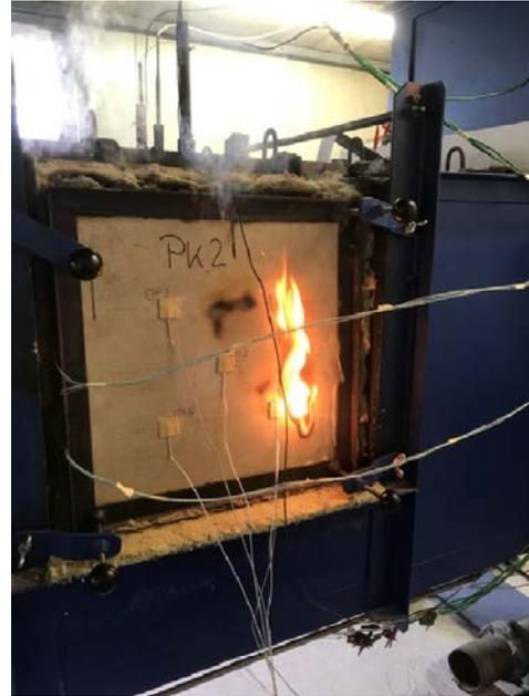
**Abbildung A.16.7-16:** Prüfminute 58, Durchbrand an PK 2
