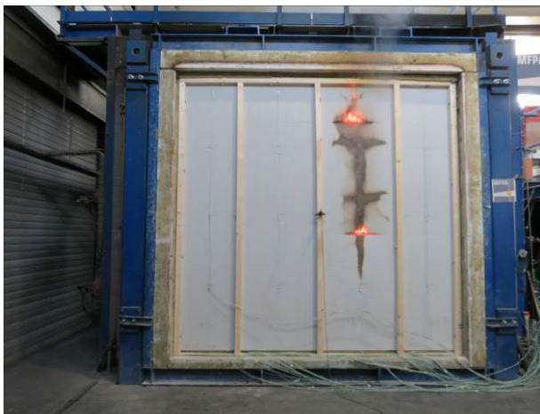
**Abbildung A.6.7-9: Prüfminute 73, Flammenaustritt an Fugen im 77<sup>er</sup>-Gefach HWF unterhalb OF 11 und oberhalb OF 9**
