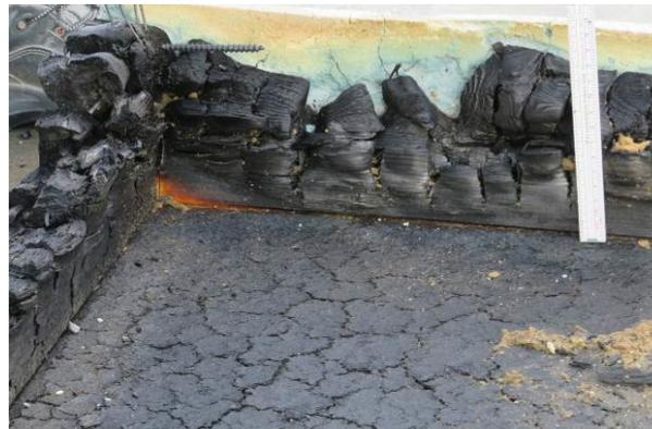
**Abbildung A.3.7-26: Wand: Restquerschnitt Ständer**
