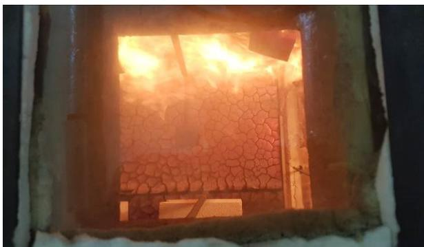
**Abbildung A.4.7-9: Prüfminute 9, Risse in der MDF der Wandkonstruktion, kurz vorm Abfall der MDF**
