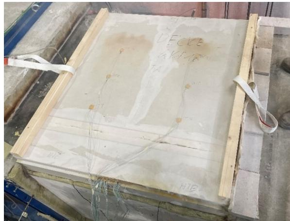
**Abbildung A.14.7-22: Prüfminute 88, GKF Decke feuerabgewandt verfärbt sich außen (rechts hinten)**
