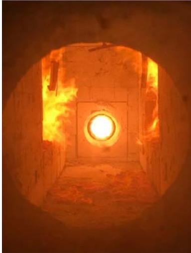
Abbildung A.18.7-11: Prüfminute 32, Teile PK 5 fallen ab
