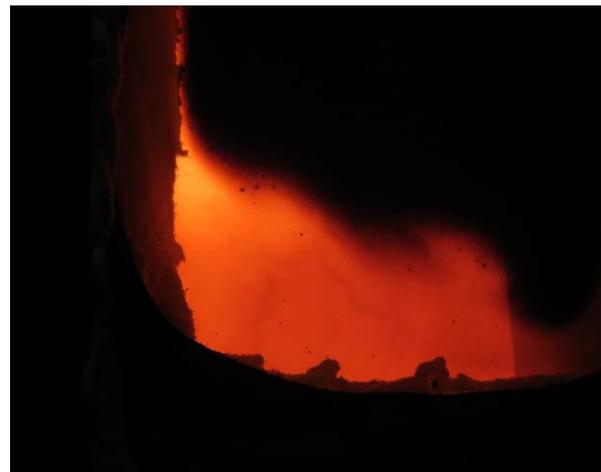
Abbildung A.5.7-10: Prüfminute 67, Risse GF-Platten
