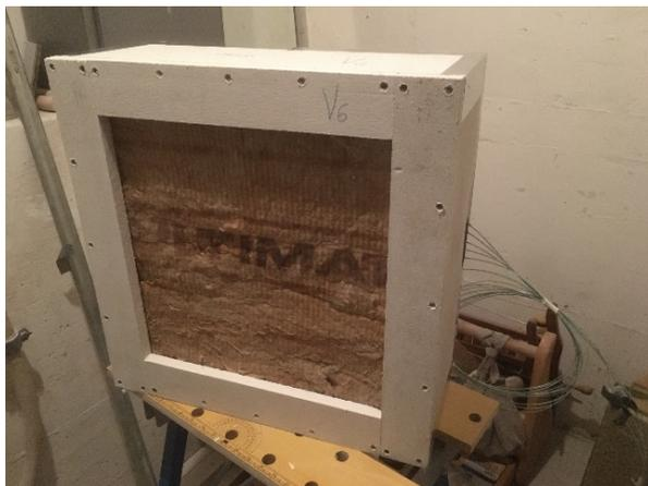
**Abbildung A.10.5-17: V6, Probekörper vor der Brandprüfung im Gipsrahmen**
