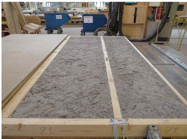
**Abbildung A.5.7-3: Prüfkörper beim Bau, Zellulose**
