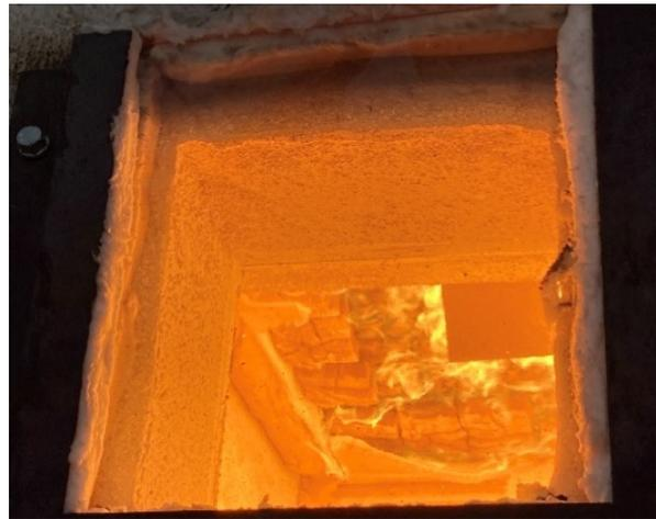
**Abbildung A.15.7-8: Prüfminute 84:00, Abfallen GKF rechts vorne an Decke**
