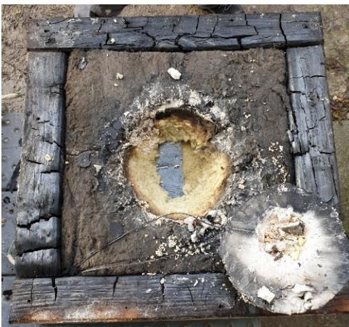
Abbildung A.21.8-5: V4a nach dem Brandversuch (Gipsbett noch intakt)
