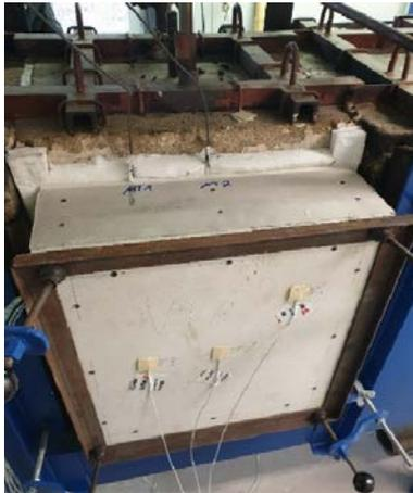
Abbildung A.21.8-1: Einbau des Probekörpers V4a
