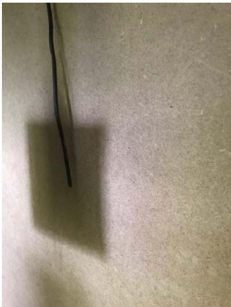
**Abbildung A.16.7-9: Zusätzliches Mantelthermoelement zur Messung der Ofentemperatur direkt am PK**
