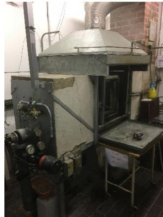
**Abbildung A.10.5-22: Feuerabgewandte Seite von V7 (Prüfminute 102)**
