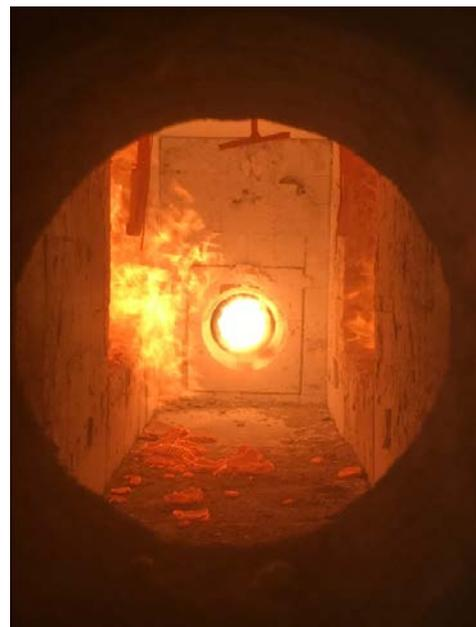
**Abbildung A.16.7-14: Prüfminute 45, Teile der 2. Platte PK 1 fallen; kein Abfallen von Teilen PK 1 bisher**
