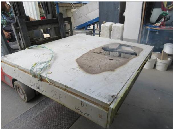
**Abbildung A.3.7-21:** Decke nach Versuchsende, feuerabgewandte Seite
