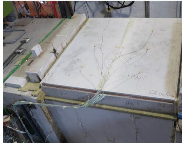
**Abbildung A.4.7-8: Prüfkörper Decke eingebaut in Prüfofen**
