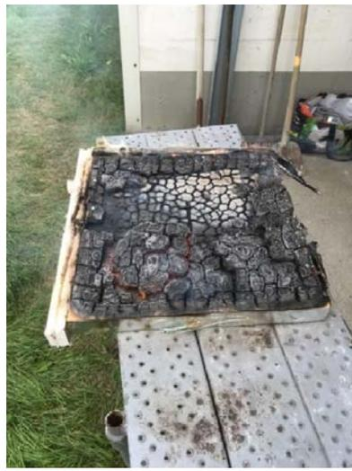
Abbildung A.19.7-16: PK 7 direkt nach Ausbau aus dem Brandofen
