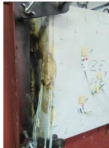
Abbildung A.1.7-10: Prüfminute 109, PK 2 ZF, Rauchaustritt und Schwarzfärbung an den Rändern
