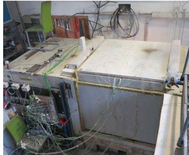
**Abbildung A.3.7-18:** Prüfminute 79, Schwarzfärbung der äußeren GF im Deckengefach Zellulose
