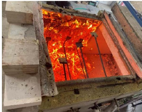
Abbildung A.13.8-16: Wand nach dem Ausbau der Decke im Prüfofen
