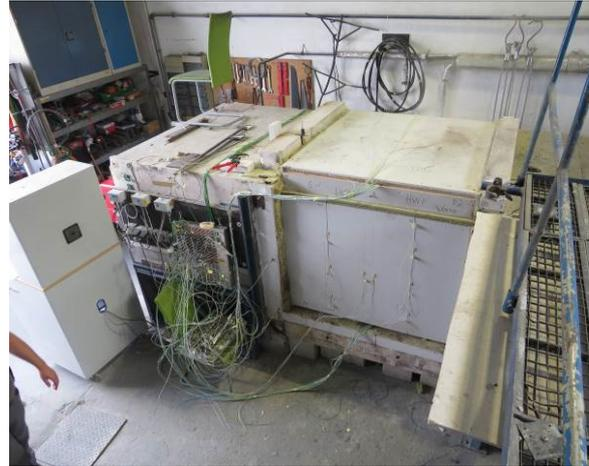
**Abbildung A.4.7-14: Prüfminute 50, Schwarzfärbung der Gipsfaser im Deckengefach HWF**
