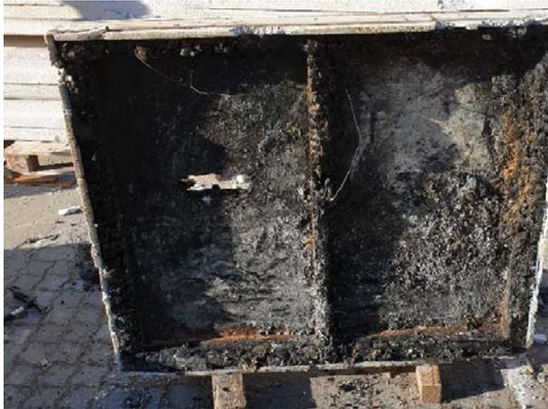
Abbildung A.8.7-7: Probekörper nach dem Brandversuch mit ausgebauter Dämmung
