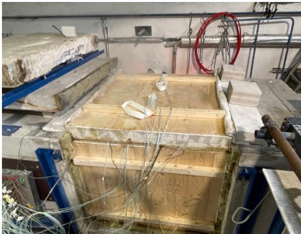
Abbildung A.13.8-15: Prüfminute 99, Oberfläche feuerabgewandt bei Beenden der Prüfung
