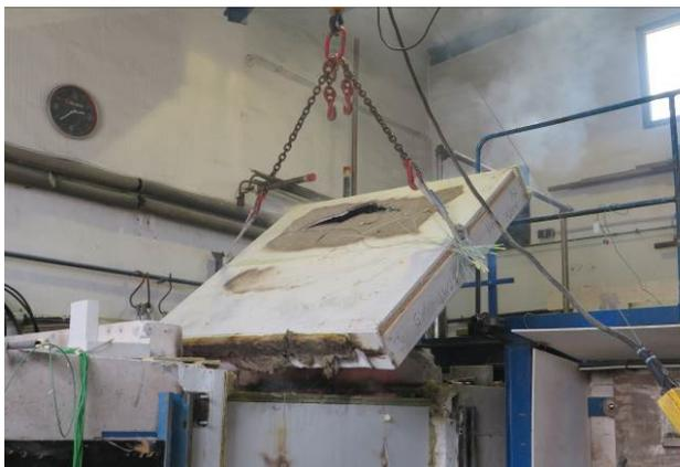
**Abbildung A.4.7-17: Beendigung der Prüfung, Entnahme Prüfkörper Decke**
