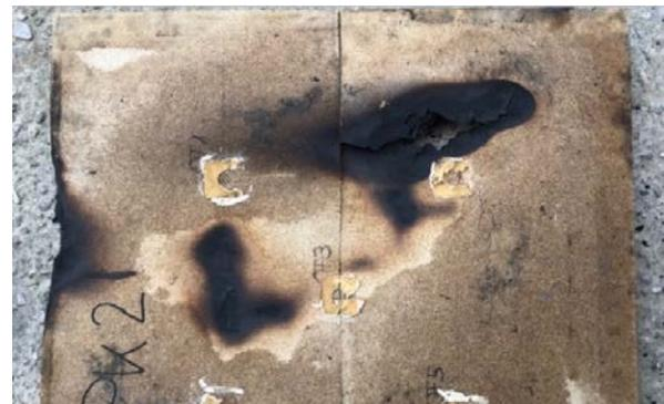
Abbildung 24: PK 2 Stelle des Durchbrands nach Versuchsende und Ablöschen PK
