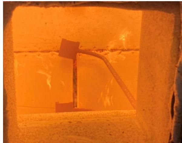
Abbildung A.13.8-4: Prüfminute 21:00, Fugen GKF öffnen sich
