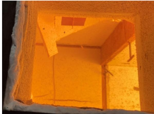
Abbildung A.14.7-14: Prüfminute 46, ca. 30 % der GKF Decke (klein links) löst und senkt sich (hängt aber noch an Konstruktion)
