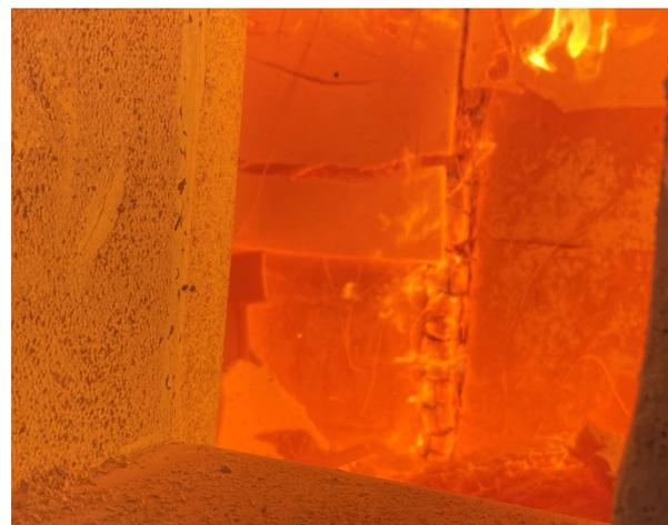
**Abbildung A.12.7-18: Prüfminute 62, GKF (Wand rechts klein unten) fällt zu ca. 40 % ab**
