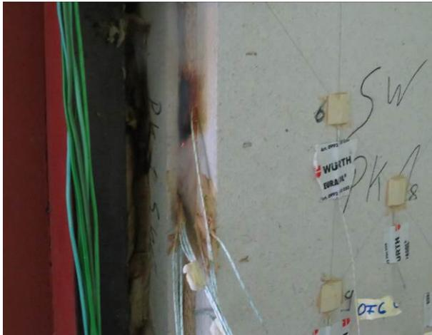
Abbildung A.1.7-13: Prüfminute 115, Schwarzfärbung an den Rändern des PK1 SW
