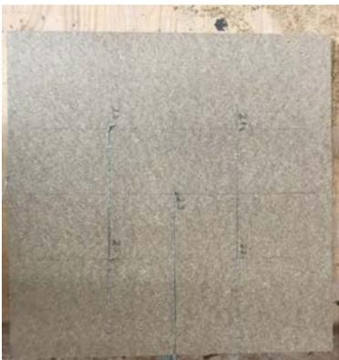
**Abbildung A.19.7-5: PK 8 Einbau TE in Messebene 2**
