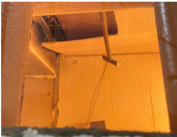
**Abbildung A.12.7-9: Prüfminute 16, GFK abgefallen (Decke hinten rechts); GFK von Konstruktion gelöst (Decke vorne rechts)**
