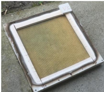
**Abbildung A.10.5-9: V3 nach dem Brandversuch, Mineralwolle feuerzugewandt**
