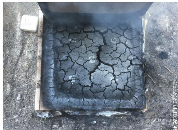
**Abbildung A.10.5-14: V4 nach dem Brandversuch, Ebene zwischen Dämmung und Spanplatte**
