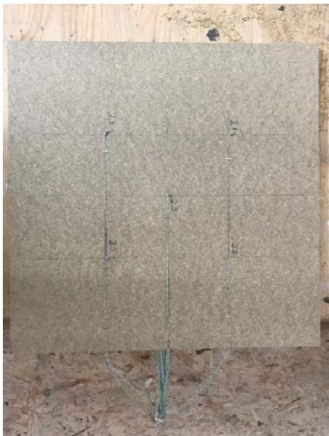
**Abbildung A.16.7-5: PK 2 Einbau TE in Mess-ebene 2**
