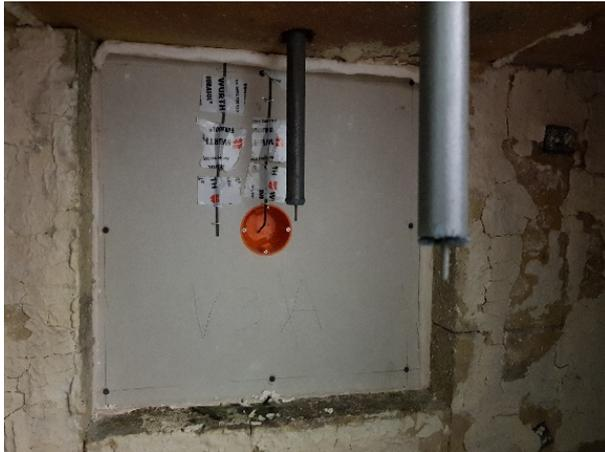
**Abbildung A.20.9-1: Probekörper V3A, feuerzugewandt, eingebaut im Brandofen**
