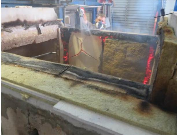
**Abbildung A.3.7-23: Löschen der Wandkonstruktion nach Versuchsende**
