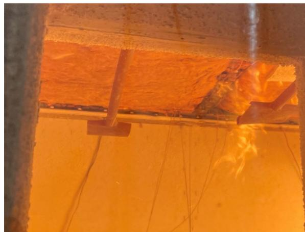
**Abbildung A.12.7-12: Prüfminute 19, Holzständer in der Decke (Mitte) brennt**
