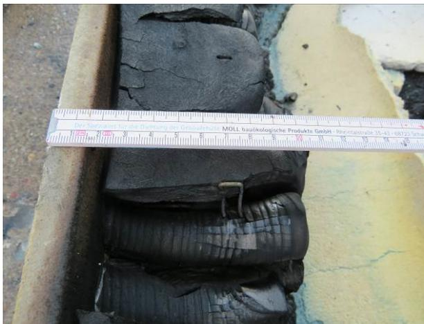
**Abbildung A.3.7-27: Decke: Restquerschnitt Ständer**
