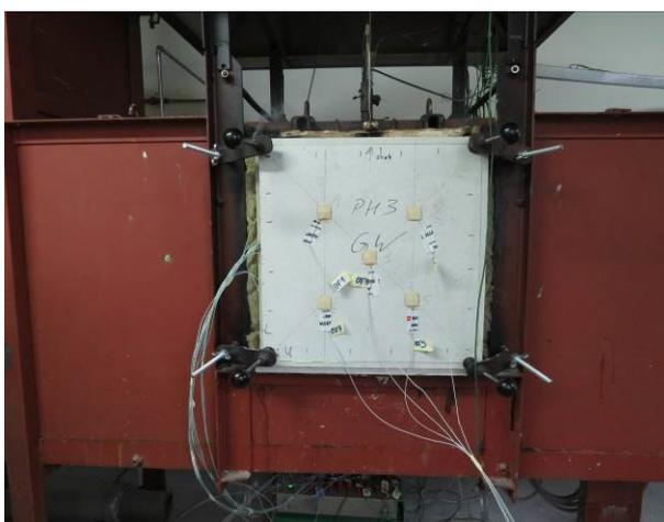
Abbildung A.2.7-11: Prüfminute 50, Rauchaustritt an den Rändern von PK 3
