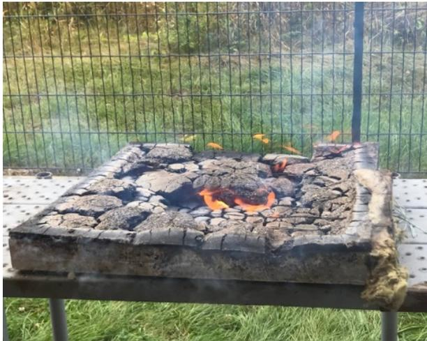
Abbildung A.17.7-19: PK 4 nach Ausbau aus dem Ofen
