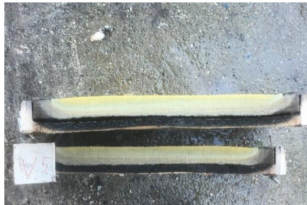
**Abbildung A.10.5-16: V5 nach dem Brandversuch, Querschnitt**
