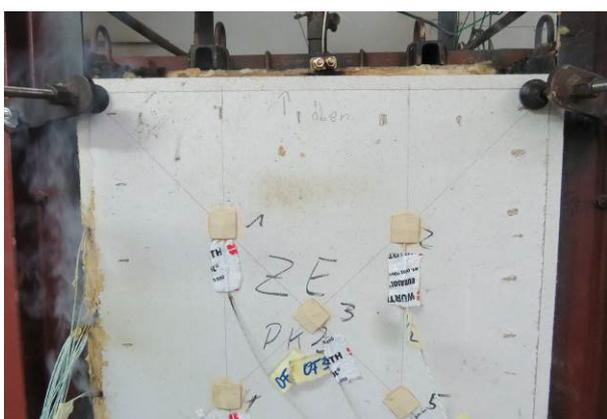
Abbildung A.1.7-11: Prüfminute 111, leichte Verfärbung der GF beim PK 2 ZF
