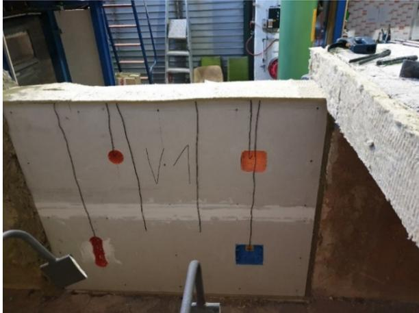
**Abbildung A.7.8-1: Einbau des Probekörpers V1**
