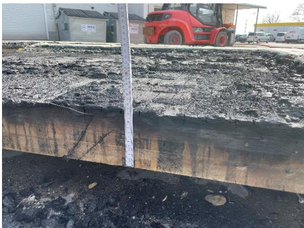
Abbildung A.11.7-17: Massivholzelement nach dem Brandversuch – Querschnitt in Probekörpermitte
