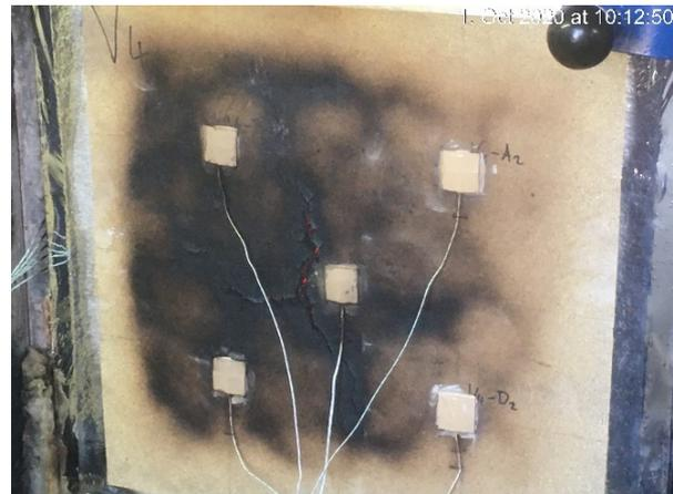
**Abbildung A.10.5-12: Feuerabgewandte Seite von V4 (Prüfminute 102)**
