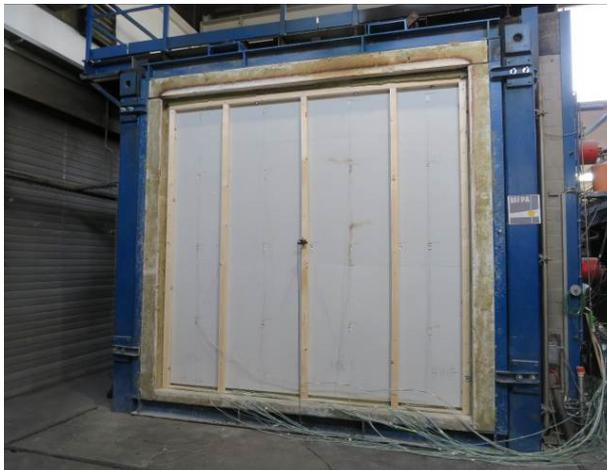
**Abbildung A.6.7-7: Prüfminute 68, Verfärbung der Fermacell in 77<sup>er</sup>-Gefach HWF bei OF 9+10, FA**
