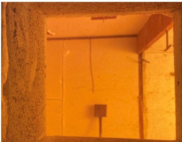
**Abbildung A.14.7-11: Prüfminute 36, Eigenbrand Holzständer hinter GKF-Fuge in Wand**
