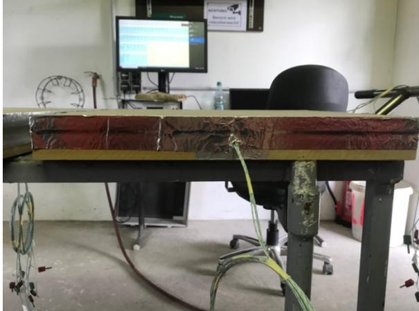
**Abbildung A.16.7-7: Aluklebeband um den Rand der PK**
