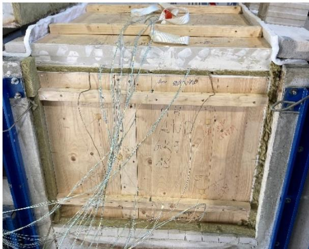
Abbildung A.15.7-3: Wand und Decke im Prüfofen
