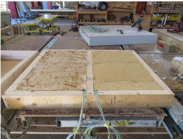
**Abbildung A.4.7-5: Dämmung Prüfkörper Decke beim Bau**
