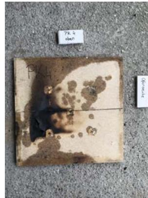
Abbildung A.17.7-26: PK 4 feuerabgewandte Oberfläche des PK nach Versuchsende und Ablöschen
