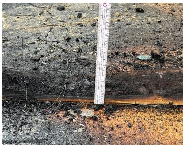
**Abbildung A.14.7-30: Wand nach Versuchs-ende; Detail Abbrand Ständer Mitte**
