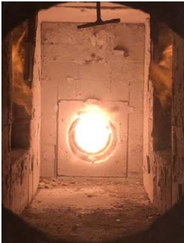
Abbildung A.19.7-9: Prüfminute 3, Oberflächen beide PK brennen mit
