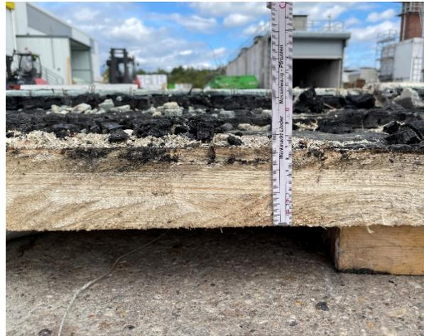
Abbildung A.15.7-20: Restquerschnitt der Decke nach der Brandprüfung
