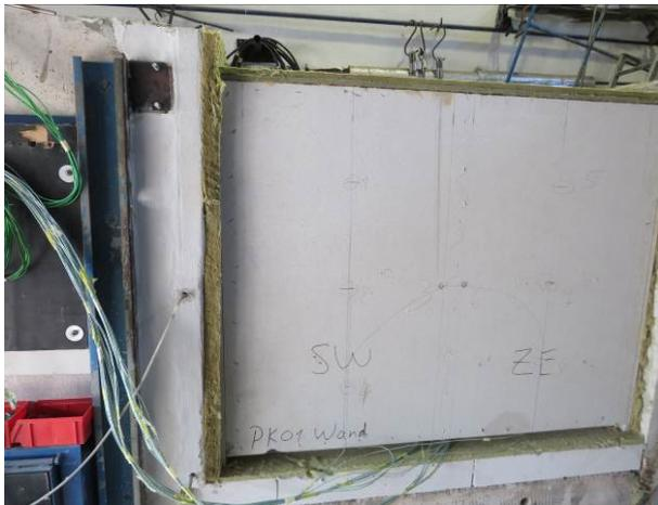
**Abbildung A.3.7-7: Eingebaute Wand in Prüfofen**
