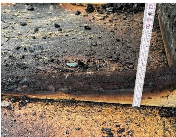
**Abbildung A.14.7-29: Wand nach Versuchs-ende; Detail Abbrand Ständer außen**
