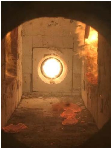
**Abbildung A.17.7-15: Prüfminute 32, 1. Platte PK 4 vollständig abgefallen**
