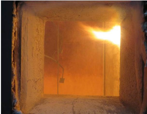
Abbildung A.5.7-7: Prüfminute 3, Verfärbung der MDF, FZ
