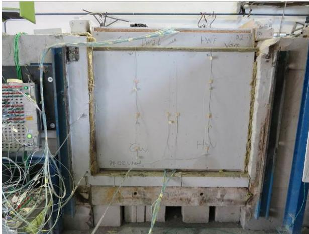
**Abbildung A.4.7-7: Prüfkörper Wand eingebaut in Prüfofen**
