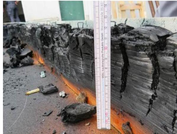
**Abbildung A.6.7-11: Glaswolle nach dem Brandversuch**
