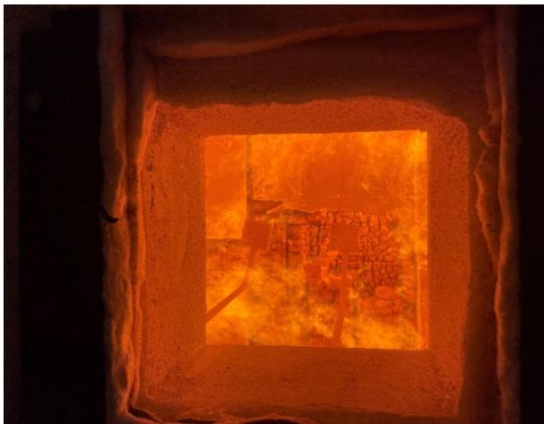
**Abbildung A.15.7-9: Prüfminute 85:05, Abfallen GKF an Wand links unten**
