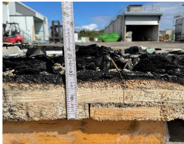
Abbildung A.15.7-18: Restquerschnitt der Wand nach der Brandprüfung
