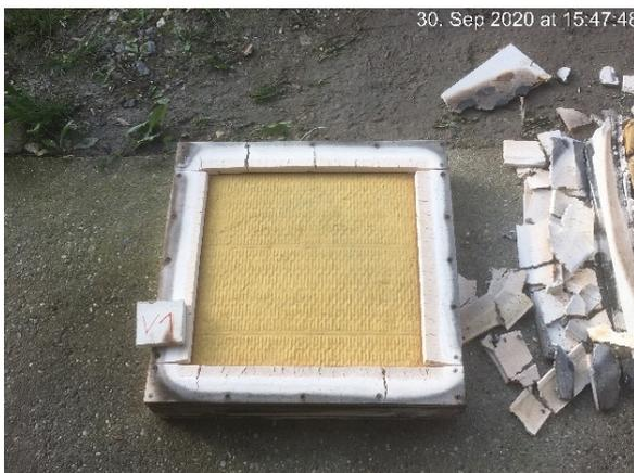
Abbildung A.10.5-5: V1 nach der Brandprüfung
