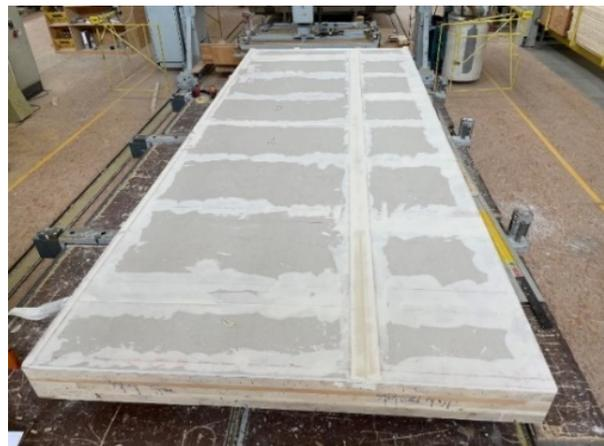
**Abbildung A.11.2-6: MH-Element mit verspachtelten Gipskartonplatten (feuerzugewandte Seite ist im Bild nach oben gerichtet)**
