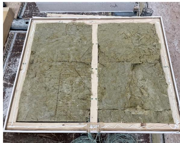
Abbildung A.14.7-6: Wandkonstruktion mit Steinwolle
