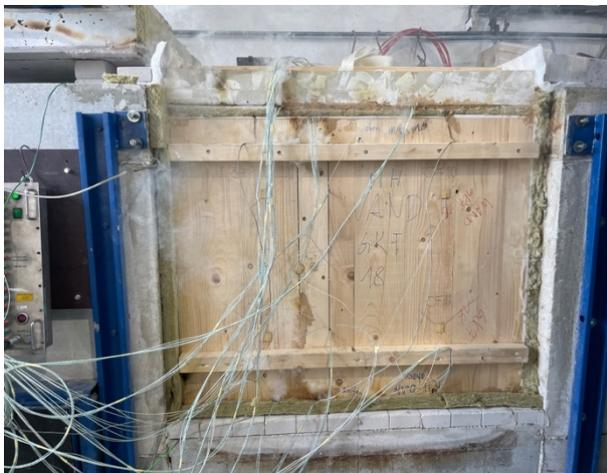
Abbildung A.15.7-15: Prüfminute 99:00, Oberfläche feuerabgewandt bei Beenden der Prüfung
