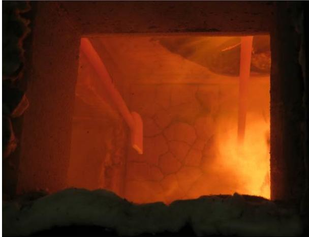
**Abbildung A.3.7-11: Prüfminute 12, Zellulose fällt teilweise aus dem Gefach in der Decke**
