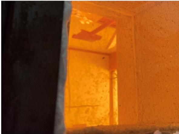
Abbildung A.14.7-13: Prüfminute 41, GKF Wand (groß) horizontale Risse
