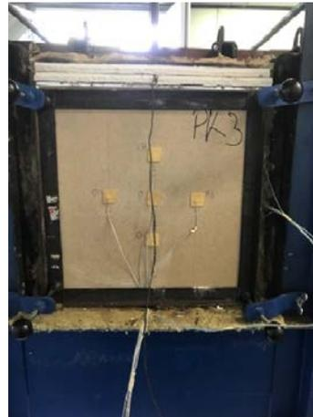
Abbildung A.17.7-8: PK 3 nach Einbau in den Ofen
