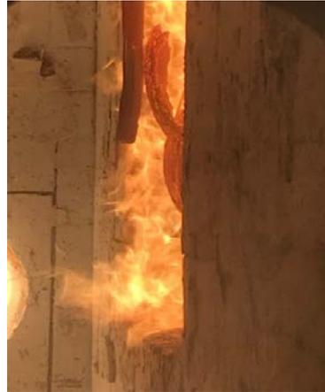
**Abbildung A.17.7-14: Prüfminute 31, weitere große Teile der 1. Platte lösen sich von PK 4**
