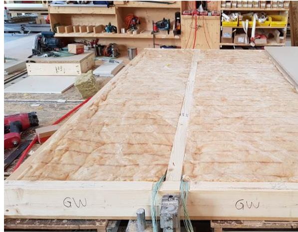
**Abbildung A.6.7-2: Prüfkörper beim Bau, GW-Dämmung**
