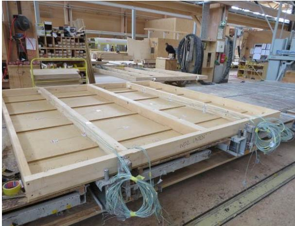
**Abbildung A.6.7-1: Prüfkörper beim Bau, Ständerwerk**
