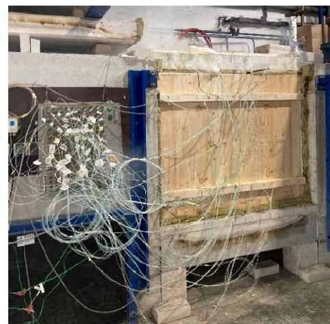
**Abbildung A.13.8-12: Prüfminute 76:40, starker Rauchaustritt Fuge oben zwischen Wand und Decke**
