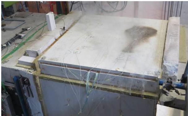
**Abbildung A.3.7-19:** Prüfminute 90, verstärkte Rissbildung der GF
