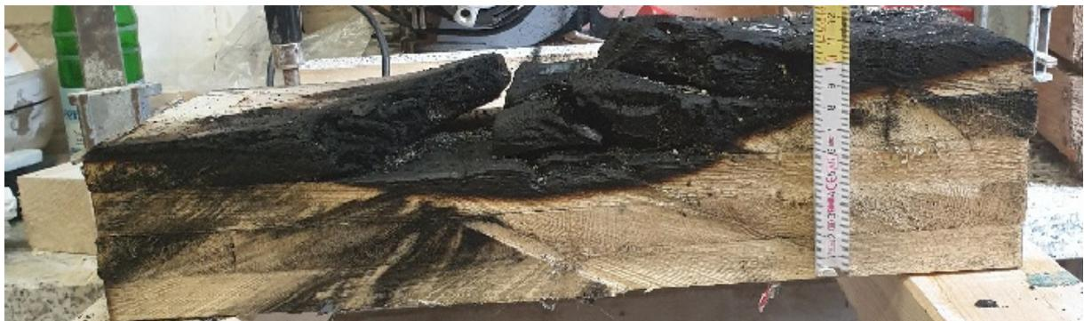
**Abbildung A.20.9-5: ungleichmäßiger Abbrand (Querschnitt)**
