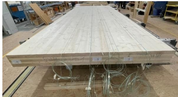
**Abbildung A.11.2-4: MH-Element mit Thermoelementen der ersten Lage (feuerzugewandte Seite ist im Bild nach oben gerichtet)**
