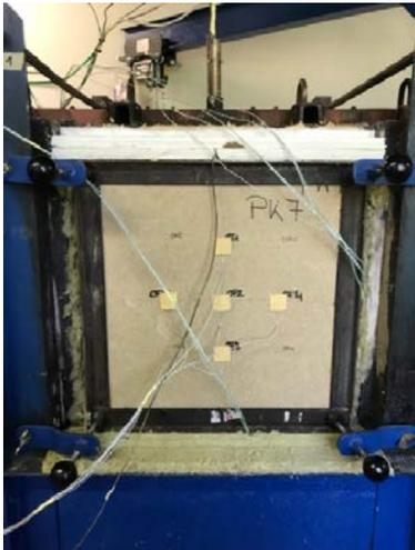
Abbildung A.19.7-7: PK 7 nach Einbau in den Ofen
