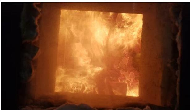
**Abbildung A.4.7-11: Prüfminute 15, Eigenbrand der Dämmungen**
