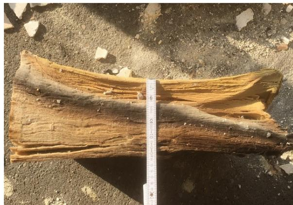
**Abbildung A.10.5-20: V6 nach dem Brandversuch, Querschnitt**
