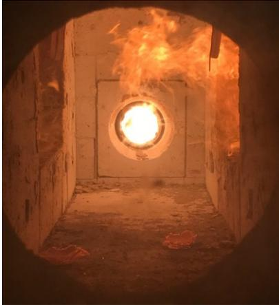
**Abbildung A.17.7-13: Prüfminute 29, PK 4 erste Teile der 1. Platte fallen ab**
