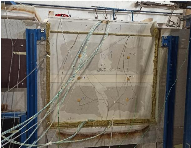
**Abbildung A.12.7-7: Wand in Prüfofen**
