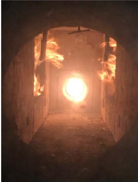
**Abbildung A.16.7-11: Prüfminute 2:30, Oberflächen beide PK brennen mit**
