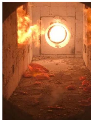
Abbildung A.19.7-12: Prüfminute 28, PK 8 erste Platte komplett abgefallen
