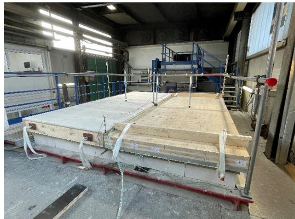
Abbildung A.11.7-4: Probekörper, eingebaut im Brandprüfstand feuerabgewandt
