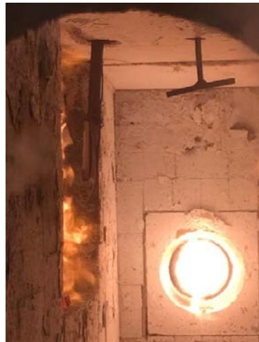
Abbildung A.19.7-10: Prüfminute 17, erste kleine Teile fallen ab PK 8
