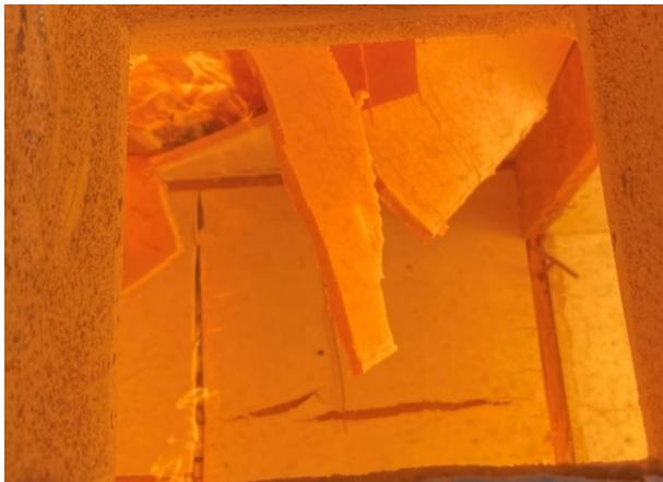
Abbildung A.14.7-15: Prüfminute 56, GKF Decke (klein rechts) fällt ab und zieht GKF Decke (groß) mit, welche zu ca. 50 % abfällt. Klammern lösen sich mit ab.
