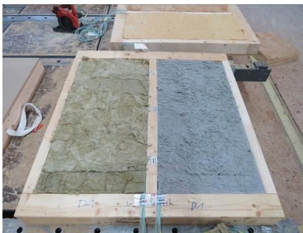
Abbildung A.3.7-3: Deckenkonstruktion beim Bau, Zellulose und Steinwolle
