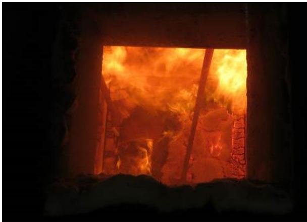
**Abbildung A.3.7-13: Prüfminute 25, Zellulose fällt in großen Teilen aus der Wand**
