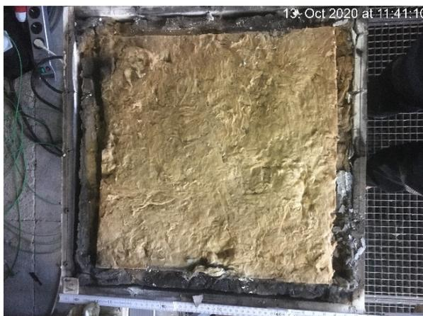
**Abbildung A.10.5-23: V7 nach dem Brandversuch, Mineralwolle feuerzugewandt**
