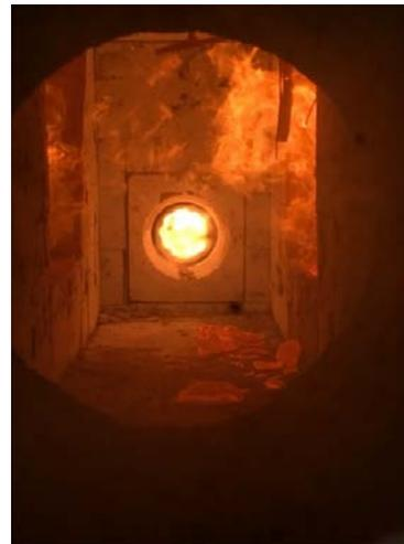
**Abbildung A.17.7-16: Prüfminute 50, große Teil der 2. Platte PK 4 fallen ab**
