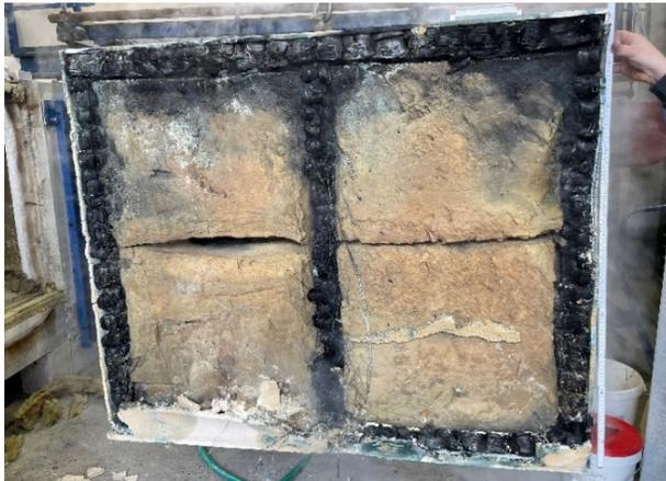
**Abbildung A.14.7-25: Wand nach Versuchs-ende feuerzugewandte Seite mit Dämmung**
