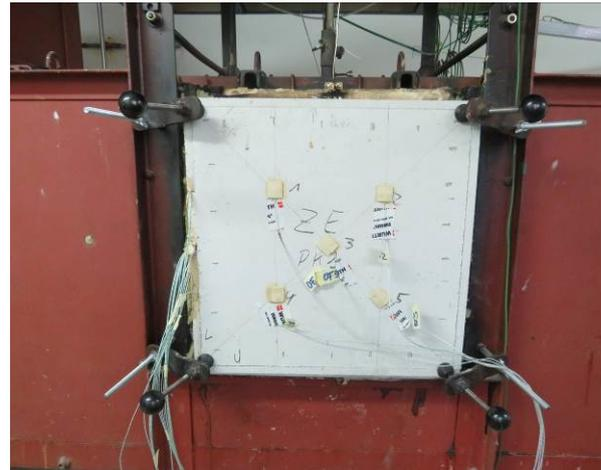
Abbildung A.1.7-8: PK2 eingebaut im Prüfofen
