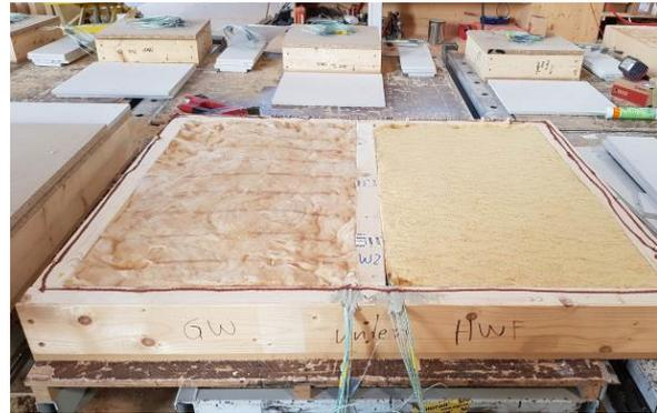
**Abbildung A.4.7-2: Prüfkörper mit Dämmung, Wand**
