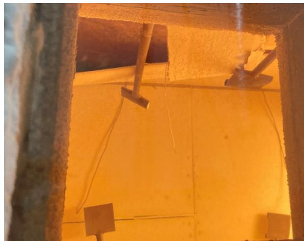
**Abbildung A.12.7-10: Prüfminute 18, GKF (Decke hinten) fällt weiter ab; GKF (Decke vorne) hängt stark durch**
