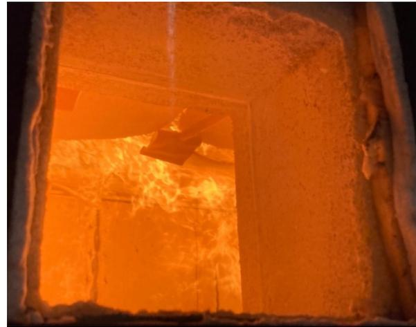
**Abbildung A.13.8-8: Prüfminute 60:29, GKF an Decke hinten fällt ab, hängt an Messtechnik im Ofen**
