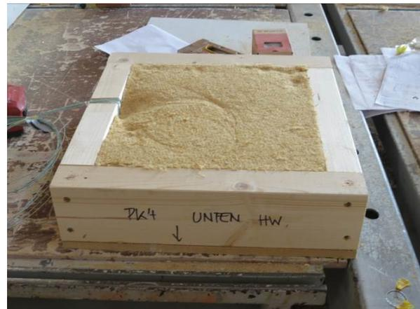
Abbildung A.2.7-4: PK 4 Füllung mit Holzweichfaserdämmung
