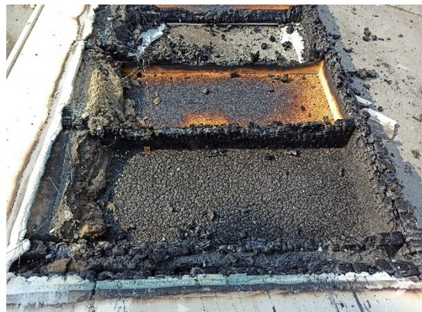
Abbildung A.11.7-18: Holztafelbauelement nach dem Brandversuch
