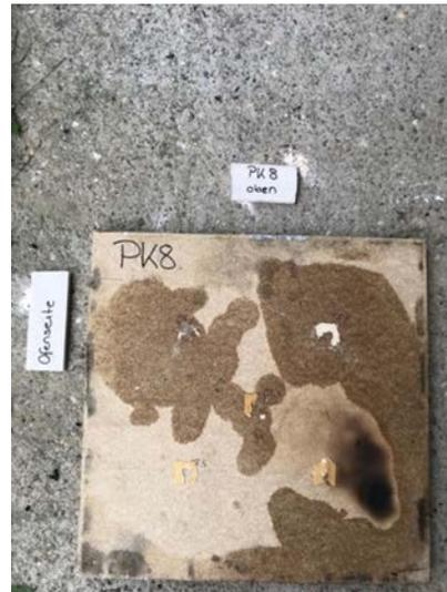
Abbildung A.19.7-20: PK 8 feuerabgewandte Seite nach dem Versuch
