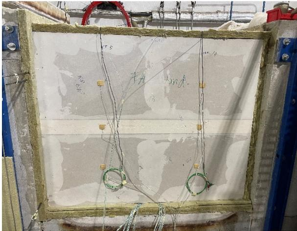
**Abbildung A.14.7-7: Wand in Prüfofen**
