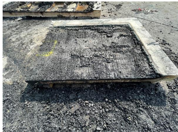
Abbildung A.11.7-16: Massivholzelement nach dem Brandversuch – Ansicht feuerzugewandt
