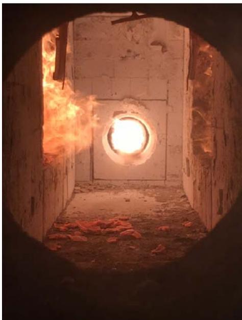
**Abbildung A.16.7-13: Prüfminute 27, Teile fallen ab bei der 1. Platte PK 2**
