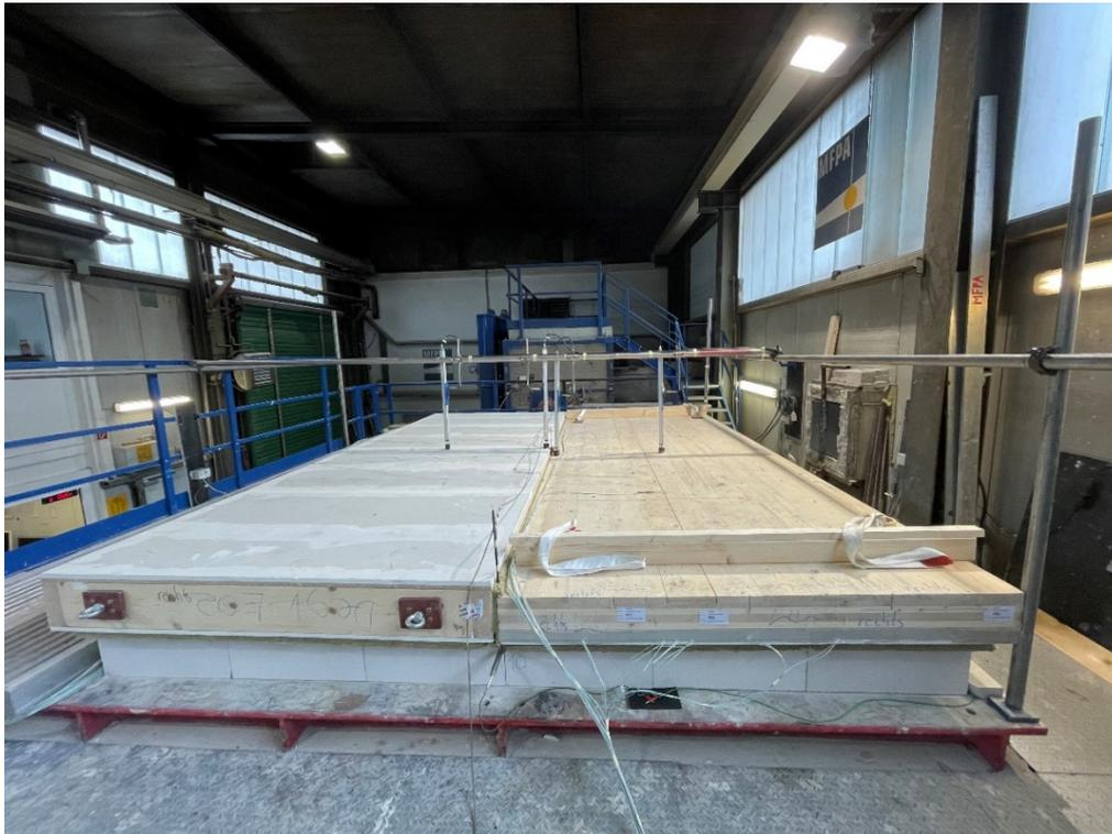
**Abbildung A.11.5-1: Eingebauter Prüfkörper im Deckenofen (inkl. Verformungsmesseinrichtung)**
