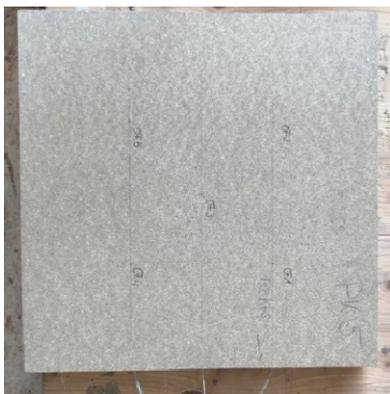
**Abbildung A.18.7-1: PK 5 Einbau TE in Messebene 1**
