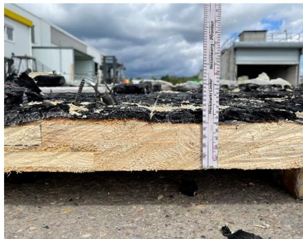
Abbildung A.13.8-18: Restquerschnitt der Wand nach der Brandprüfung
