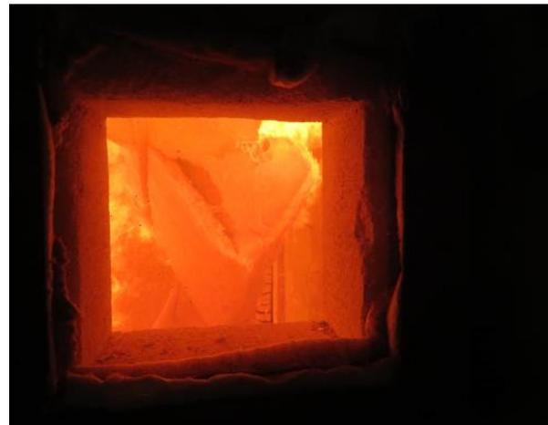
**Abbildung A.3.7-16: Prüfminute 63, Steinwolle fällt aus dem Deckengefach**
