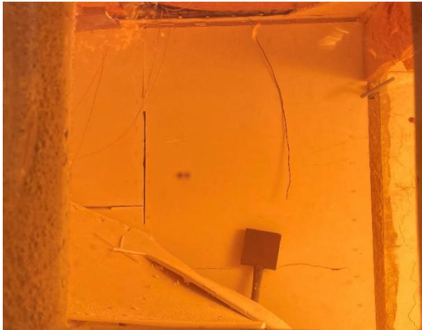
**Abbildung A.12.7-13: Prüfminute 21, Horizontaltalriss in GKF Wand (links groß) im unteren Drittel.**
