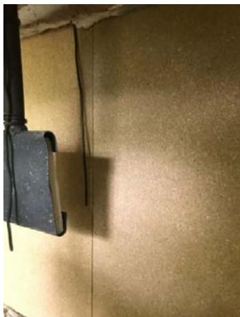
Abbildung A.17.7-9: Zusätzliches Mantelthermoelement zur Messung der Oberflächentemperatur direkt vor den PK
