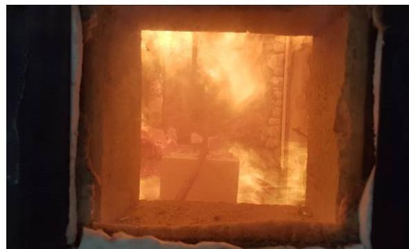
**Abbildung A.4.7-10: Prüfminute 12, MDF der Wandkonstruktion abgefallen**
