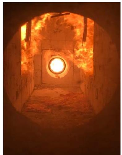
Abbildung A.18.7-10: Prüfminute 28, LVL PK 6 komplett abgefallen
