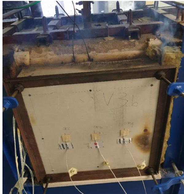
**Abbildung A.20.9-4: Deutliche Verfärbung auf der Rückseite von V3b**
