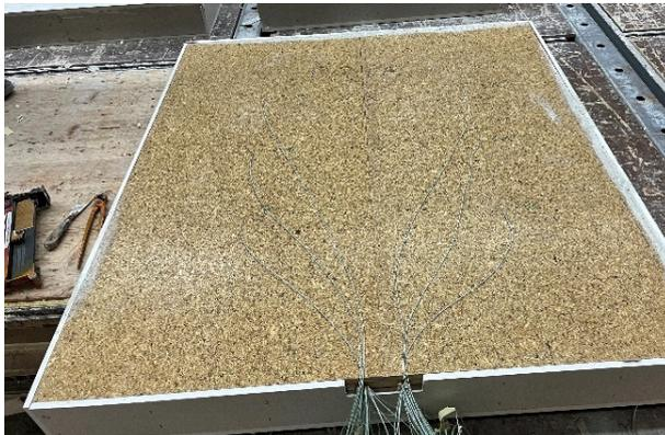
Abbildung A.14.7-3: Deckenkonstruktion im Bau mit Spanplatte
