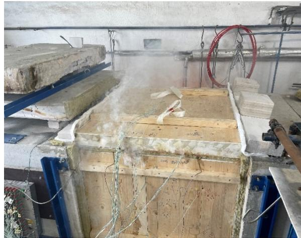
Abbildung A.15.7-14: Prüfminute 98:00, starker Rauchaustritt oben zwischen Wand und Decke
