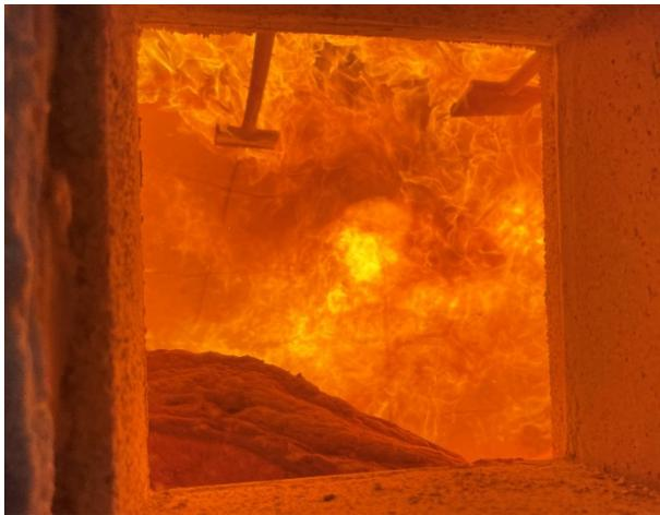
**Abbildung A.12.7-15: Prüfminute 39, Steinwolle der Decke (rechts) abgefallen**
