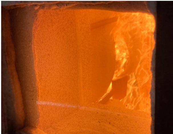
**Abbildung A.13.8-9: Prüfminute 61:00, GKF an Decke vorne links fällt ab**
