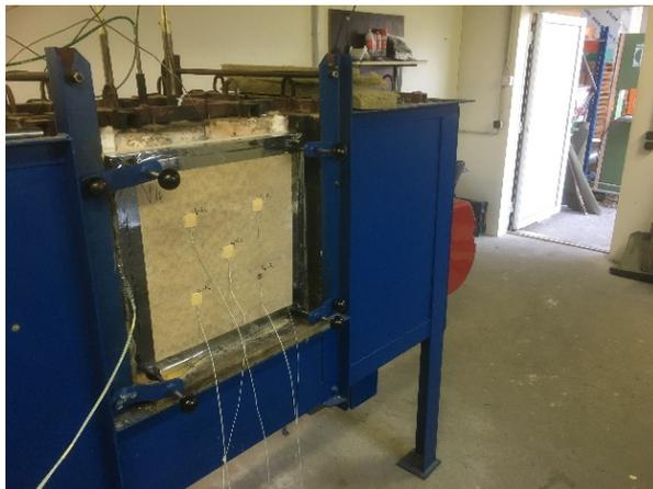
**Abbildung A.10.5-11: V4, Probekörper eingebaut in den Teil-8 Ofen**
