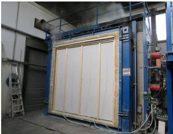
Abbildung A.5.7-9: Prüfminute 16, Rauchentwicklung
