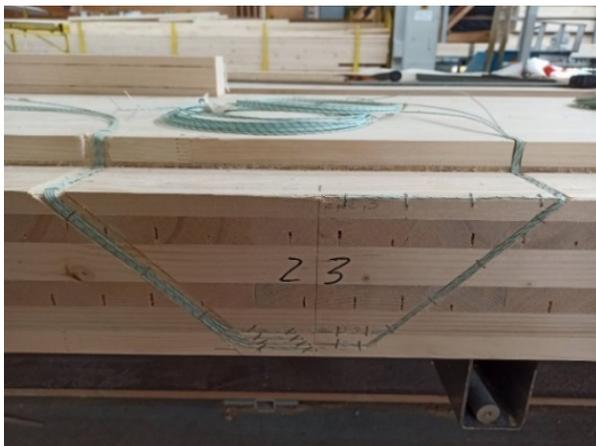
**Abbildung A.11.2-5: MH-Element mit Thermoelementen der zweiten Lage, beispielhafte Darstellung der Messstelle 22 (direkt in Fuge) und 23 (3 cm tief eingebohrt) (feuerzugewandte Seite ist im Bild nach unten gerichtet)**
