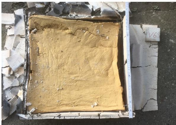
**Abbildung A.10.5-19: V6 nach dem Brandversuch, Mineralwolle feuerzugewandt**
