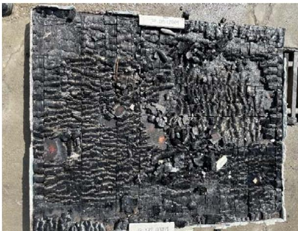
Abbildung A.13.8-17: Wand nach dem Ablösen
