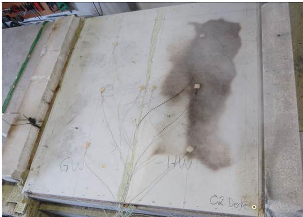
**Abbildung A.4.7-15: Prüfminute 54, Weitere Risse und Rauchaustritt aus der Gipsfaser im Deckengefach HWF**
