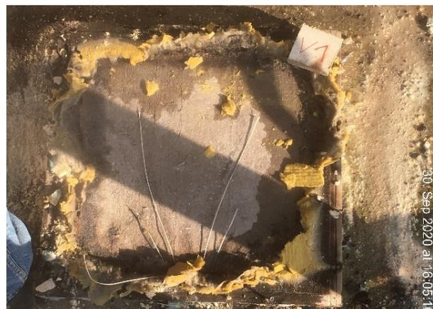
Abbildung A.10.5-6: V1 Betonplatte mit entfernter Dämmschicht nach dem Brandversuch
