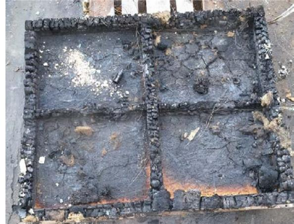
**Abbildung A.7.8-8: Probekörper nach dem Versuch ohne Dämmung**
