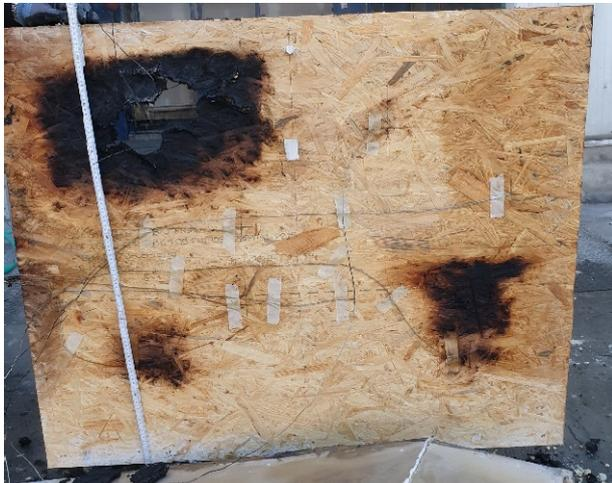
**Abbildung A.7.8-9: Feuerabgewandte Seite der OSB-Platte**
