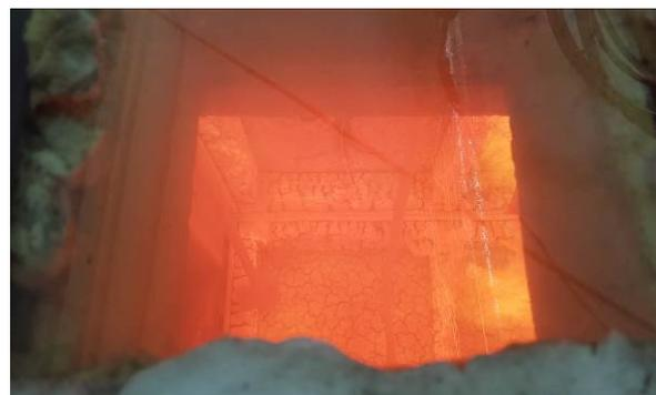
**Abbildung A.4.7-12: Prüfminute 25, Alle Dämmstoffe haben versagt**
