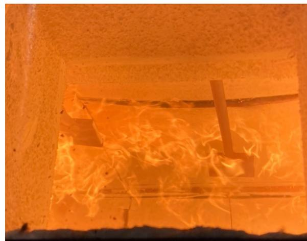
Abbildung A.13.8-6: Prüfminute 46:50, GKF an Decke vorne links beginnt sich zu lösen
