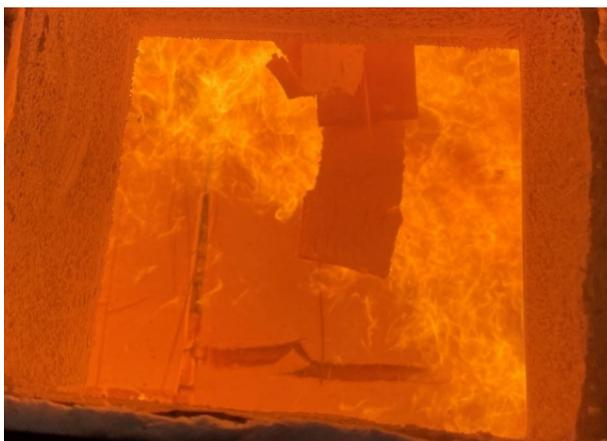
Abbildung A.14.7-17: Prüfminute 68, GKF Decke (groß) komplett abgefallen
