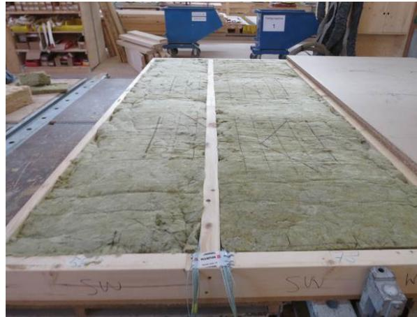
**Abbildung A.5.7-2: Prüfkörper beim Bau, Steinwolle**
