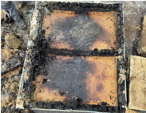
**Abbildung A.14.7-27: Wand nach Versuchs-ende feuerzugewandte Seite ohne Dämmung**
