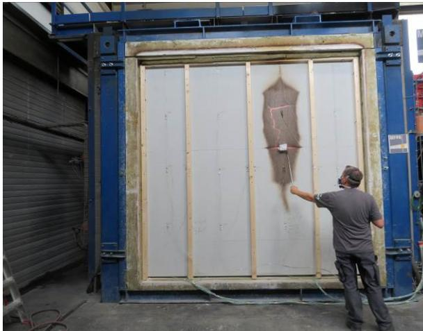
**Abbildung A.5.7-13: Prüfminute 108, Wattauschtest**
