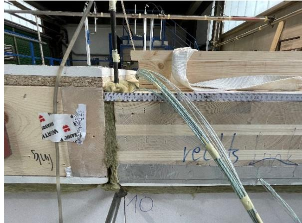
Abbildung A.11.7-2: Ausbildung der Stoßfuge zwischen den Elementen
