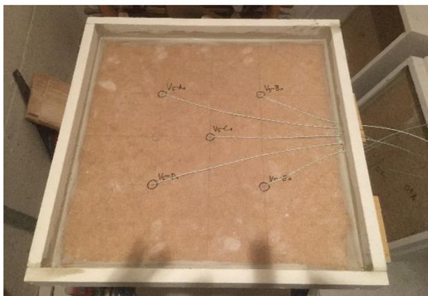
Abbildung A.10.5-1: Trägerkasten V5 mit abgedichteten Fugen
