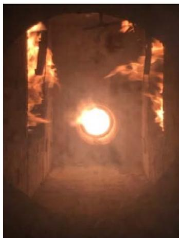
Abbildung A.17.7-11: Prüfminute 3, Oberflächen beide PK brennen mit
