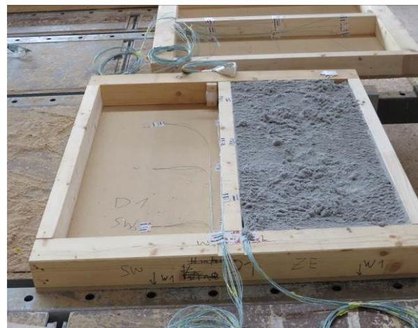
Abbildung A.3.7-2: Deckenkonstruktion im Bau, Zellulose
