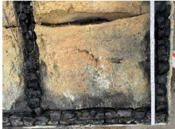
**Abbildung A.14.7-26: Wand nach Versuchs-ende feuerzugewandte Seite mit Dämmung; Detail Ecke**
