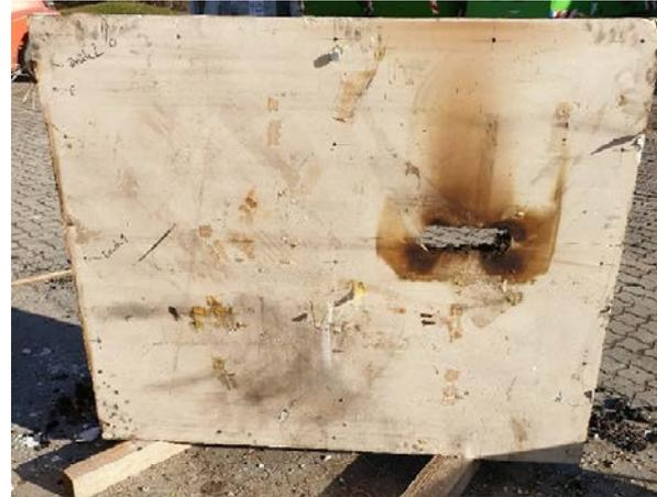
Abbildung A.8.7-8: Probekörper nach dem Brandversuch, feuerabgewandte Seite
