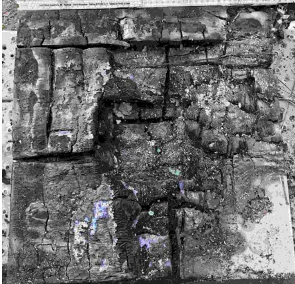
Abbildung A.20.9-6: Einbrand in den Probekörper
