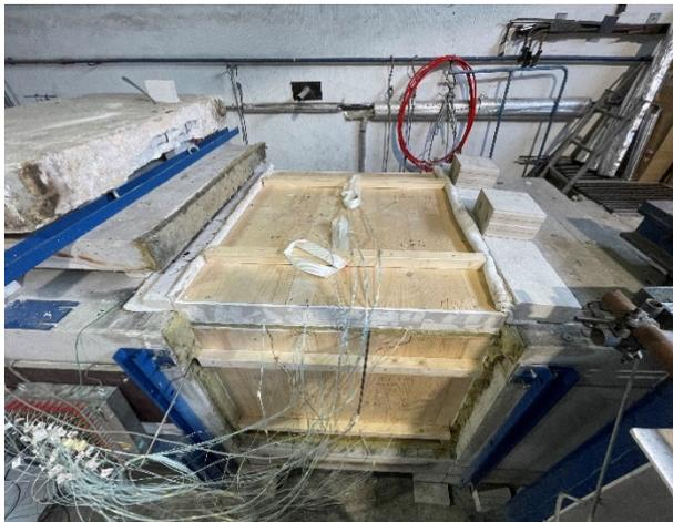
Abbildung A.13.8-3: Wand und Decke in Prüffofen
