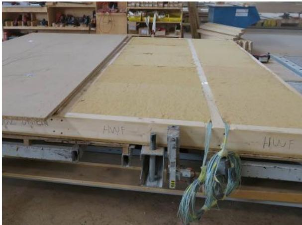
**Abbildung A.6.7-3: Prüfkörper beim Bau, HWF-Dämmung**
