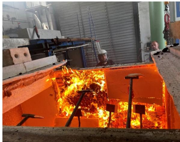
Abbildung A.15.7-16: Wandkonstruktion im Prüfofen nach Ausbau der Decke
