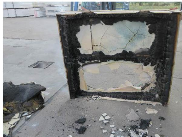
**Abbildung A.3.7-22:** Decke nach Versuchsende, feuerzugewandte Seite
