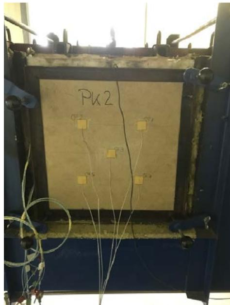
**Abbildung A.16.7-10: PK 2 nach Einbau in den Brandofen**
