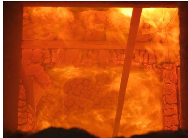
**Abbildung A.3.7-14: Prüfminute 33, Zellulose vollständig aus Wand gefallen**
