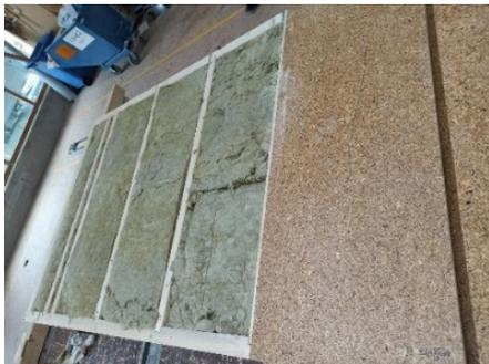
**Abbildung A.11.2-3: HTB mit Hohlraumdämmung und Spanplatten; Feld 4 bis 6 (feuerzugewandte Seite ist im Bild nach unten gerichtet)**
