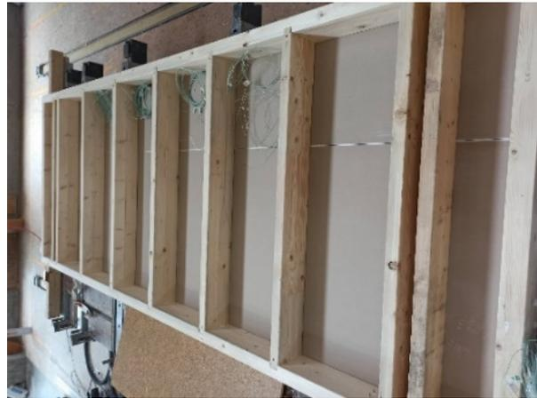
**Abbildung A.11.2-2: HTB-Element mit Thermoelementen der ersten und zweiten Lage (feuerzugewandte Seite ist im Bild nach unten gerichtet)**
