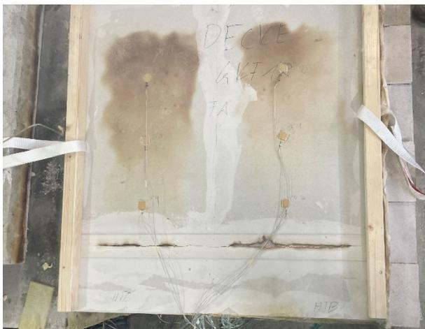
**Abbildung A.14.7-23: Prüfminute 89, GKF Decke feuerabgewandt Riss & Verfärbung am GKF-Stoß**
