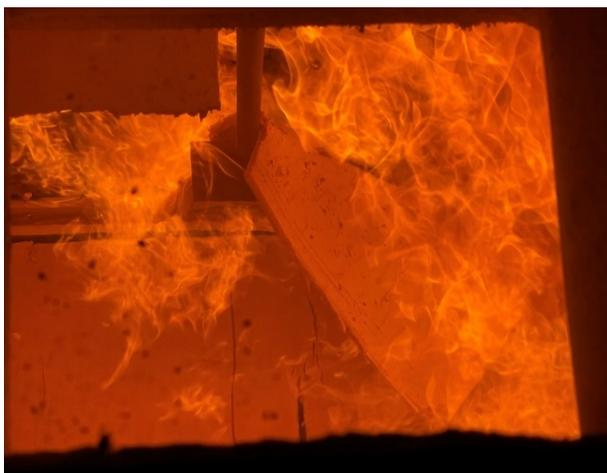
**Abbildung A.13.8-11: Prüfminute 72:05, GKF Decke komplett abgefallen, hängt teilweise noch an Messtechnik im Ofen**
