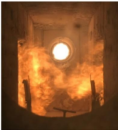
Abbildung A.18.7-7: Prüfminute 3, Oberflächen beide PK brennen mit
