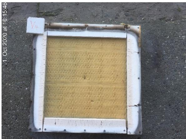
**Abbildung A.10.5-13: V4 nach dem Brandversuch, Mineralwolle feuerzugewandt**
