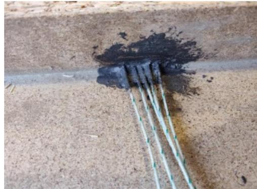
Abbildung A.9.4-2: Versiegelung der Thermoelementdurchführungen
