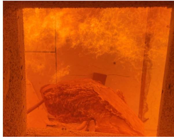
**Abbildung A.12.7-14: Prüfminute 36, Steinwolle der Decke (links) abgefallen; Mitbrand Spanplatte**
