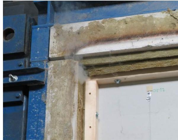
Abbildung A.5.7-8: Prüfminute 5, Rauchentwicklung oben links
