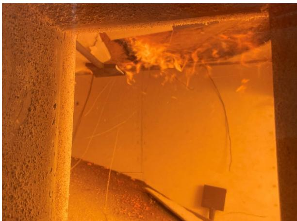
**Abbildung A.12.7-11: Prüfminute 19, Abfallen der gesamten GKF (Decke groß) nach Drehung der Ofenthermoelemente; Klammern stanzen durch die GKF und verbleiben im Holz**
