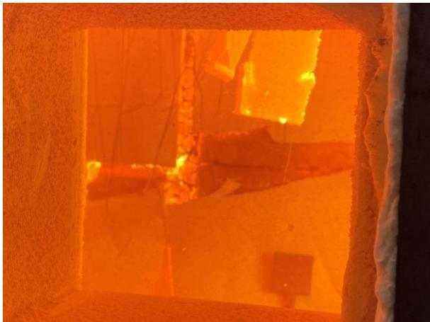
**Abbildung A.14.7-21: Prüfminute 85, GKF Wand (groß & klein unten) komplett durchgerissen & abgefallen**
