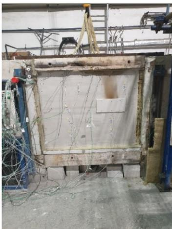
**Abbildung A.8.7-5: Nach Überschreiten des Temperaturkriteriums und starkem Rauaustritt, Verschließen von Öffnung 1**
