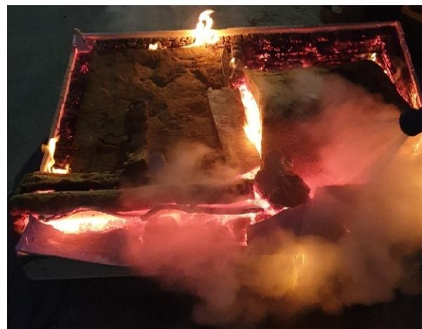
**Abbildung A.8.7-6: Probekörper nach dem Brandversuch beim Ablöschen**
