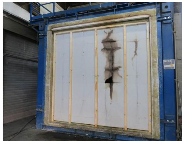
**Abbildung A.6.7-10: Wand nach Beendigung des Brandversuchs**
