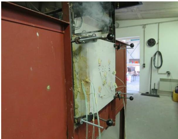
Abbildung A.1.7-9: Prüfminute 74, PK2 ZF, Rauchaustritt an den Seiten
