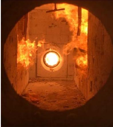
Abbildung A.19.7-13: Prüfminute 34, große Teile PK 7 fallen ab
