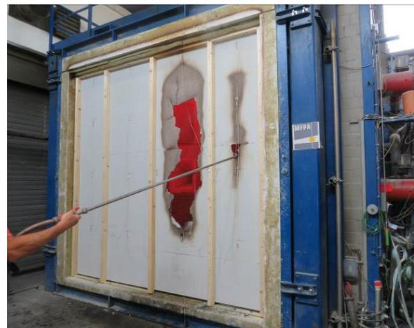
**Abbildung A.5.7-16: Nach Beendigung des Brandversuchs, Löschen der Konstruktion**
