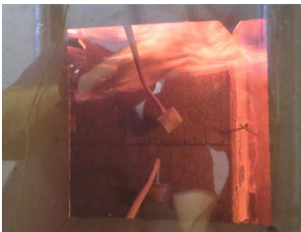
**Abbildung A.3.7-9: Prüfminute 4, starke Rissbildung der MDF in der Wand**
