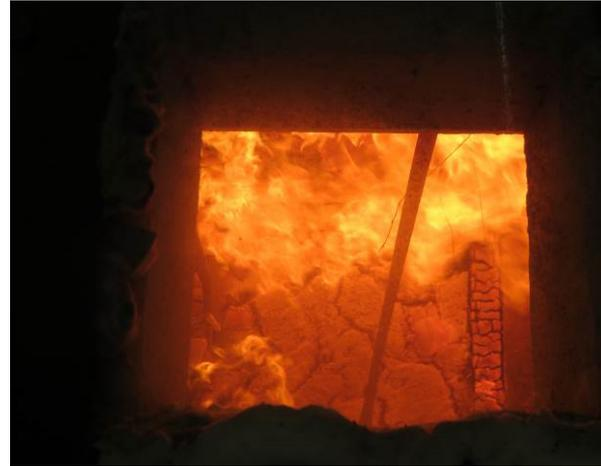
**Abbildung A.3.7-12: Prüfminute 22, Zellulose fällt aus dem Gefach in der Wand**
