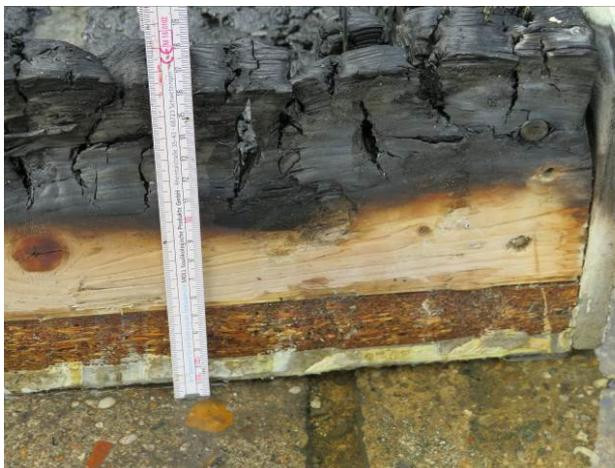
Abbildung A.4.7-21: Restquerschnitt Wand
