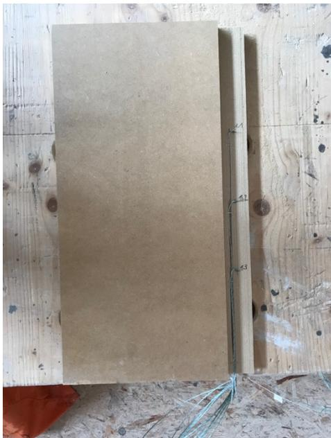
**Abbildung A.16.7-1: PK 1 Einbau TE in Mess-ebene 1**
