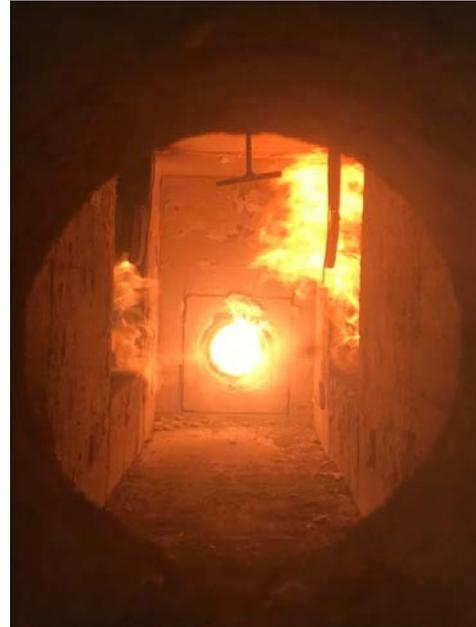
**Abbildung A.16.7-12: Prüfminute 5, stärkere Flammenbildung auf der Oberfläche PK 1 (bis Minute 12)**
