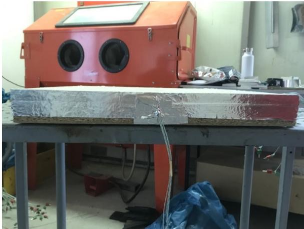
Abbildung A.17.7-7: Aluklebeband um den Rand der PK
