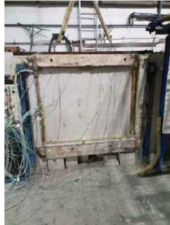
**Abbildung A.7.8-2 : Feuerabgewandte Seite des Probekörpers V1**
