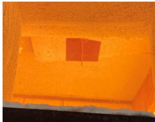
**Abbildung A.14.7-12: Prüfminute 40, Deckenplatten (klein) beginnen sich zu lösen**
