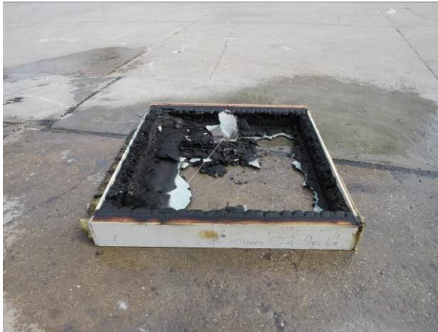
Abbildung A.4.7-19: Decke nach Prüfeinde
