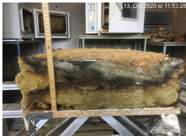
**Abbildung A.10.5-24: V7 nach dem Brandversuch, Querschnitt**
