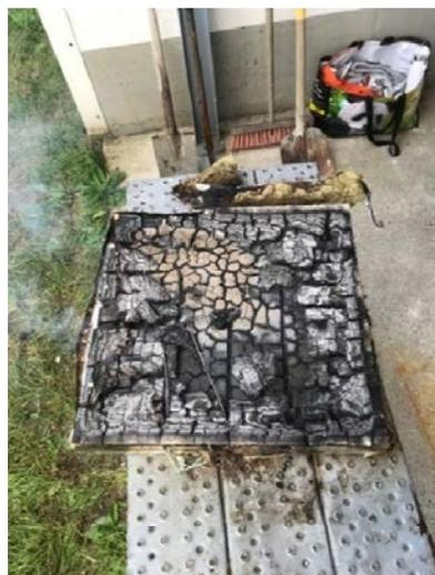
Abbildung A.19.7-18: PK 8 direkt nach Ausbau aus dem Brandofen
