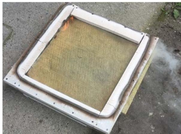
**Abbildung A.10.5-8: V2 Mineralwolle nach dem Brandversuch**
