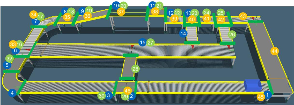
Abbildung 6-39: Umsetzungsbeispiel - Darstellung der Überlappungsprüfung der Überfahrten mit dem Ziel der Identifikation der Fördererlemente
