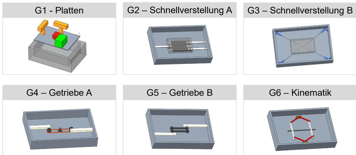
Abbildung 5-22: Grobkonzepte für die Grundgestelle der Erfassungseinheit nach den Vorgaben der Anpassbarkeit und Zentrierung
