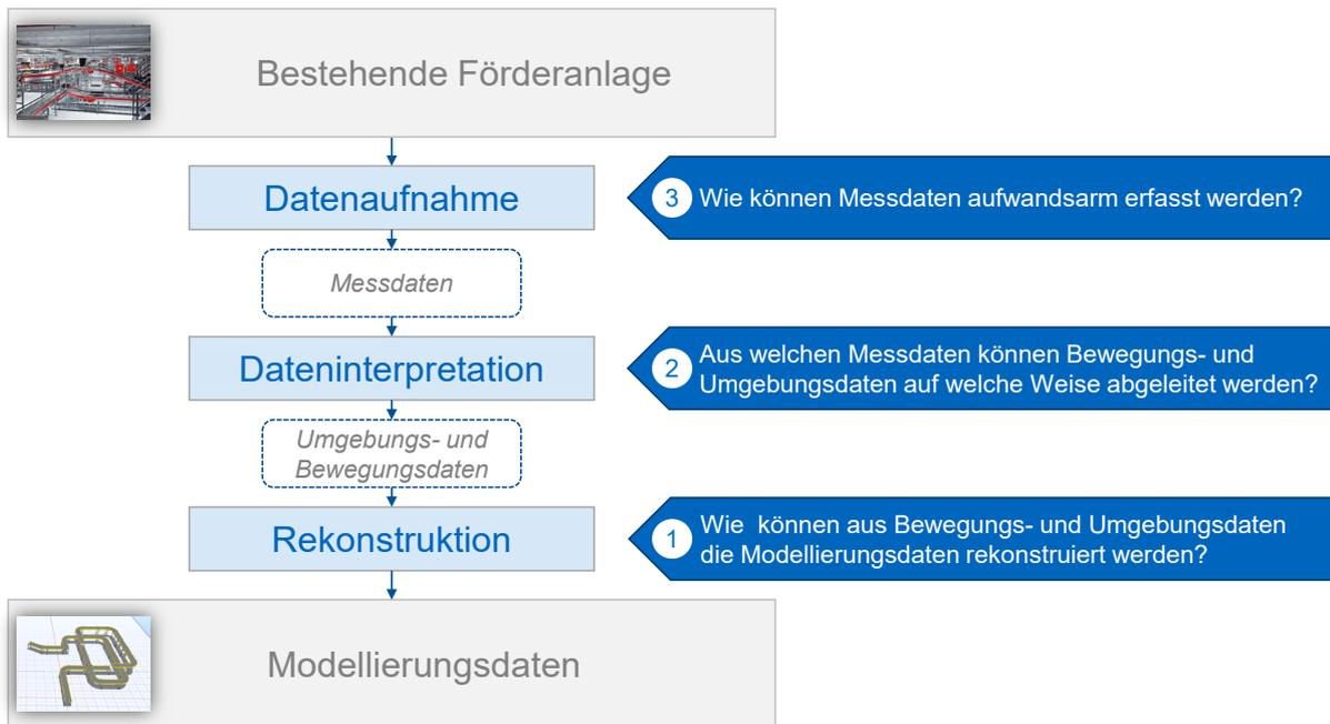
Abbildung 4-2: Dreistufiges Verfahren zur Rekonstruktion von Modellierungsdaten aus bestehenden Förderanlagen (Bildquelle „Bestehende Förderanlage“ GEBHARDT Fördertechnik GmbH)
