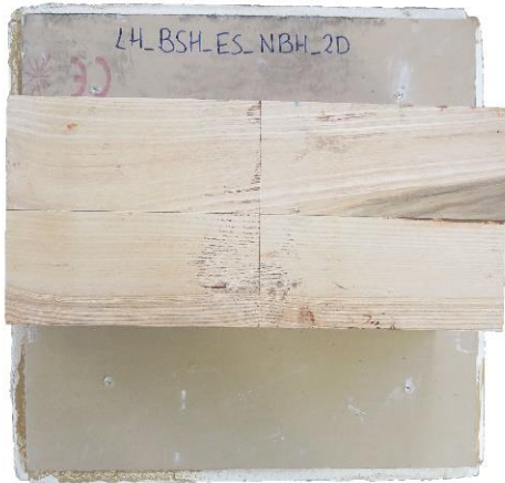
LH_BSH_Es_NBH_2D Versuchskörper, unbeanspruch
