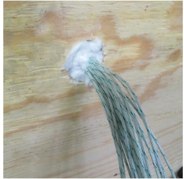
Abdichtung der Thermoelementnuten
