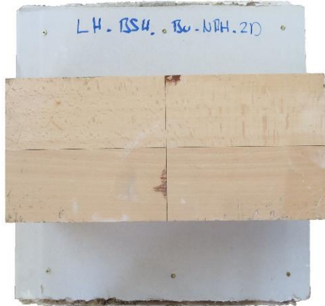
LH_BSH_Bu_NBH_2D Versuchskörper, unbeanspruch
