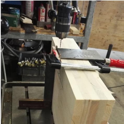
Bohren der Messstellen
