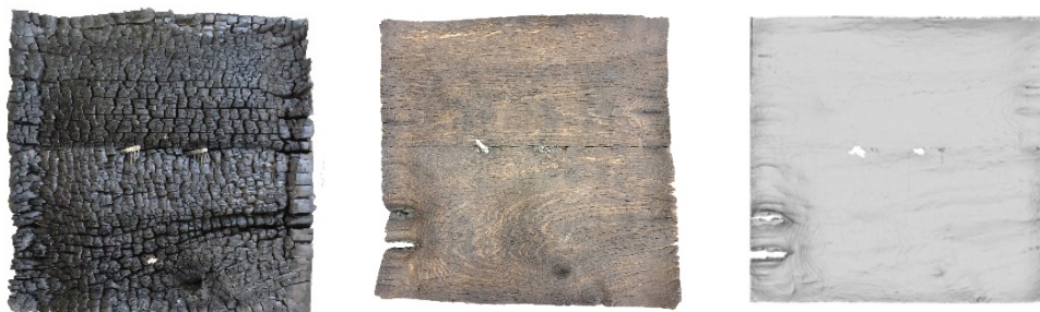
Abbildung 56 Prüfkörper Vollholz Eiche (v.l.n.r.) Holzkohleschicht, gebürstet, 3D-Scan
