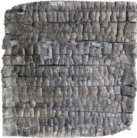
LH_BSH_Es_NBG_1D brandbeanspruchte Seite, Kohleschicht
