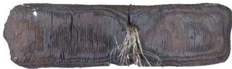
LH_FSH_Bu_ETK_2D brandbeanspruchte Seite, Kohleschicht entfernt
