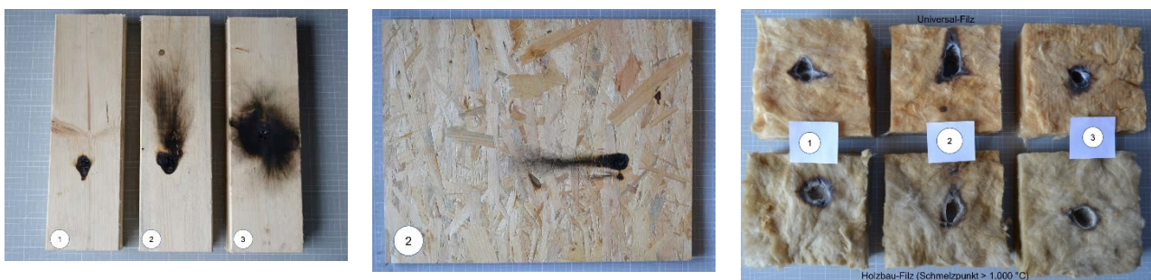
Abbildung 113: Prüfkörper nach Versuch: (v.l.n.r.): KVH, OSB bei Anordnung senkrecht und Dämmung 1 und 2 [95]
