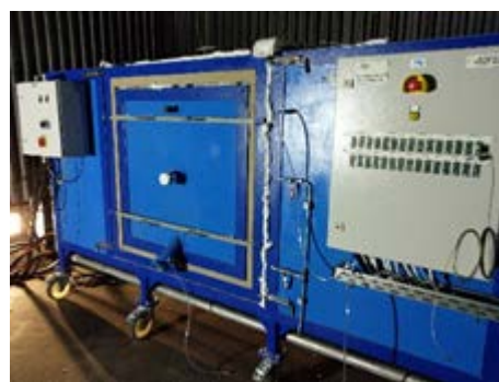
Abbildung 320: Brandofen zur Feuerwiderstandsprüfung in Anlehnung an DIN EN 1363-1 (Bauteilofen) als Visualisierung (links), Versuchsstand (Mitte), und HBV-Probekörper horizontal (rechts)
