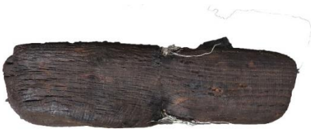
LH_VH_Ei_ETK_2D brandbeanspruchte Seite, Kohleschicht entfernt
