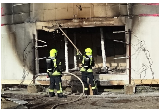
Abbildung 223: 154. Minute V3: Öffnen des Sturzes mit Einreißhaken
