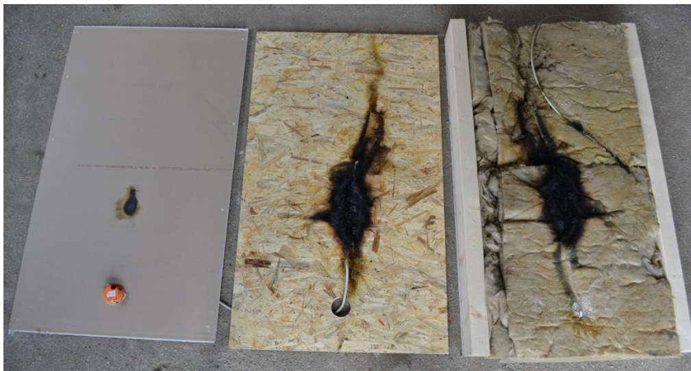
Abbildung 118: Prüfkörper mit mittig verlegtem PVC-Kabel nach Öffnung und Lichtbogeneinwirkung [95]
