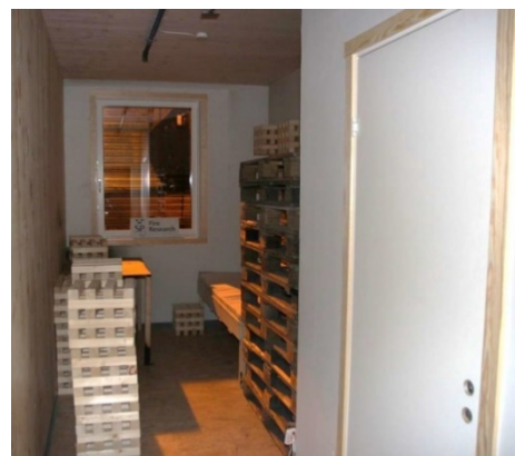
Abbildung 287: Grundriss des Brandraums und des angrenzenden Flurs (links), Brandraum mit Mischbrandlasten (rechts) [222]
