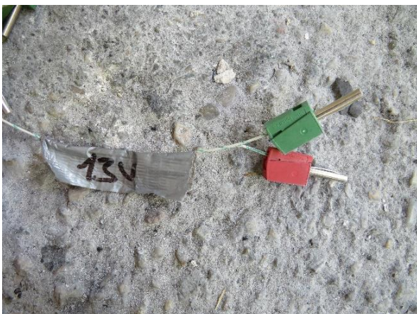
Anschlussklemmen der Thermoelemente
