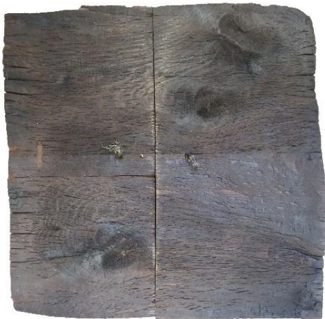
LH_VH_Ei_NBH_1D brandbeanspruchte Seite, Kohleschicht entfernt
