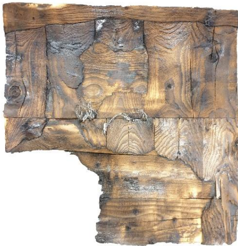
NH_BSP_Fi_NBH_1D_2 brandbeanspruchte Seite, Kohleschicht entfernt
