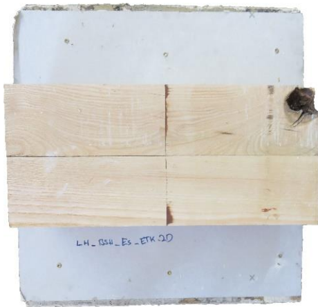
LH_BSH_Es_ETK_2D Versuchskörper, unbeanspruch
