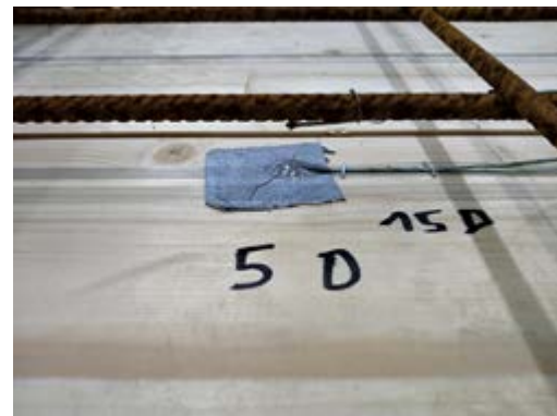
Abbildung 321: Holzschicht und Bewehrungslage der Holz-Beton-Verbunddecke in der Herstellung (links) und Ausführung von Temperaturmessstellen in der Grenzschicht zwischen Holz und Beton sowie an der Bewehrung (rechts)
