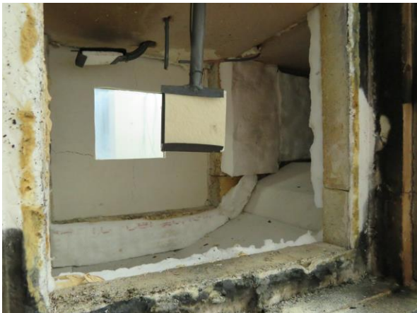
Anordnung der Ofenthermoelemente
