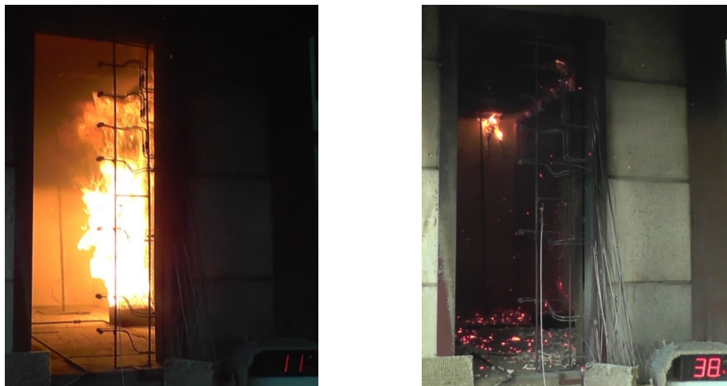
Abbildung 46: Brandraum mit nur einer brennbaren Wand im Vollbrand zu Minute 11 (links) und selbstverloschener Brand zu Minute 38 (rechts) im Room-Corner-Test
