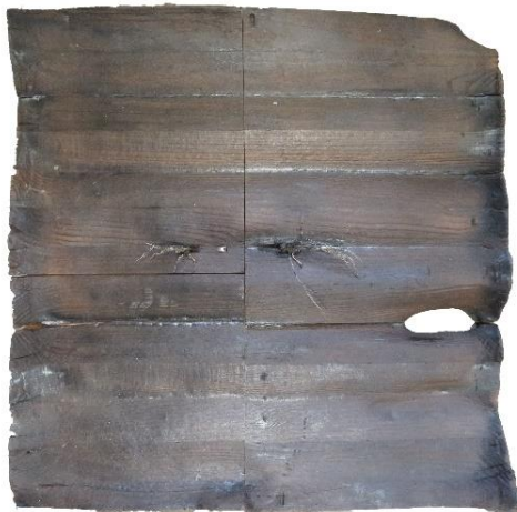
LH_BSH_Bu_ETK_1D brandbeanspruchte Seite, Kohleschicht entfernt
