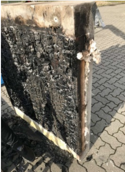
Abbildung 124: Decke V1 nach dem Brandversuch und schematische Darstellung der Messpunkte für die Restholzdicke/Holzabbrand
