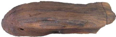
NH_VH_Fi_NBH_2D brandbeanspruchte Seite, Kohleschicht entfernt
