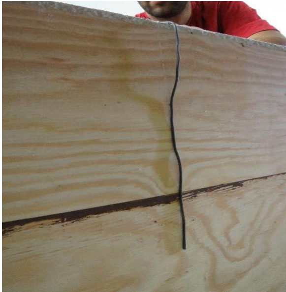
Mantelthermoelement auf Prüfkörperoberfläche
