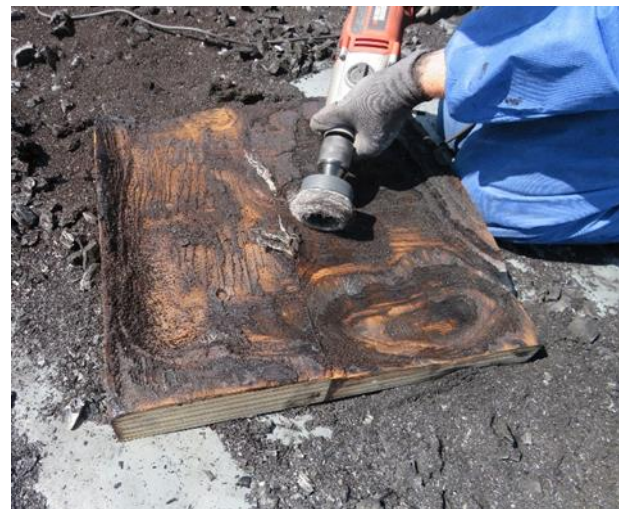
Entfernen der Kohleschicht
