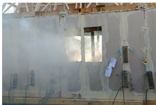
Abbildung 226: 180. Minute V3: Öffnungen zur Entrauchung in Wand 2
