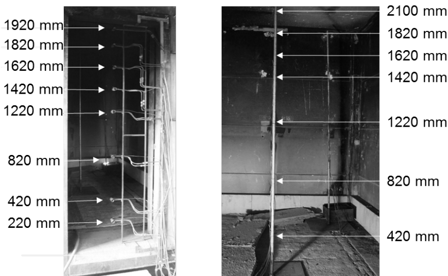
Abbildung 38: links: Bidirektionale Sonden und Temperaturmessstellen am Messbaum 3; rechts: Temperaturmessstellen am Messbaum 2
