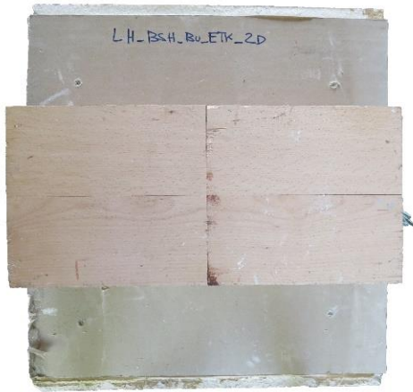
LH_BSH_Bu_ETK_2D Versuchskörper, unbeanspruch
