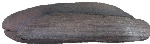
LH_BSH_Bu_NBH_2D brandbeanspruchte Seite, Kohleschicht entfernt
