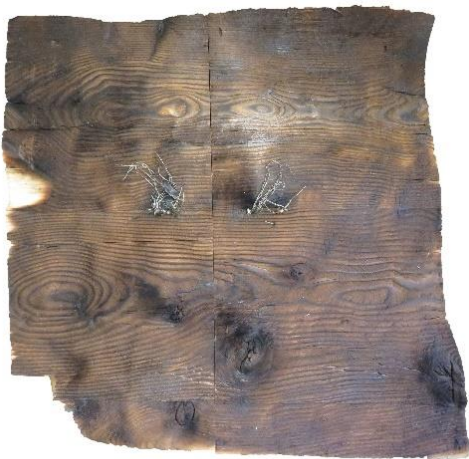
NH_VH_Fi_ETK_1D brandbeanspruchte Seite, Kohleschicht entfernt
