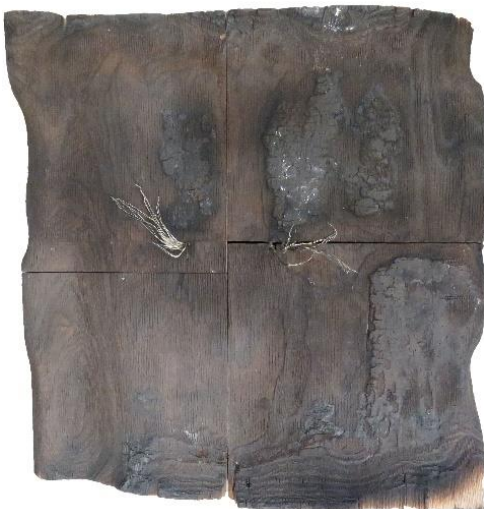
LH_FSH_Bu_ETK_1D brandbeanspruchte Seite, Kohleschicht entfernt
