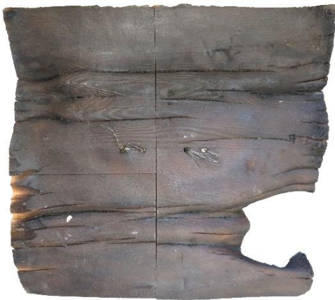
LH_VH_Bu_NBG_1D brandbeanspruchte Seite, Kohleschicht entfernt
