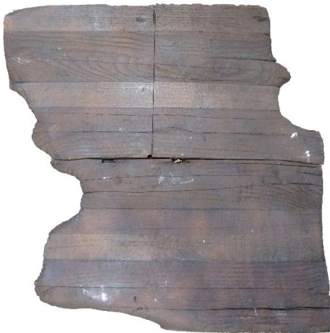
LH_BSH_Bu_NBH_1D brandbeanspruchte Seite, Kohleschicht entfernt
