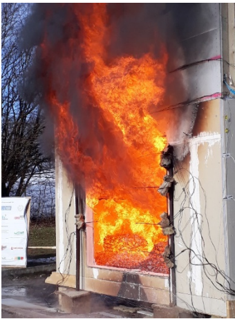
Abbildung 192: 45. Minute V1: Beginn der Abkühlphase
