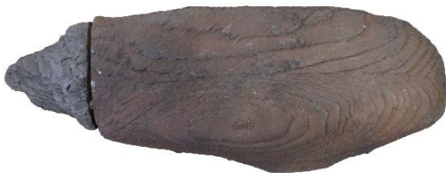
LH_BSH_Es_NBH_2D brandbeanspruchte Seite, Kohleschicht entfernt
