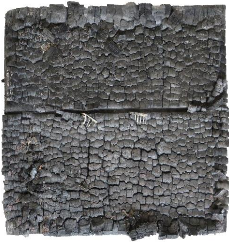
LH_FSH_Bu_NBH_1D brandbeanspruchte Seite, Kohleschicht
