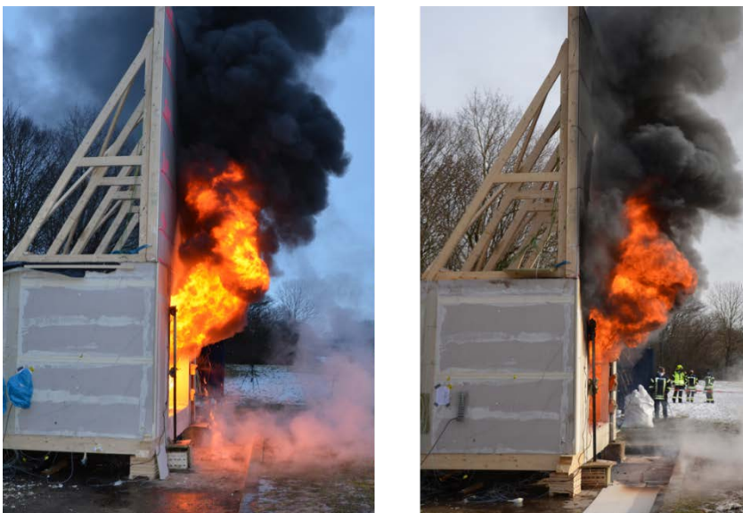
Abbildung 245: Aufnahmen während der Versuchsdurchführung (stationäre Brandphase) von V0 (links) und V1 (rechts)
