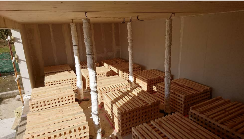
Abbildung 181: Darstellung der mobilen Brandlast durch Holzkippen
