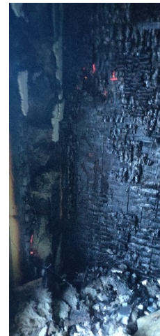
Abbildung 215: ca. 5 h nach Versuchsende V2: Glimmen des Brettsperholzes Wand 1
