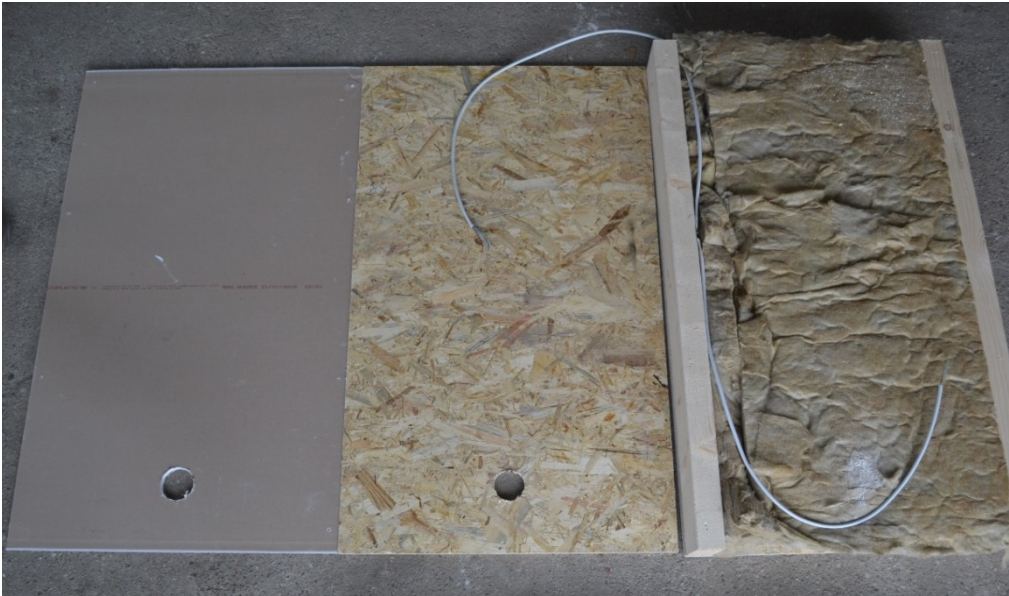
Abbildung 120: Prüfkörper mit am Ständer verlegtem halogenfreien Kabel nach Öffnung und Lichtbogeneinwirkung [95]
