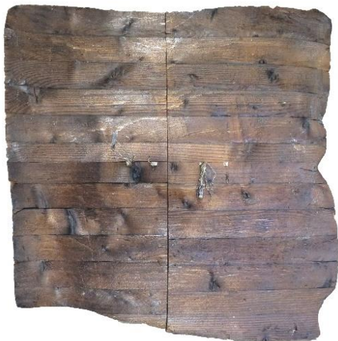
NH_BSH_Fi_NBG_1D brandbeanspruchte Seite, Kohleschicht entfernt
