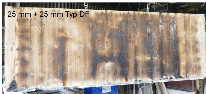
Abbildung 144: Verkohlungsbilder der anfänglich geschützten Bauteile in V05
