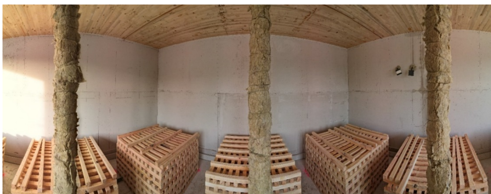
Abbildung 190: 360° Aufnahme aus dem Inneren des Brandraumes (V1)
