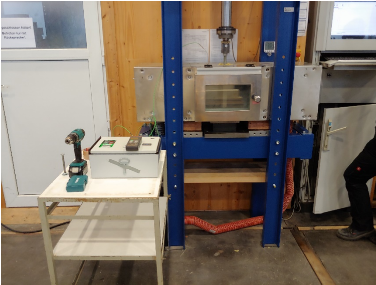
Abbildung 101: Aufbau des Prüfstandes mit der Thermobox
