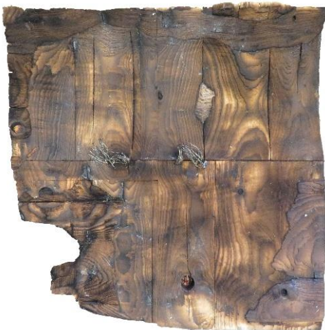
NH_BSP_Fi_ETK_1D_2 brandbeanspruchte Seite, Kohleschicht entfernt
