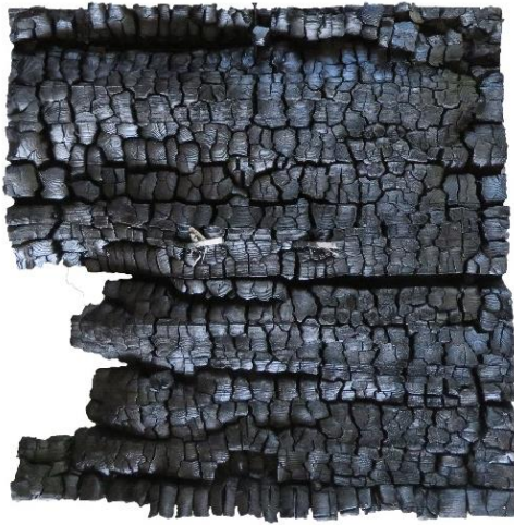
LH_BSH_Es_ETK_1D brandbeanspruchte Seite, Kohleschicht
