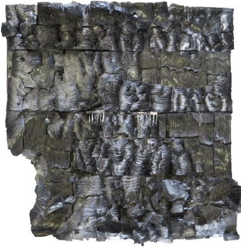
NH_BSP_Fi_NBH_1D brandbeanspruchte Seite, Kohleschicht
