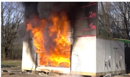
Abbildung 219: 45. Minute V3: Beginn der Abkühlphase
