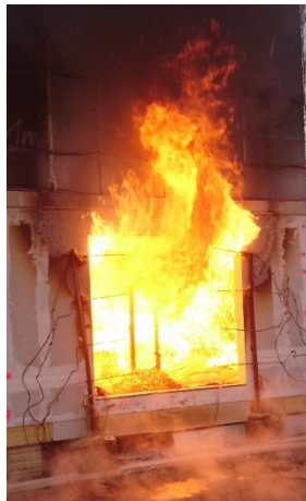
Abbildung 207: 45. Minute V2: Beginn der Abkühlphase
