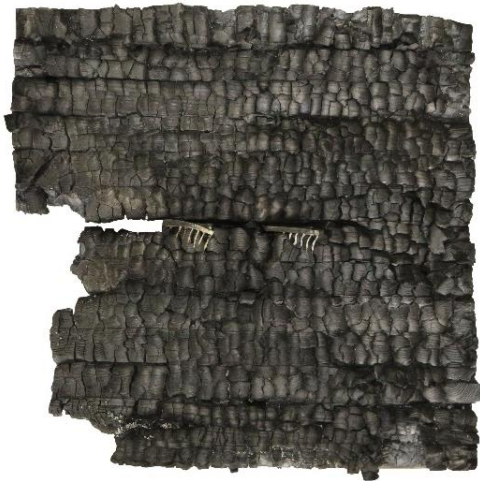
LH_BSH_Es_NBH_1D brandbeanspruchte Seite, Kohleschicht
