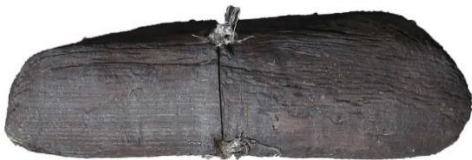
LH_VH_Ei_NBH_2D brandbeanspruchte Seite, Kohleschicht entfernt
