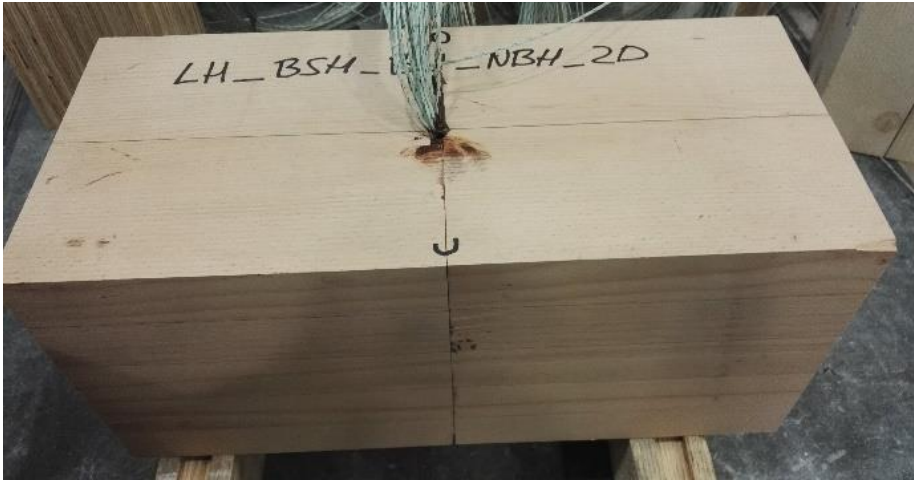
— Verklebter Versuchskörper mehrdimensional
