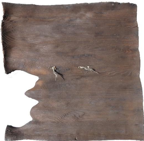
LH_BSH_Es_ETK_1D brandbeanspruchte Seite, Kohleschicht entfernt
