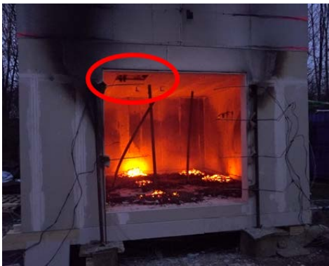
Abbildung 188: 115. Minute V0: Abfallen der oberen Lage der Bekleidung der Decke
