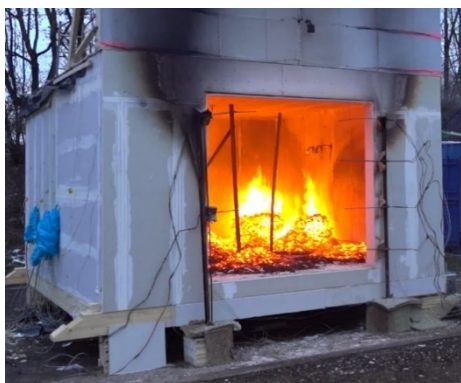
Abbildung 186: 60. Minute V0: nur Krippen hinten im Brandraum brennen
