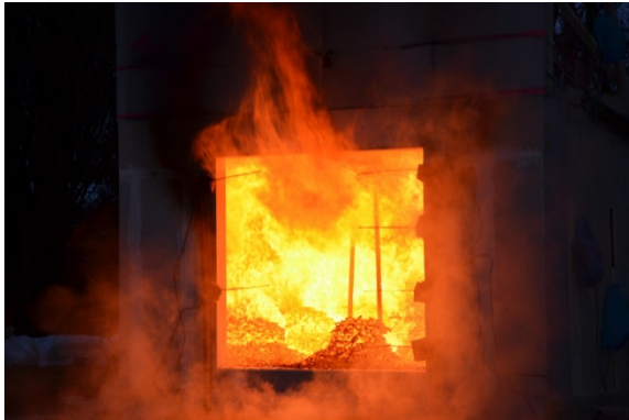
Abbildung 184: 40. Minute V0: Beginn der Abkühlphase
