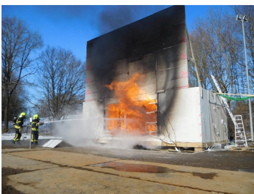
Abbildung 238: 65. Minute V4: Löschangriff
