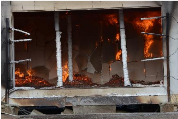
Abbildung 300: Brandraum V3 in der Abkühlphase
