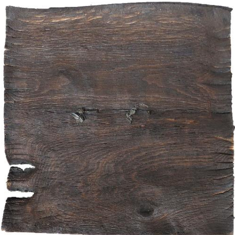
LH_VH_Ei_ETK_1D brandbeanspruchte Seite, Kohleschicht entfernt
