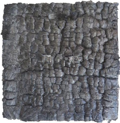
NH_FSH_Fi_NBH_1D brandbeanspruchte Seite, Kohleschicht
