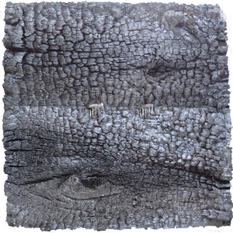
LH_VH_Ei_NBH_1D brandbeanspruchte Seite, Kohleschicht
