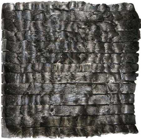
— NH_BSH_Fi_NBH_1D brandbeanspruchte Seite, Kohleschicht
