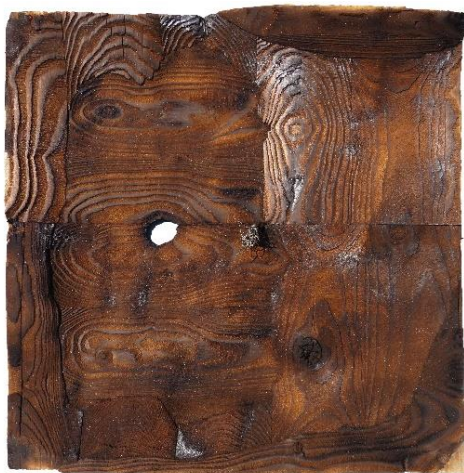
NH_BSP_Fi_ETK_1D brandbeanspruchte Seite, Kohleschicht entfernt
