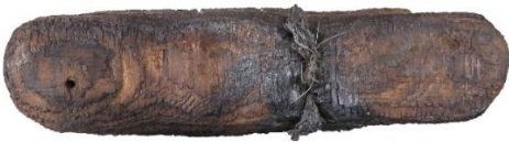
NH_FSH_Fi_ETK_2D brandbeanspruchte Seite, Kohleschicht entfernt
