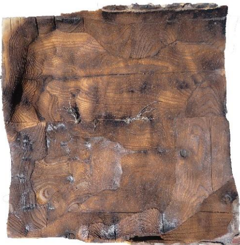
NH_BSP_Fi_ETK_1D_Akusta1 brandbeanspruchte Seite, Kohleschicht entfernt
