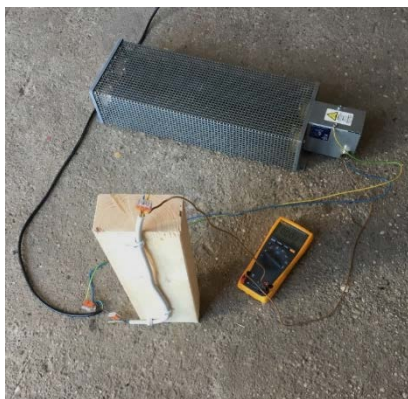
Abbildung 114: Versuchsanordnung senkrecht mit einer PVC-Elektroinstallation [95]
