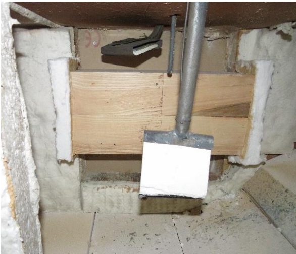
Eingebauter 2D Prüfkörper
