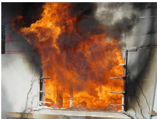
Abbildung 236: 50. Minute V4: Beginn der Abkühlphase
