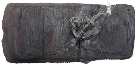
LH_FSH_Bu_NBH_2D brandbeanspruchte Seite, Kohleschicht entfernt
