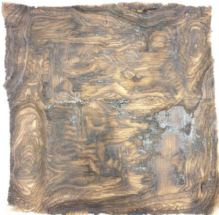
NH_FSH_Fi_ETK_1D brandbeanspruchte Seite, Kohleschicht entfernt
