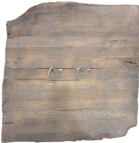
LH_BSH_Es_NBG_1D brandbeanspruchte Seite, Kohleschicht entfernt
