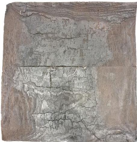
LH_FSH_Bu_NBH_1D brandbeanspruchte Seite, Kohleschicht entfernt
