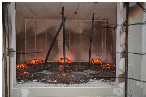
Abbildung 187: 103. Minute V0: Holzkrippen nur noch Glutreste
