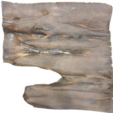
LH_VH_Bu_ETK_1D brandbeanspruchte Seite, Kohleschicht entfernt
