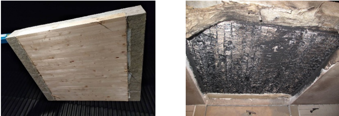
Abbildung 123: Unter-/Holzseite des Probekörpers vor (links) und unmittelbar nach dem Brandversuch (rechts)
