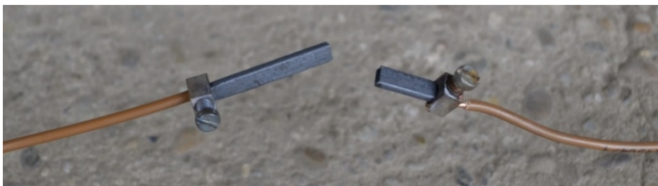
Abbildung 106: Graphitelektroden zur planmäßigen Lichtbogenerzeugung [95]
