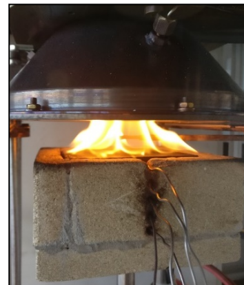
Abbildung 94: Versuchsaufbau (links) und Durchführung (rechts) ungeschützter Holzprobekörper im Cone-Kalorimeter
