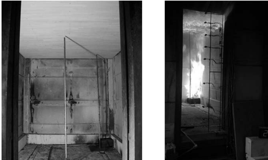
Abbildung 39: Versuchsaufbau RC_V2, links: Vor dem Versuch; rechts: In der stationären Brandphase (26. Versuchsminute)
