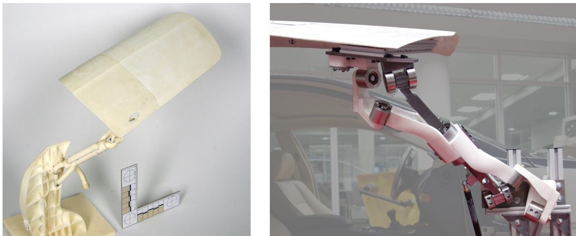
Abb. 1.7: Links das aus Polyamid mittels selektiven Lasersinterns gefertigte Getriebemodell im Maßstab 1:5 der Fahrzeugtürkinematik, das von Abdul-Sater et al. (2016) beschrieben wird. Rechts das Getriebemodell im Maßstab 1:1 mit teils klassisch gefertigten Bauteilen und aus Polyamid lasergesinterten Bauteilen, entnommen aus Laudahn et al. (2016).
