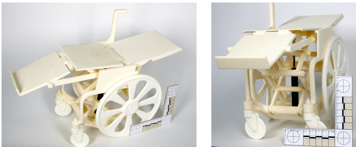
Abb. 1.6: Aus Polyamid mittels selektiven Lasersinterns gefertigtes Getriebemodell im Maßstab 1:4, das von D'Angelo et al. (2015) beschrieben wird.
