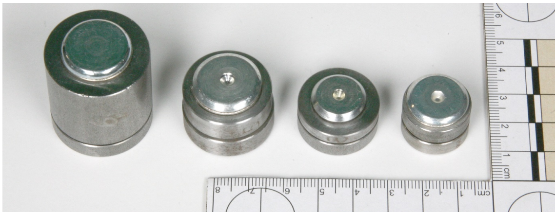
Abb. 4.11: Gelenkmodule von Drehgelenken einer Fahrzeugverdeckkinematik. Das größte abgebildete Gelenkmodul hat einen Durchmesser von 30 mm und eine Länge von 36 mm.
