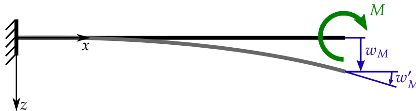
Abb. 4.4: Maximale Verschiebung w_M und maximaler Verdrehwinkel w'_M bei der Balkenbiegung unter eingepprägtem Moment M (Abbildung angelehnt an Gross et al. (2021, S. 107, S. 126))
