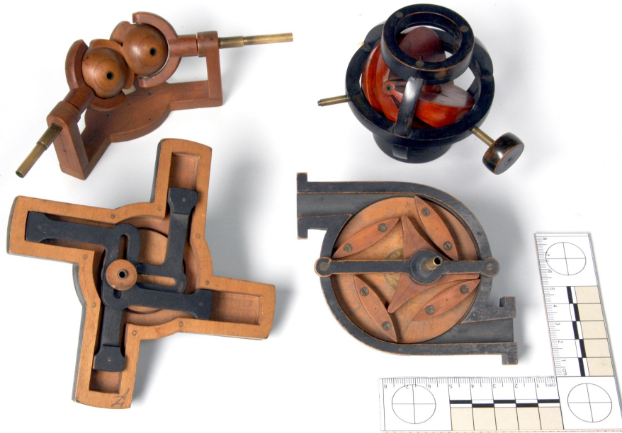
Abb. 1.3: Historische Getriebemodelle aus Holz aus der Getriebesammlung des Lehrstuhls für Mikrotechnik und Medizingerätetechnik der TU München
