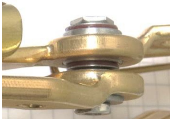
Abb. 5.6: Detailansicht des Getriebemodells mit einem eingepressten Gelenkmodul
