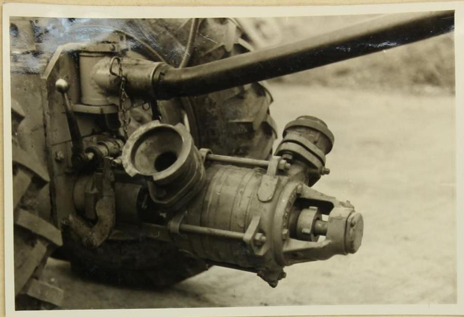
Selbstansaugende, zweistufige Apollo-Kreiselpumpe zur Erweiterung der Gerätereihe des ES 19/8, passend auch für ES 46/6, die universell einsetzbare Pumpe zum Beregnen und Feuerlöschzwecke, Bewässern, Entleeren von Gruben, Silos, Kellern usw. mit der hohen Leistung und dem guten Wirkungsgrad, der geringen Wartung bei höchster Betriebssicherheit.
