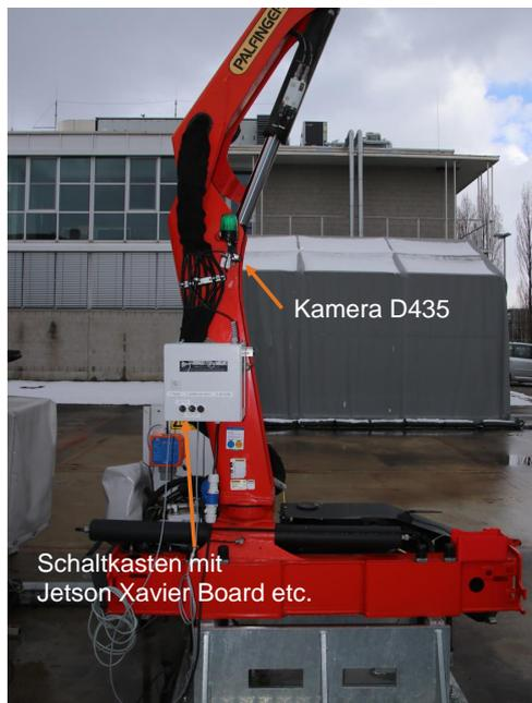
(a) Tiefenkamera RealSense D435 an der Kransäule
