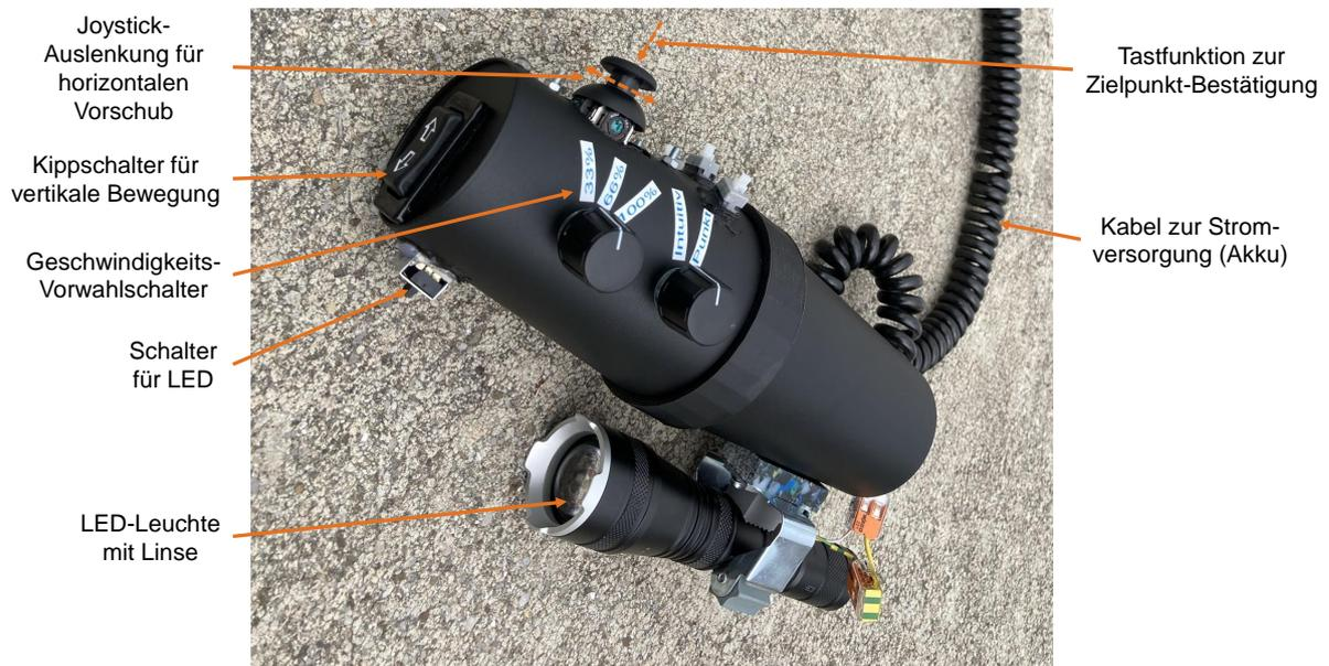
Abbildung 8-2: Funksender für die zielorientierte Lichtpunkt-Steuerung
