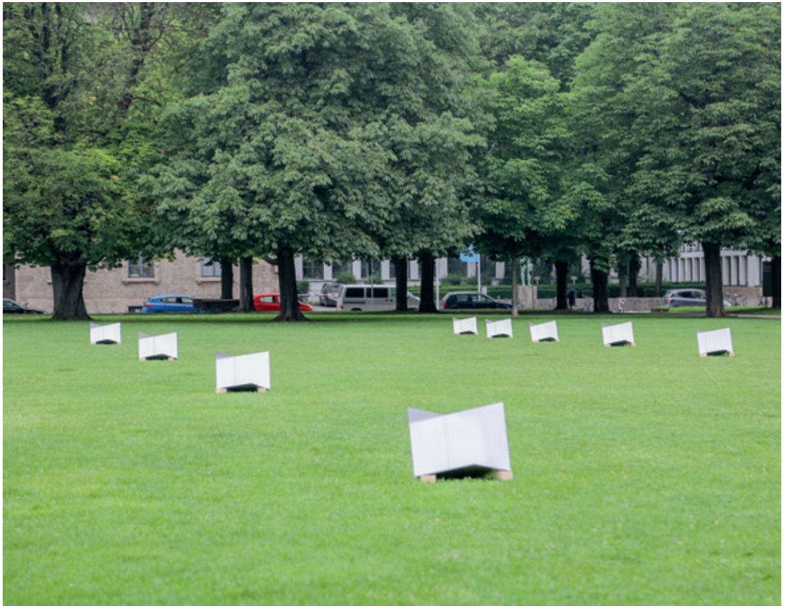
Die Corner-Reflektoren stehen bereit und warten auf den TerraSAR-X-Überflug. © Yuanyuan Wang
