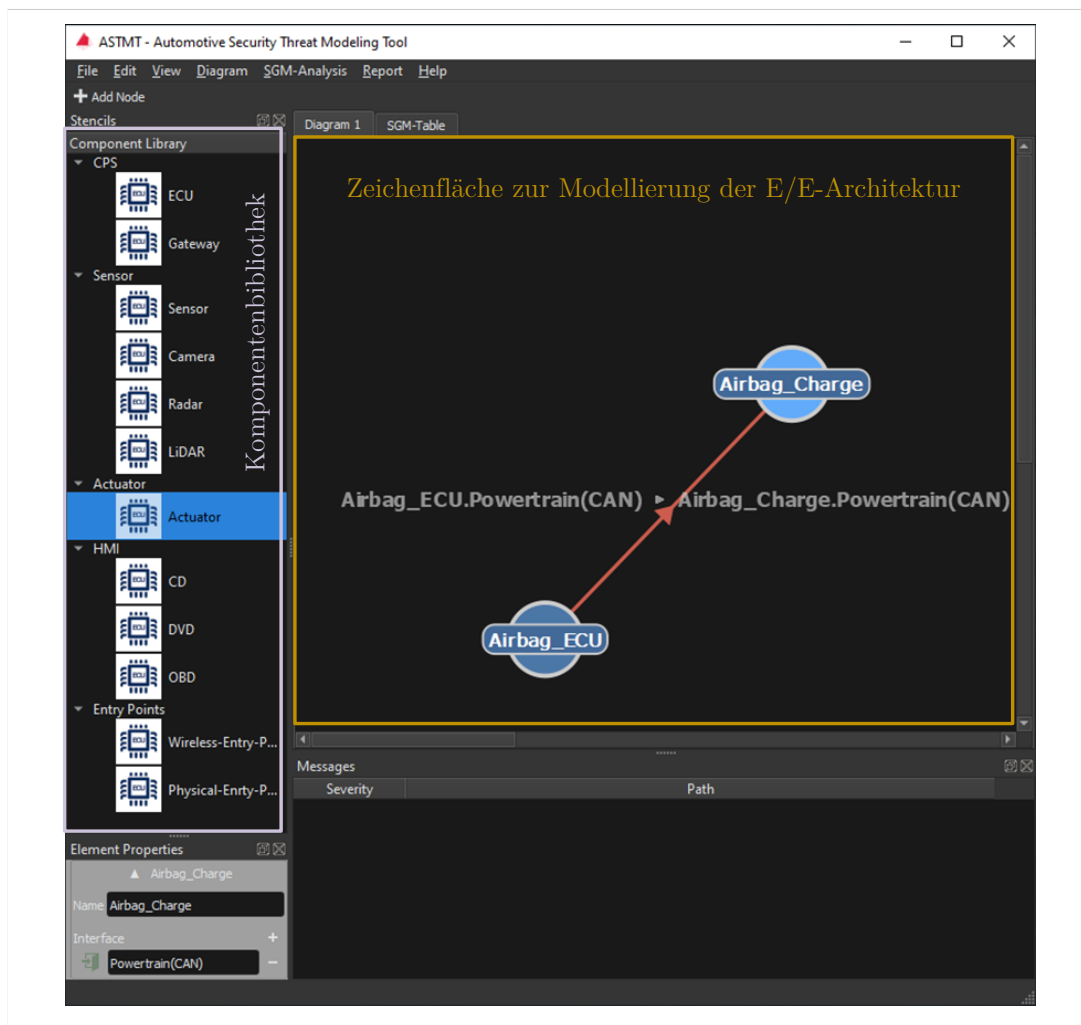
Abbildung E.1: Benutzeroberfläche des ASTMT mit der Komponentenbibliothek links und der Zeichenfläche für die E/E-Architektur in der rechten Bildhälfte.
