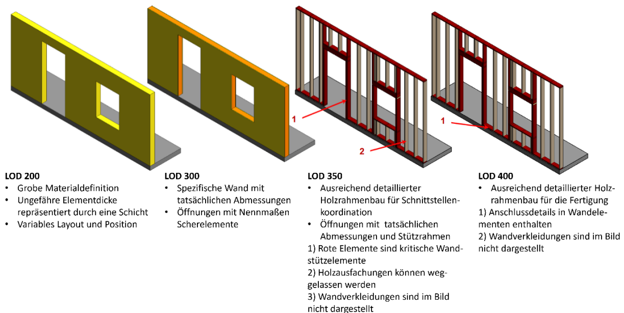
Abbildung 2-3: Verschiedene Reifegrade einer Holzständerwand (nach BIM Forum, 2020)
