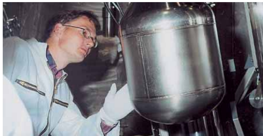
Inspektion der kalten Quelle vor ihrem Einbau.
