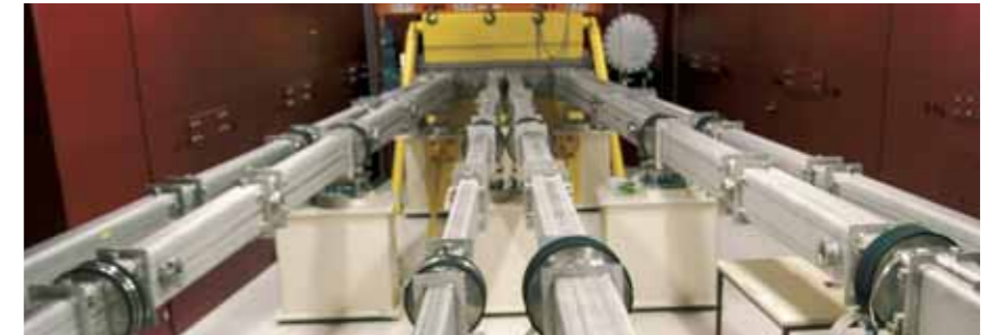
Blick in den Neutronenleitertunnel: Durch die umhüllten Neutronenleiter fliegen die kalten Neutronen vom Reaktor zu den Experimentierplätzen.
