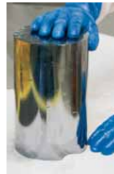
Das fertige Produkt: Siliziumblock nach der Dotierung durch Neutronen.
