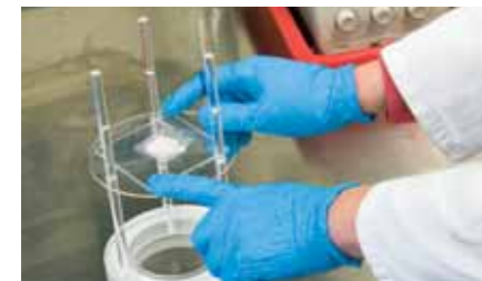
5. Vorbereiten der Probe für die Messung am Institut für Radiochemie nach der Bestrahlung am FRM II.
