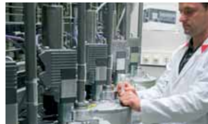
3. Einsetzen der Probenkapsel in die Rohrpostanlage.
