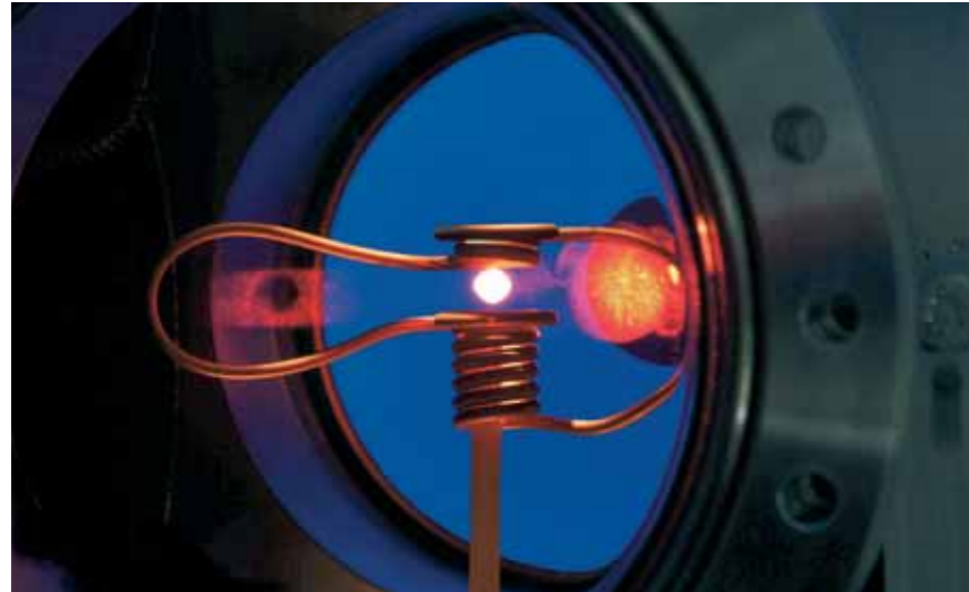
Schwebender flüssiger Metalltropfen in der Probenkammer des Instruments TOFTOF.
