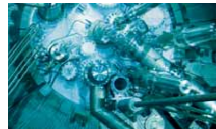
4. Über die Rohrpostanlage (im Bild links) wird die Probe in die Bestrahlungsposition im Moderatorreaktor.
