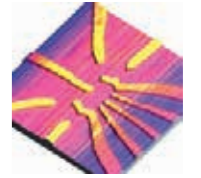
Paar von elektrostatisch definierten Quantenpunkten
