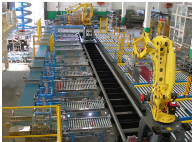
Abbildung 2-7: Zwei Roboter auf einer gemeinsamen Führungsschiene [Erd-2014]
