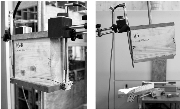
Abbildung 5.1 Versagte HBH-Prüfkörper der Tastversuche, I FE, ( \alpha_{FL} = 90^\circ )
