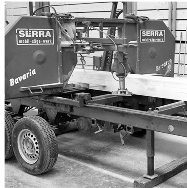
(b) Auftrennen der BSH Balken
