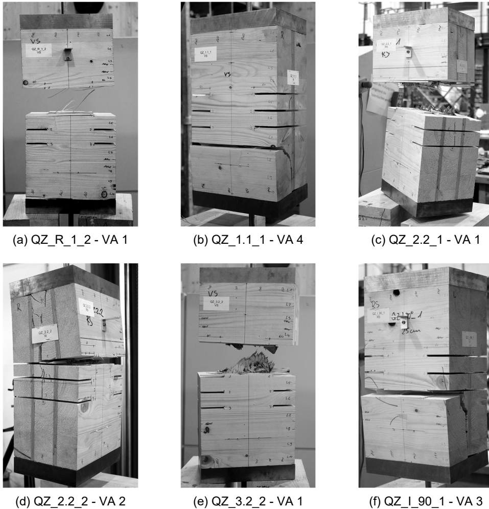
Abbildung 5.3 Versagensarten der BSH- und HBH-Prüfkörper unter Querzugbeanspruchung
