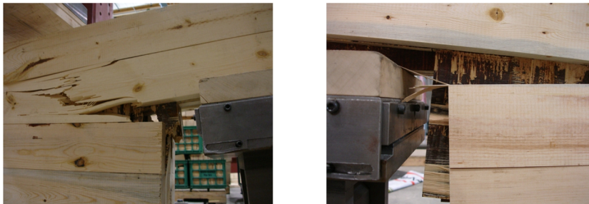
(a) Zugversagen der Querlagen
