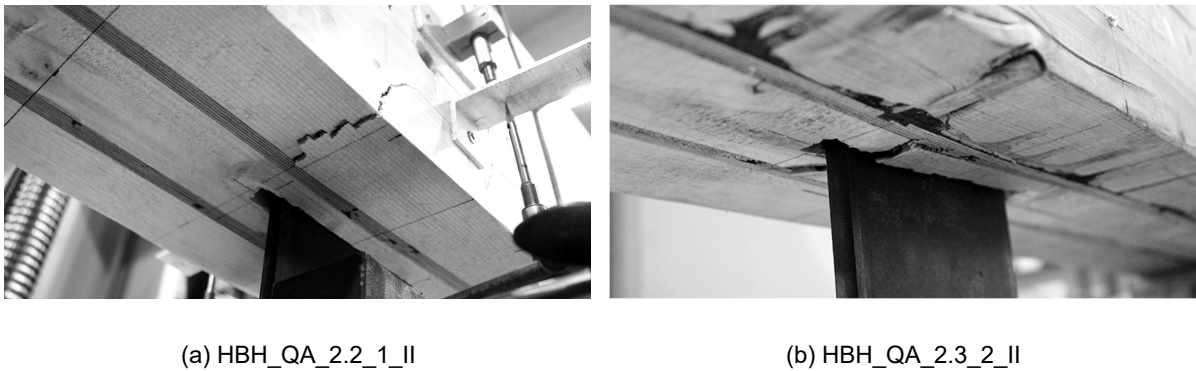
Abbildung 6.54 Rissbildung in den Prüfkörpern der HBH-Serie 2
