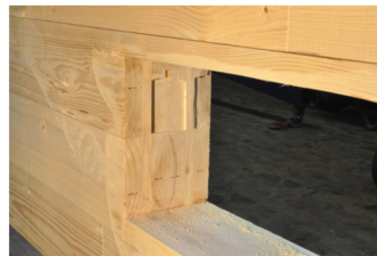
(b) Schubversagen der Klebefuge
