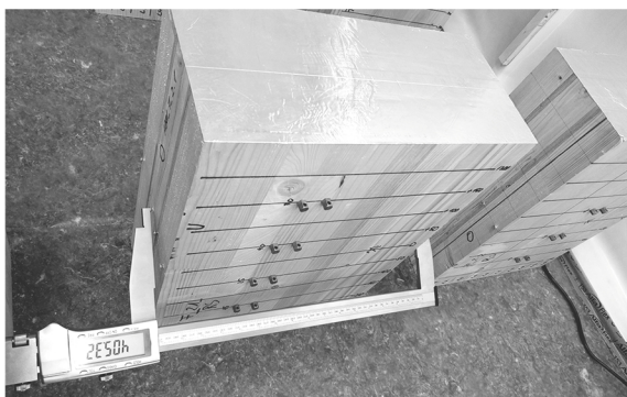
(a) Messprinzip der Verformungsänderung
