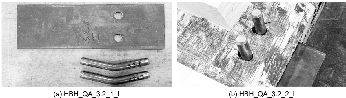
Abbildung 6.56 Verformte Stabdübel der Anschlusskonstruktion in HBH-Serie 3
