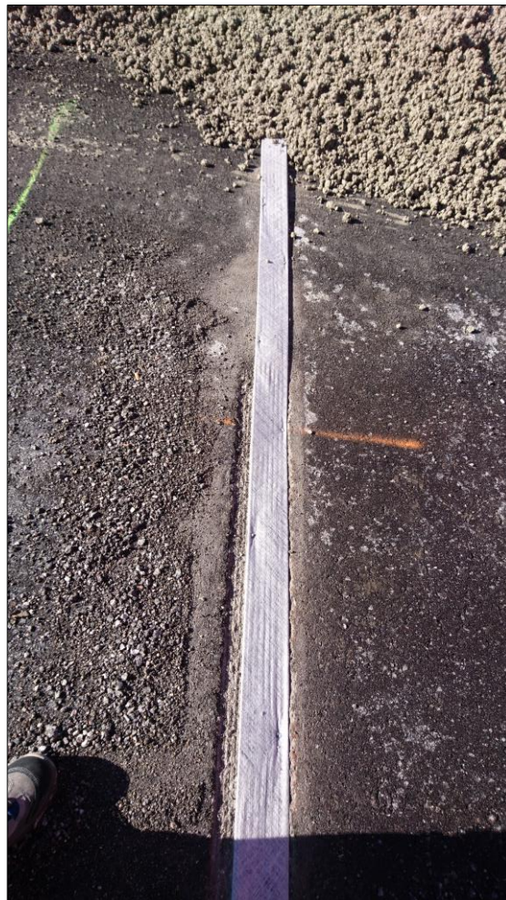
Feldversuch - Beschädigter Flachdrain und Frässtreifen für Flachdrain
