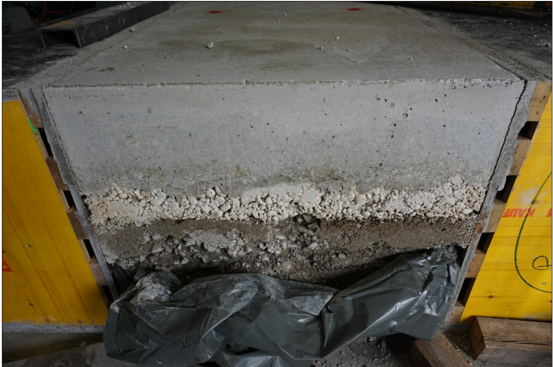
Großversuch - Schichtaufbau (HGT)
