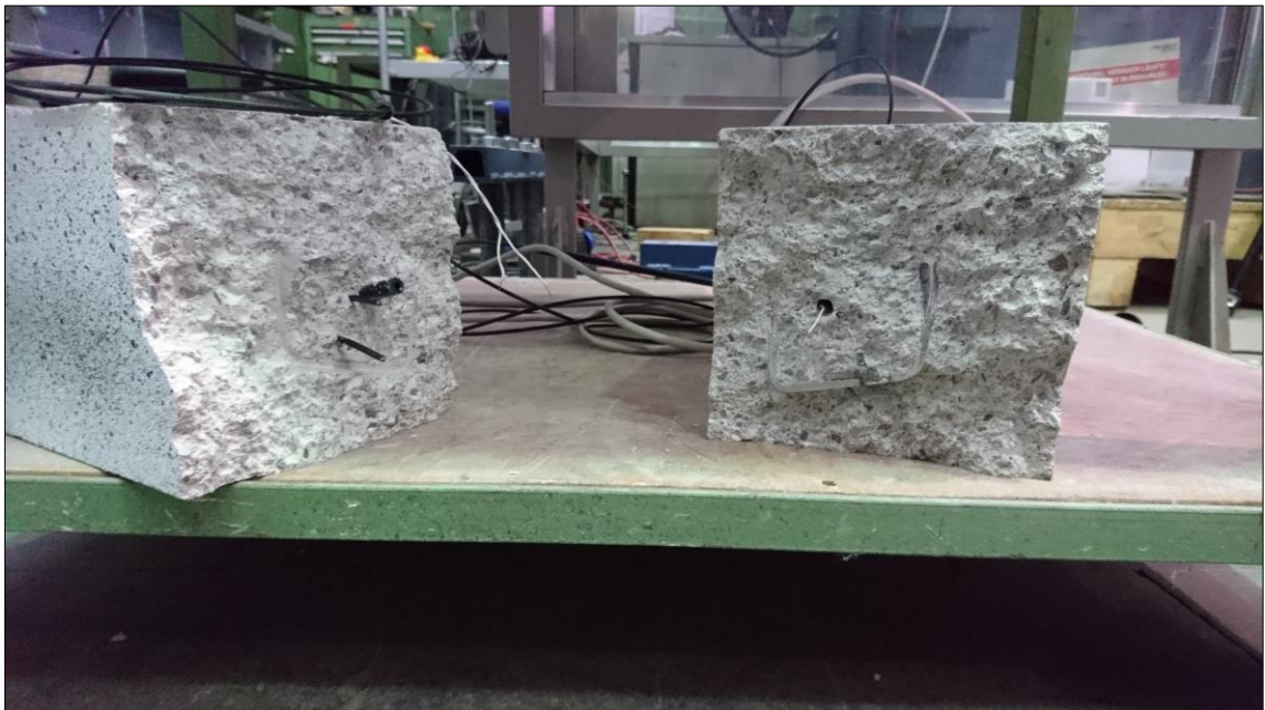
Stufe 0 - Balken 1 nach Bruch mit eingebautem DMK
