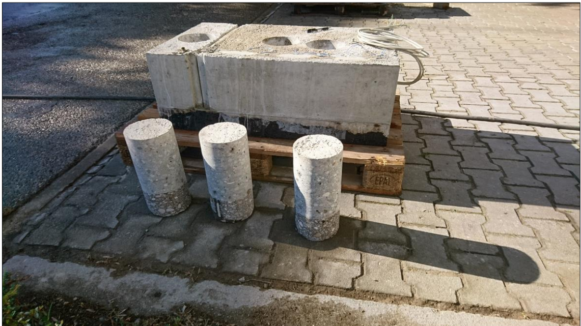
Stufe 1 - Bohrkern Aufbau 1F
