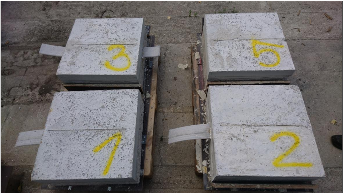
Laborversuche zur Entwässerung - Probekörper mit Flachdrain
