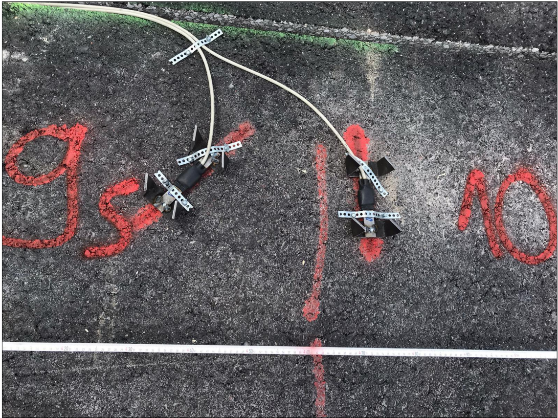
Feldversuch - Fixierte DMK mit Kabelschlitz
