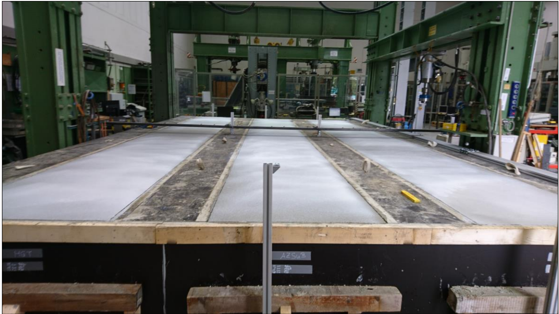
Großversuch - Nachbehandlung Betondecke
