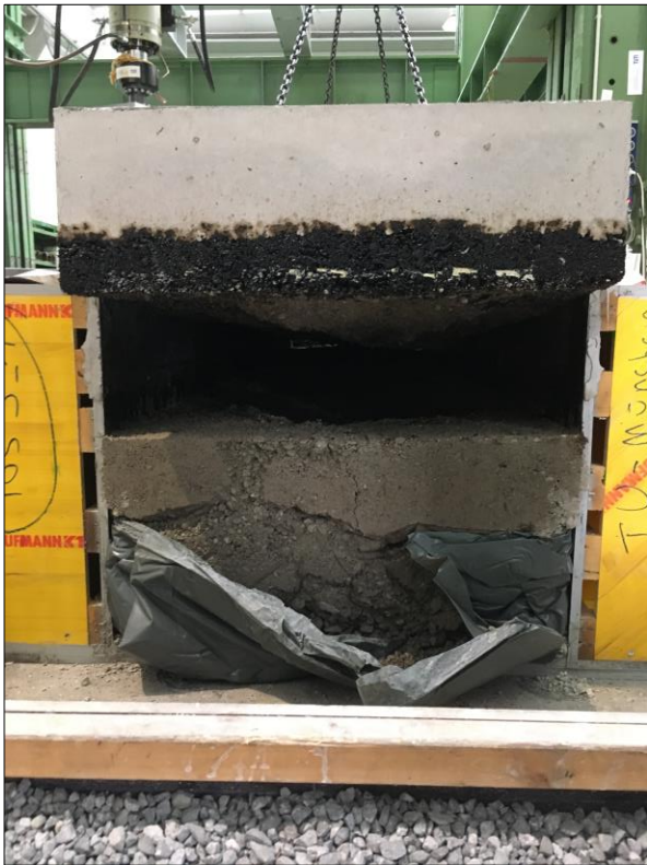
Großversuch - Schichtaufbau (ATS)
