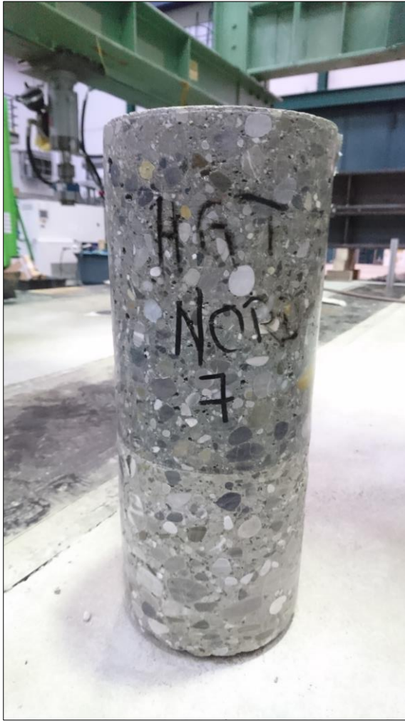
Großversuch - Bohrkern (HGT)
