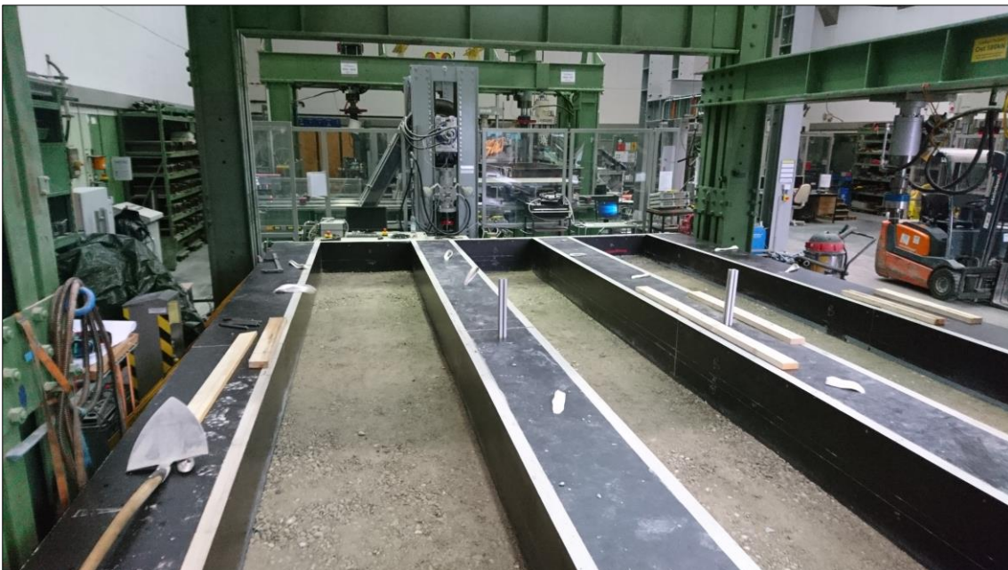
Großversuch - Einbau FSS in der Schalung
