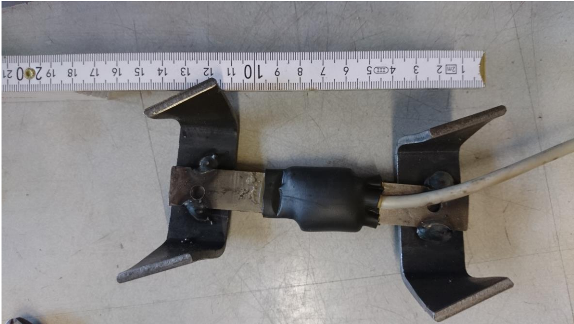
Abbildung 19: Messtechnik - DMK mit applizierten DMS und Schutzhülle
