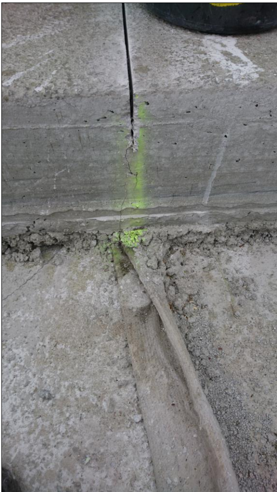
Feldversuch - Beschädigter Flachdrain und Frässtreifen für Flachdrain
