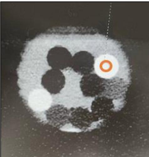
Abbildung 11: Beispiel einer DL-CT Aufnahme der Jodkonzentrationsmessung der Messstäbe innerhalb des Jodbades mit platzierter ROI in einem Messstab (orange), Vorstudie 2.
