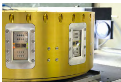
Nahaufnahme des Nutzlastmoduls „Organische und hybride Solarzellen im Weltraum“ (OHSCIS). BILD Benjamin Predeschly / TUM
