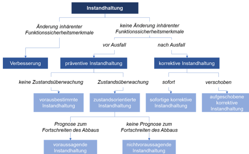
Abbildung 2-19: Übersicht über Instandhaltungsarten [DIN-13306]
