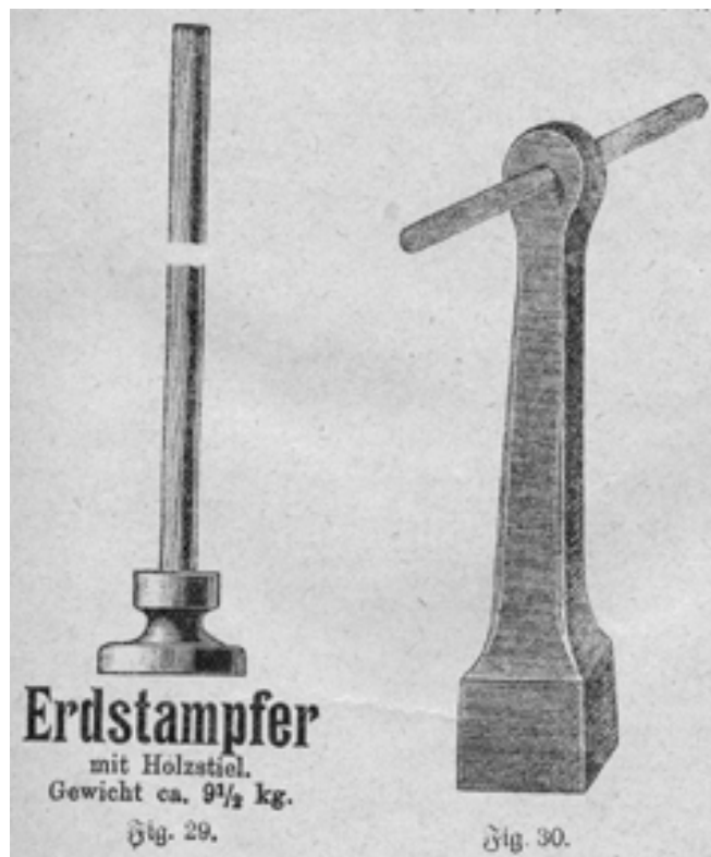
Abb. 6: Stampfgeräte zum Verdichten des Betons um 1905
