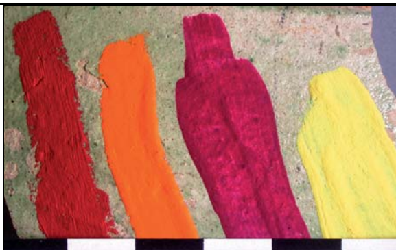
49 Farbaufträge, vor dem Strahlen
