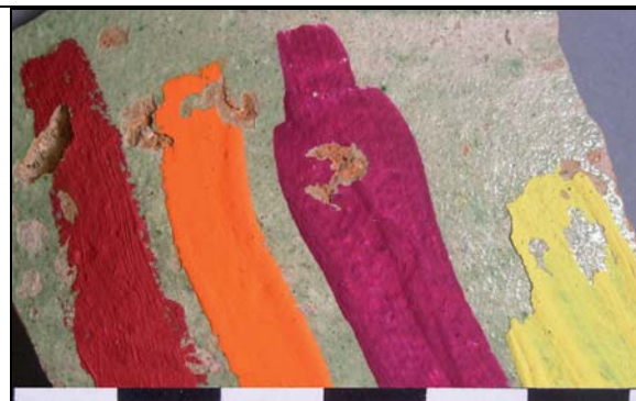
50 Farbaufträge, nach dem Strahlen
