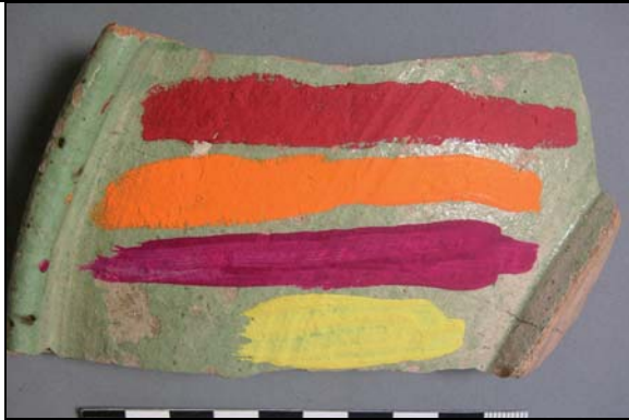
48 Glasierter Keramikscherben mit Farbaufstrichen aus Öl-/Harz- Gouache- und Acrylfarben
