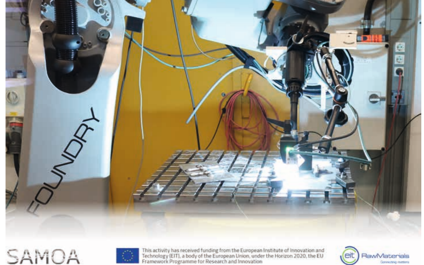
Abb. 1: Aufbau des Wire Arc Additive Manufacturing Fertigungssystems mit 6-Achs-Industrieroboter und Drehkippstisch
