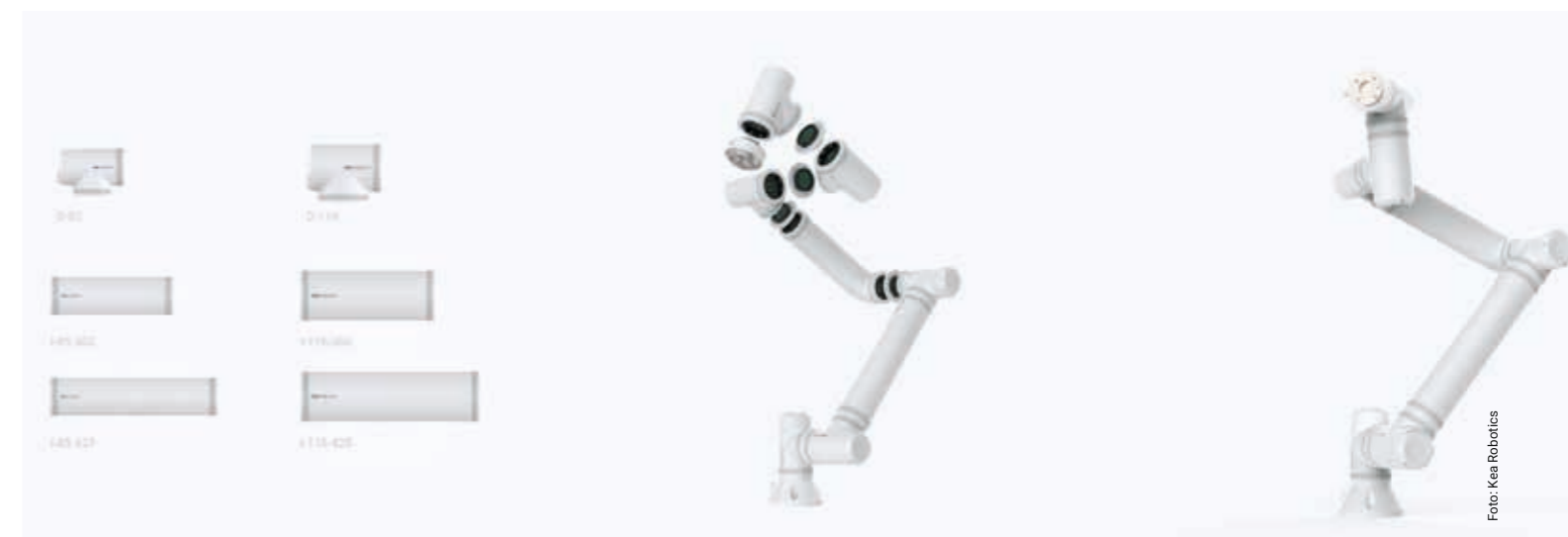
Konzept von Kea Robotics: Aus Modulen können verschiedene Roboterarme konfiguriert werden, die nach dem Zusammenbau auf Grund smarterer Algorithmen sofort nutzbar sind
