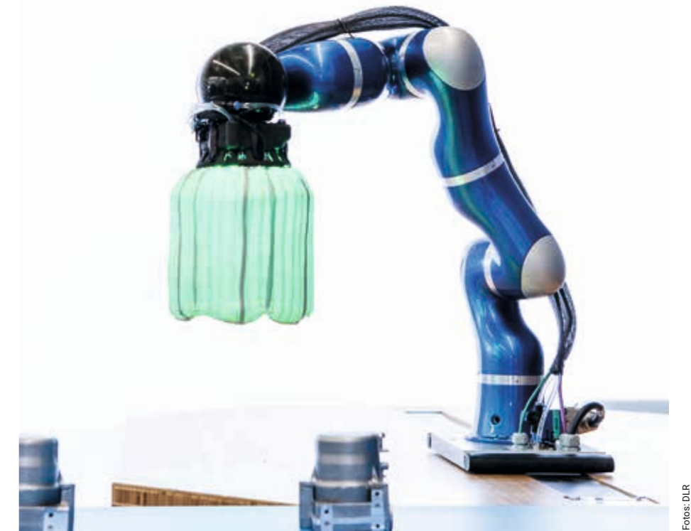
DLR Leichtbauroboter mit aktiviertem Airbag
