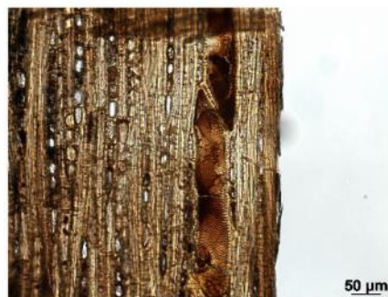
D71_H1a: Tangentialschnitt, 400-fache Vergrößerung.
