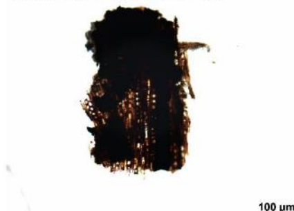
D70_H1a: Tangentialschnitt, 200-fache Vergrößerung.
