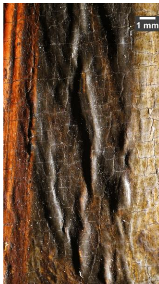
Abb. 60: „Blasen“ in Malschicht
