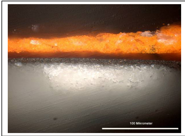
Probe 3 bei fünfzigfacher Vergrößerung: Auf dem Wismut liegt ein transparenter Überzug, darauf Rot und noch ein Überzug Im Dunkelfeld
