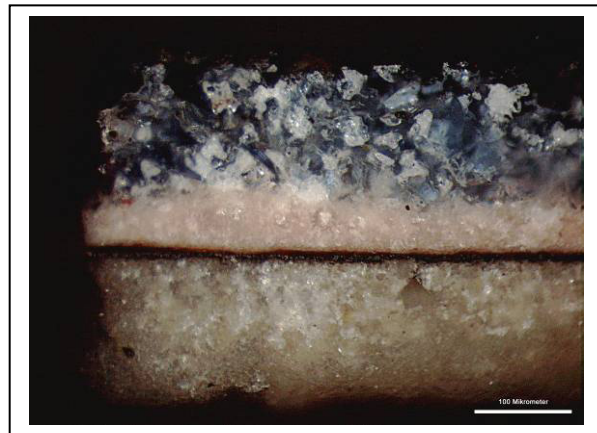
Auf dem Wismut liegt ein gelber transparenter Überzug, die Blüte wurde mit rosafarben unterlegt und mit aufgehellten Blau ausgeführt (Dunkelfeld, zwanzigfache Vergrößerung)
