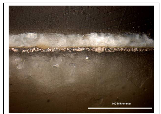
Probe zwei bei fünfzigfacher Vergrößerung: Auf dem Wismut liegt ein gelber Überzug, darauf Weiß, dass nochmals mit einem Überzug versehen wurde Im Dunkelfeld
