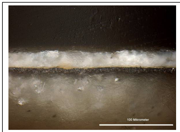
Probe zwei bei fünfzigfacher Vergrößerung: Auf dem Wismut liegt ein gelber Überzug, darauf Weiß, dass nochmals mit einem Überzug versehen wurde Im Dunkelfeld
