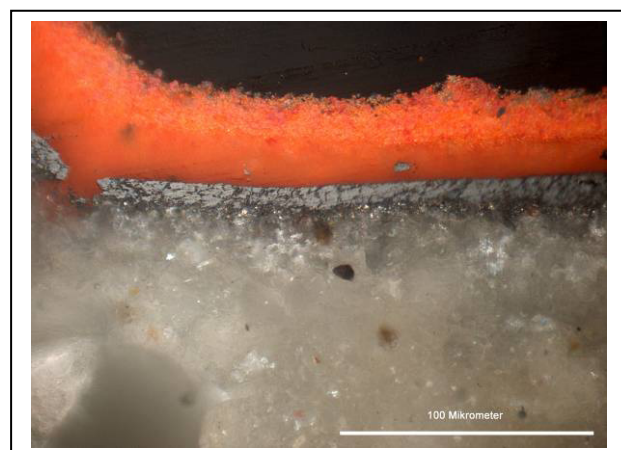
Im Querschliff (Dunkelfeld, zwanzigfache Vergrößerung) sieht man Rot auf der Wismutschicht, darüber partiell Gelb und einen dicken Überzug
