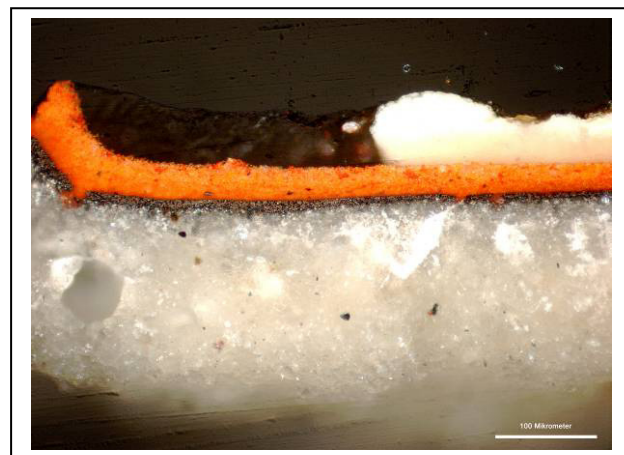
Im Querschliff (Dunkelfeld, zwanzigfache Vergrößerung) sieht man Rot auf der Wismutschicht, darüber partiell Gelb und einen dicken Überzug
