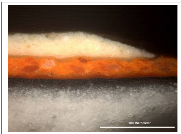
Probe sechs bei fünfzigfacher Vergrößerung Auf der Wismutschicht sieht man einen transparenten Überzug, darauf ein Rot, das mit einem Überzug versehen wurde und partiell ein Gelb
