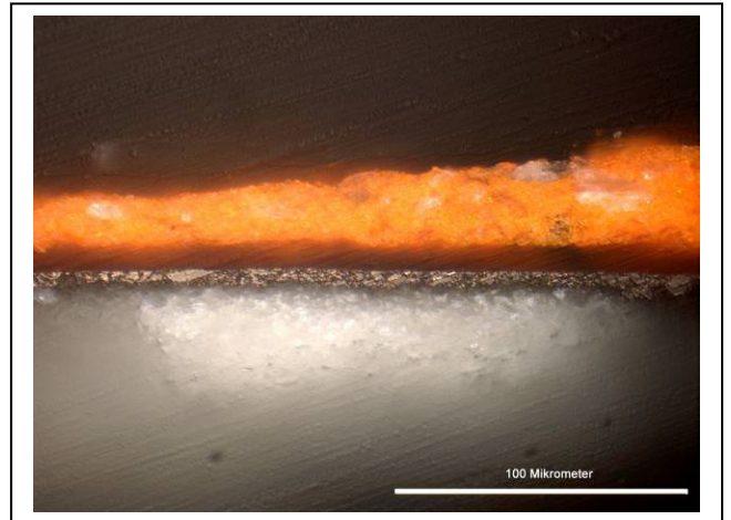
Probe 3 bei fünfzigfacher Vergrößerung: Auf dem Wismut liegt ein transparenter Überzug, darauf Rot und noch ein Überzug Im Dunkelfeld
