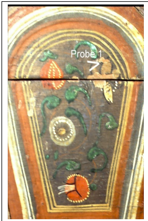
Probe eins: Entnahmestelle an der linken Seite: Wismut auf Grundierung im Querschliff im Hellfeld fotografiert
