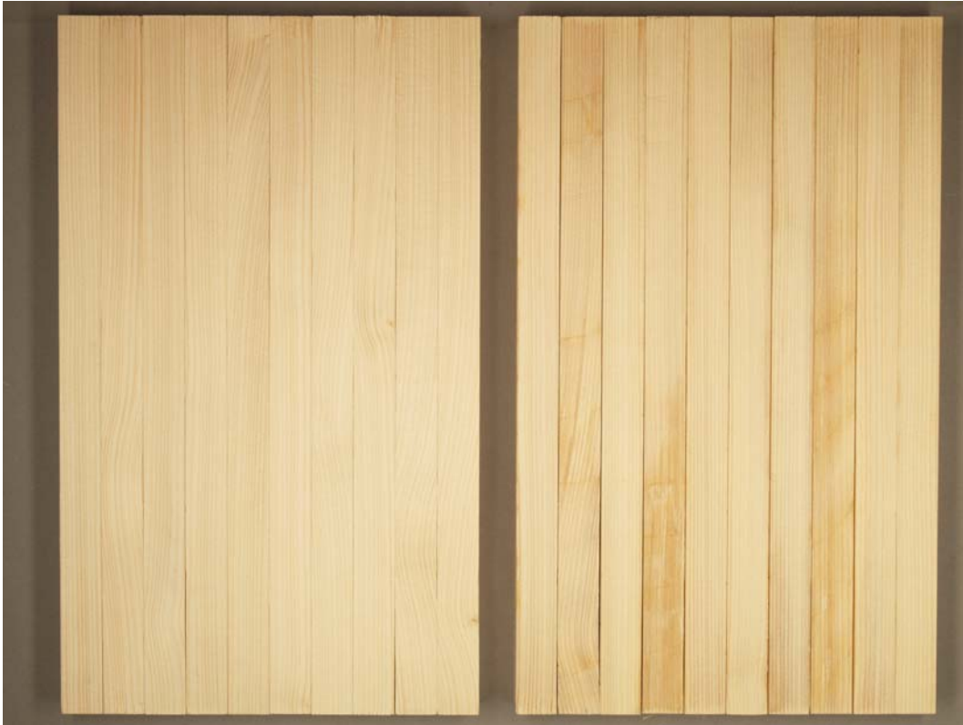
Abb. 16: Kiefernprüfkörper Links unbehandelte, Rechts mit MMA getränkte
