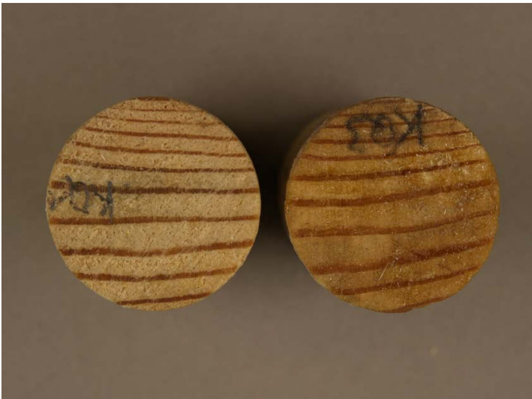
Abb. 3: Kiefernprüfzylinder, Querschnittsansicht Links unbehandelt, Rechts mit MMA getränkt
