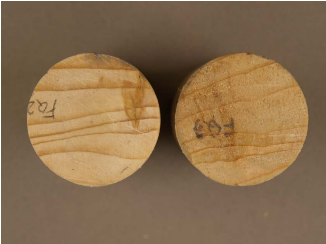
Abb. 6: Fichtenprüfzylinder, Querschnittsansicht Links unbehandelt, Rechts mit MMA getränkt
