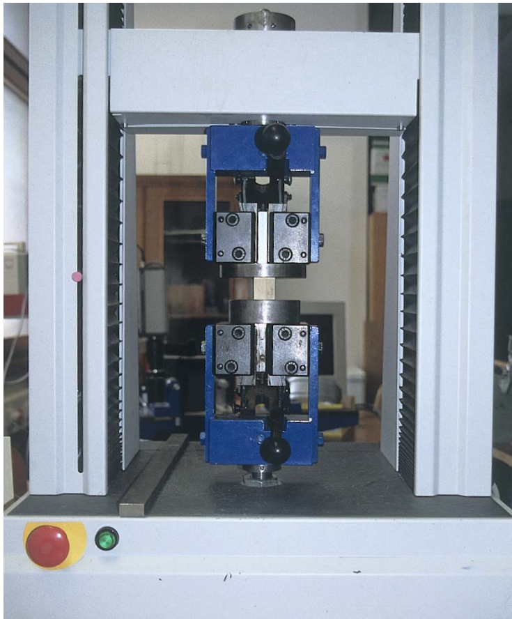
Abb. 24: Druckprüfeinrichtung – mechanisch, Druckversuch (Institut für Holzforschung München)
