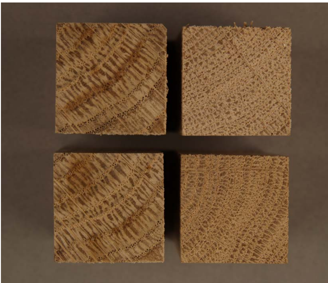
Abb. 15: Eichenprüfkörper, Querschnitt Links mit MMA getränkt, Rechts unbehandelt
