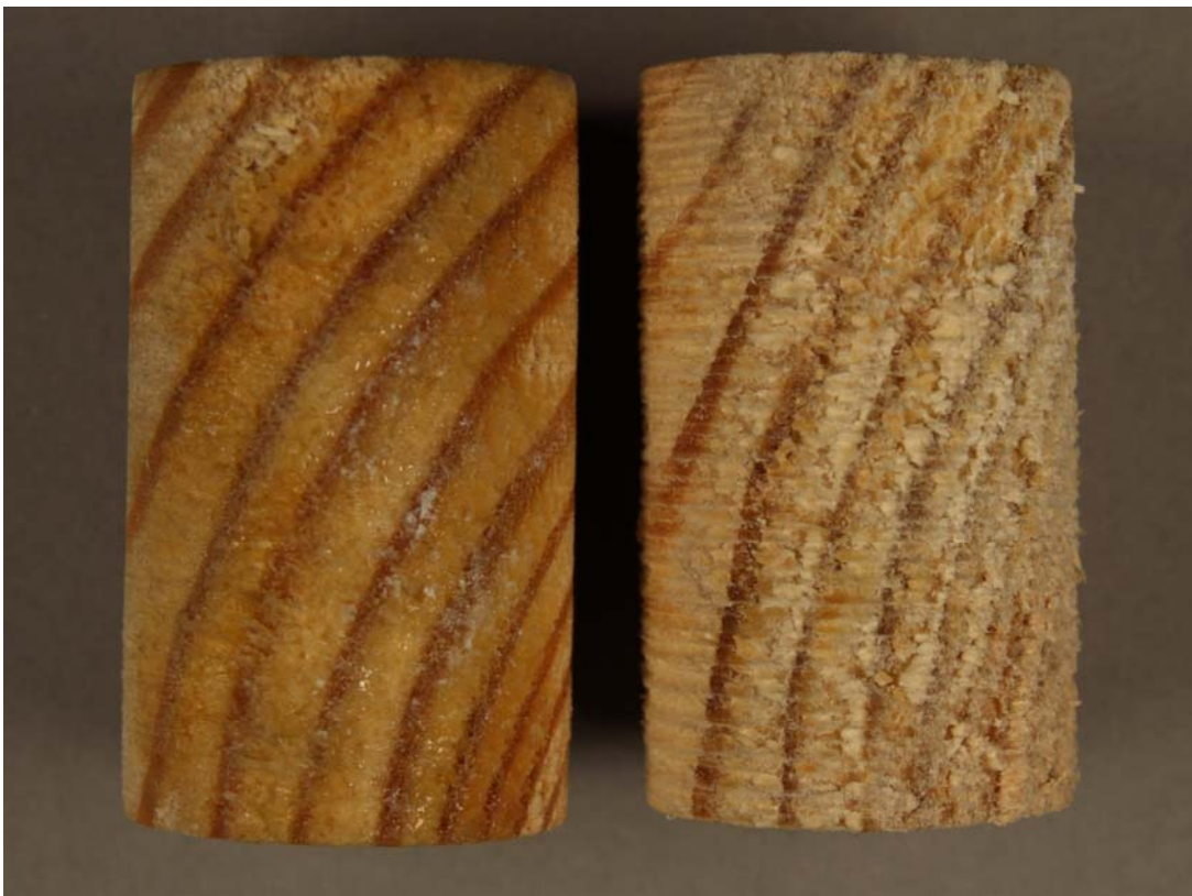
Abb. 5: Kiefernprüfzylinder, Radialansicht Links mit MMA getränkt, Rechts unbehandelt
