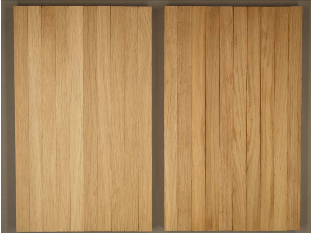
Abb. 14: Eichenprüfkörper Links unbehandelte, Rechts mit MMA getränkte
