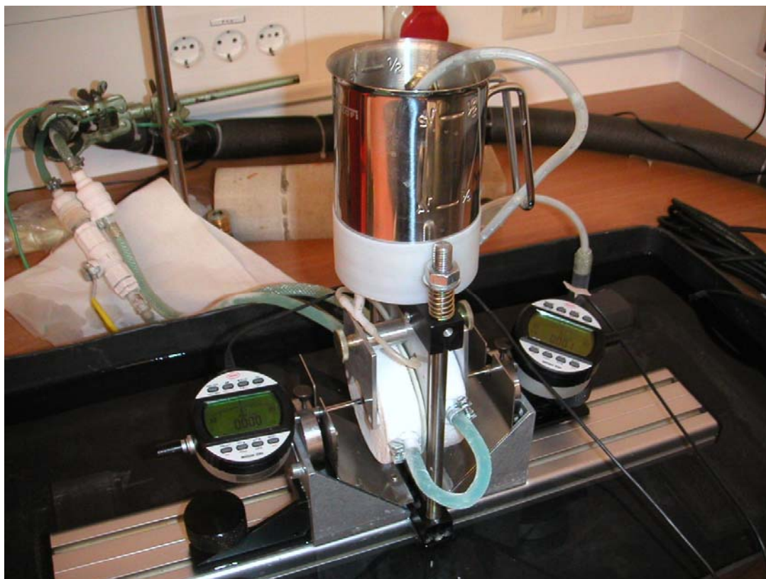
Abb. 13: Messapparatur zur Thermisch-Hygrischen-Dehnung (Firma „IBACH Steinkonservierung“)
