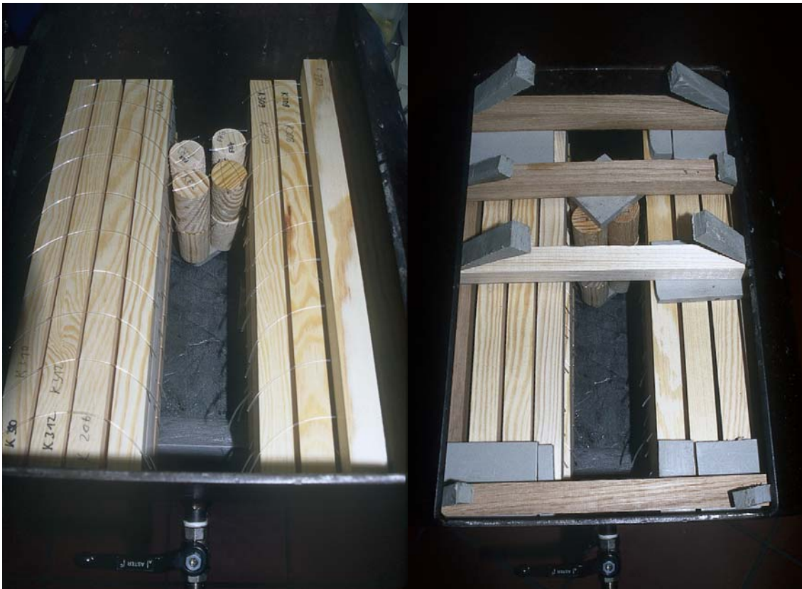
Abb. 12: Beschickung des Tränkbehälters für den Laborautoklaven (Firma „IBACH Steinkonservierung“)
