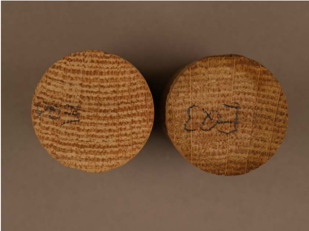
Abb.7: Eichenprüfzylinder, Querschnittsansicht Links unbehandelt, Rechts mit MMA getränkt
