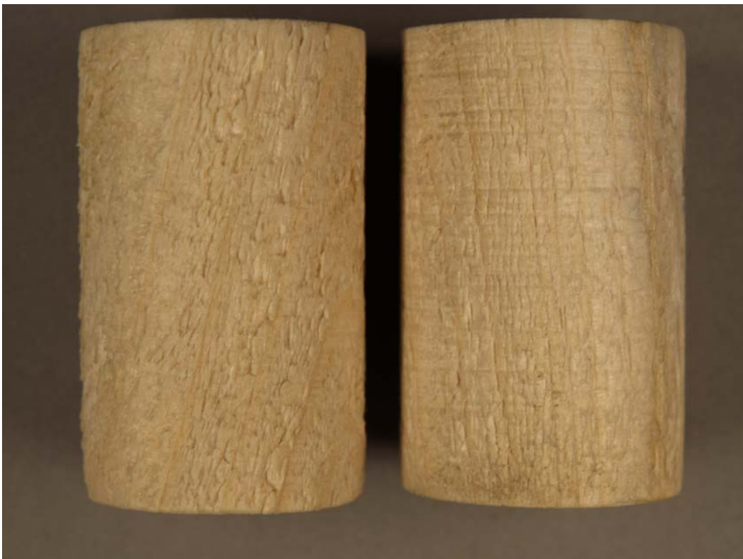
Abb. 7: Fichtenprüfzylinder, Tangentialansicht Links unbehandelt, Rechts mit MMA getränkt
