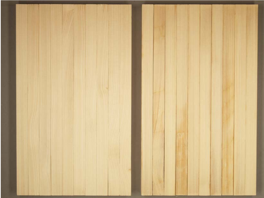
Abb. 18: Fichtenprüfkörper Links unbehandelte, Rechts mit MMA getränkte
