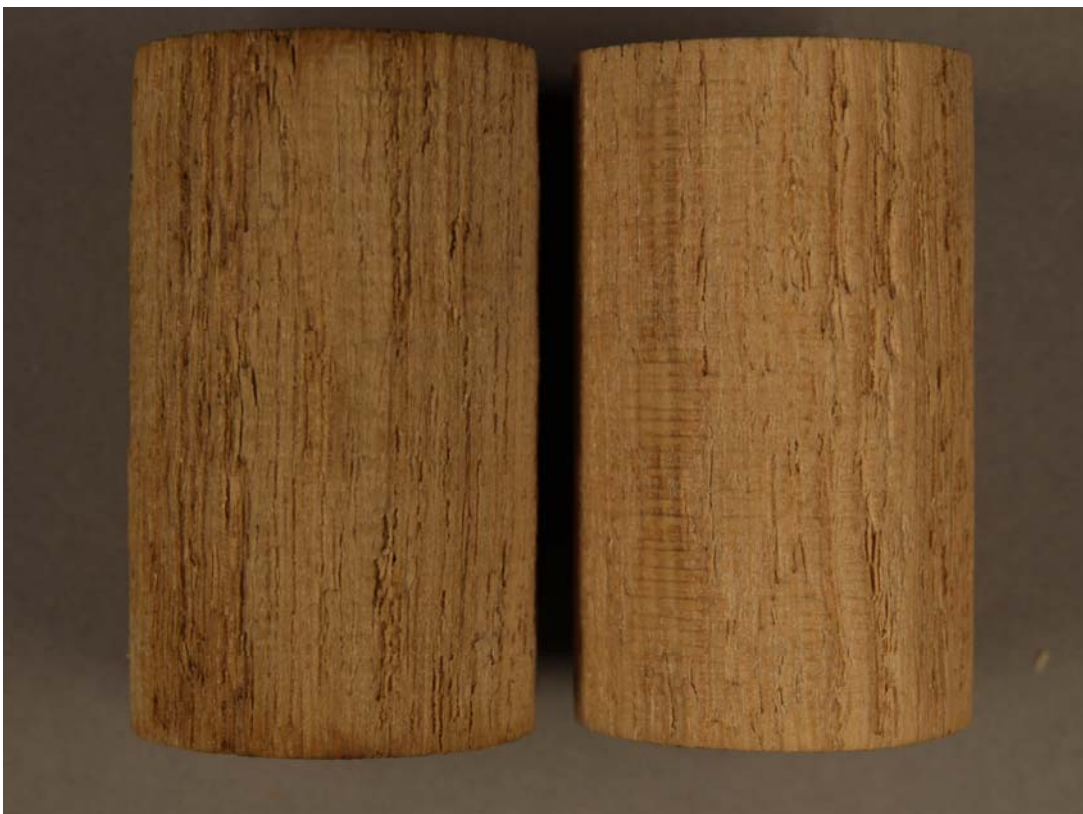
Abb. 1: Eichenprüfzylinder, Tangentialansicht Links mit MMA getränkt, Rechts unbehandelt
