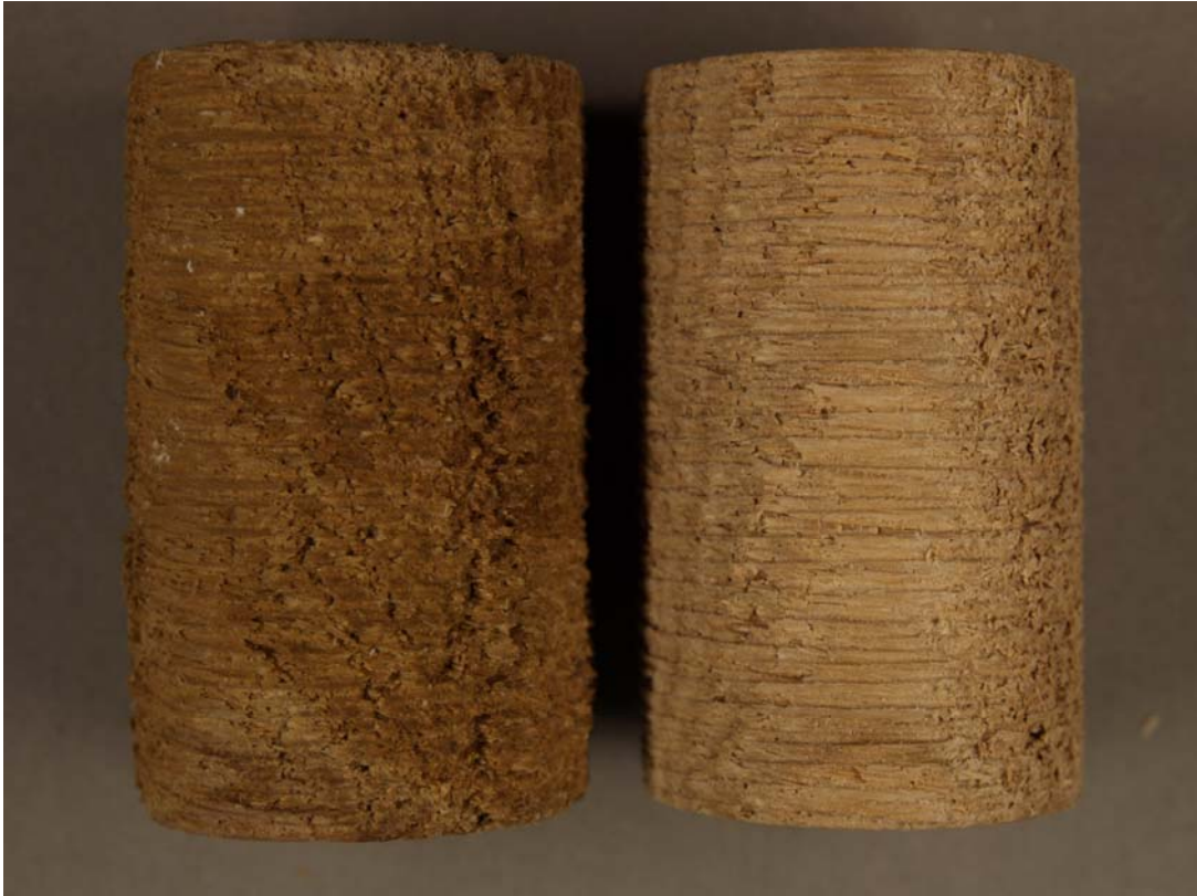
Abb. 2: Eichenprüfzylinder, Radialansicht Links mit MMA getränkt, Rechts unbehandelt
