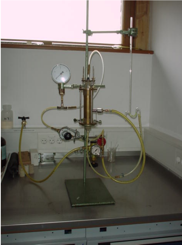
Abb. 9: Hassler-Zelle zur Messung der Luftpermeabilität (Firma „IBACH Steinkonservierung“)
