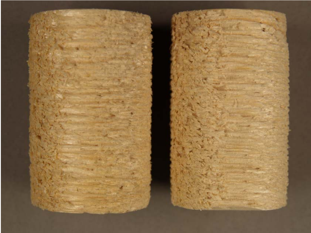
Abb. 8: Fichtenprüfzylinder, Radialansicht Links unbehandelt, Rechts mit MMA getränkt
