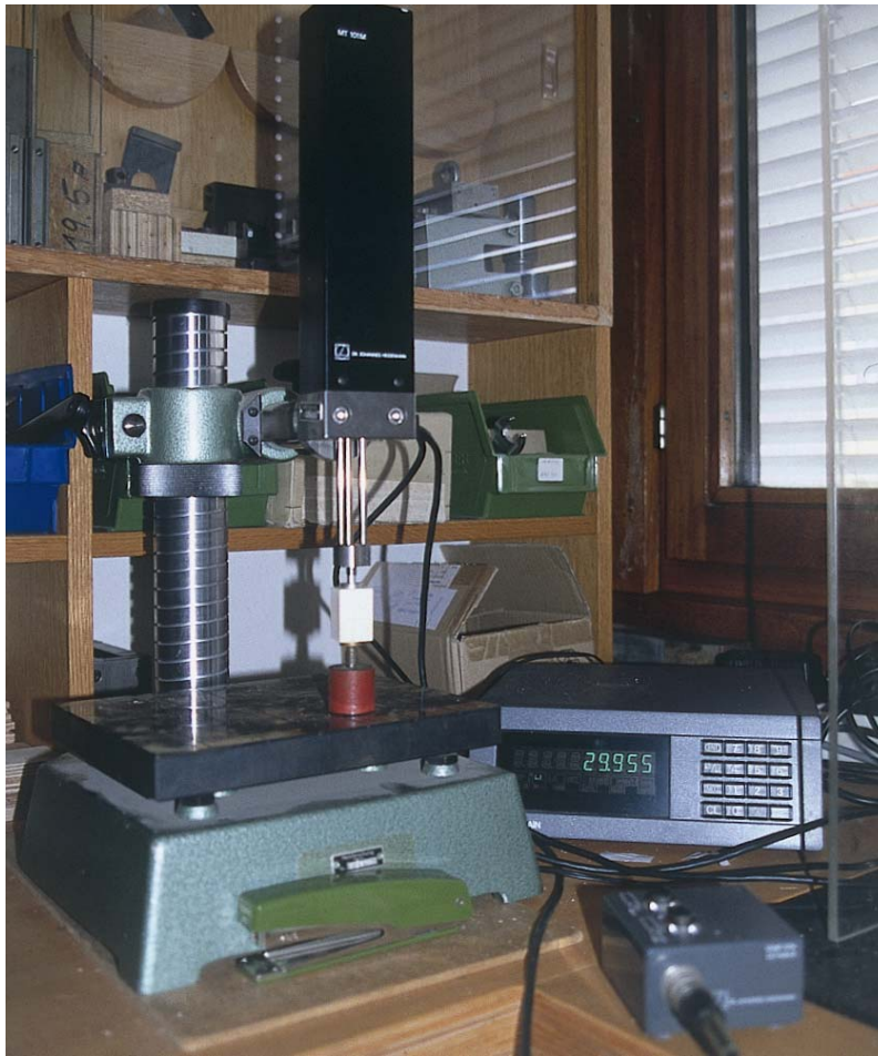
Abb. 20: Meßgerät Haidenhain, zur Ermittlung des Volumens und der Rohdichte von Holzprüfkörpern (Institut für Holzforschung München)
