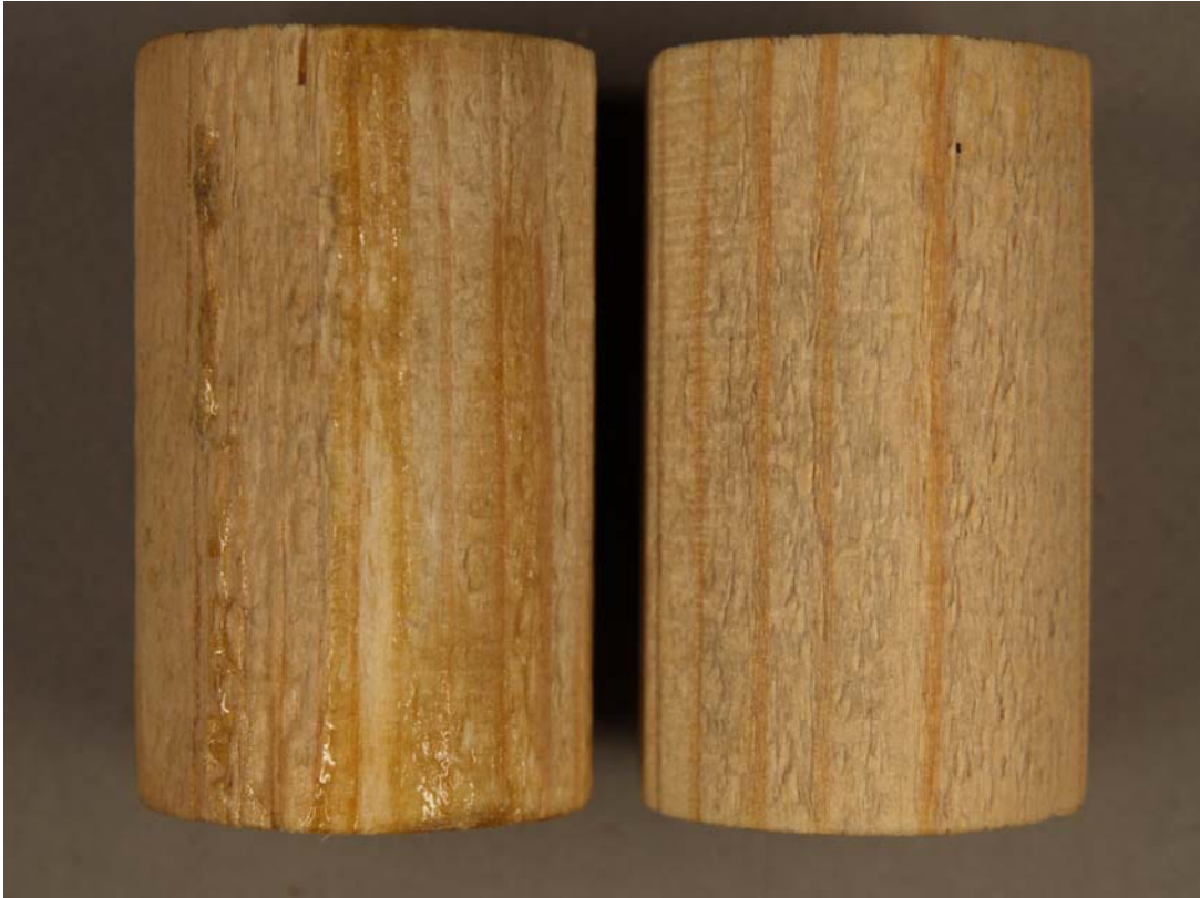
Abb. 4: Kiefernprüfzylinder, Tangentialansicht Links mit MMA getränkt, Rechts unbehandelt
