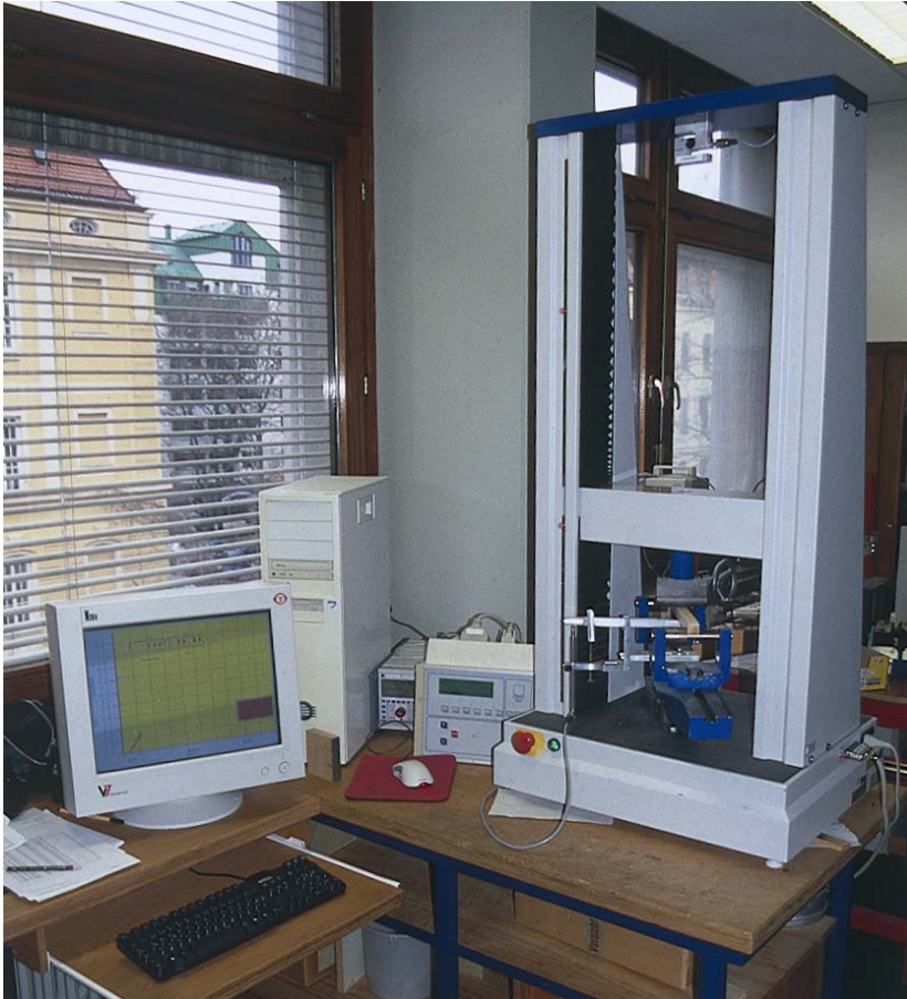
Abb. 22: Biegeprüfeinrichtung (Institut für Holzforschung München)
