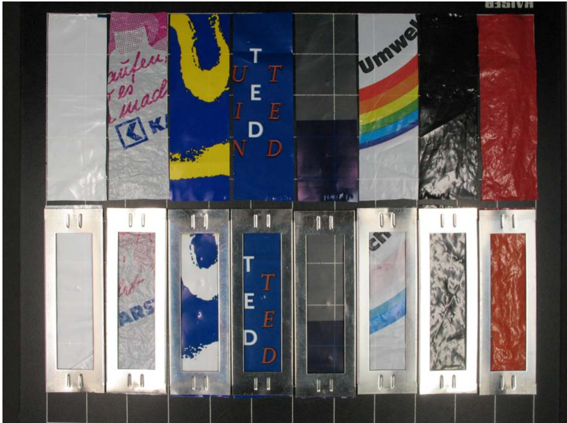
Abbildung 7.1: Folien 1 bis 8 vor der künstlichen Alterung und nach 454 Stunden Bestrahlung im Xenotest (im Metallrahmen).
