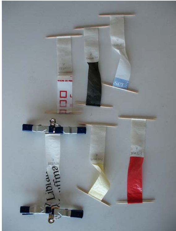
Abbildung 7.7: Verformte Probekörper A bis F mit Beva 371 als Klebstoff.
