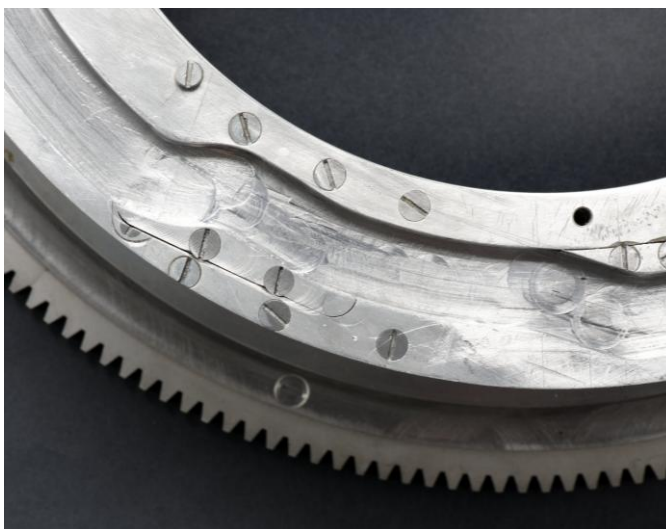
Abb. 36: Helixturm, Rotorscheibe mit Steuerflächen für die Magazinbewegung, Detail der Nachbearbeitung, Foto: Achim Bunz
