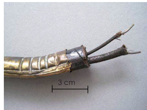
Abb. 90: Gefalzte Rohrdradhtleitung mit Messingmantel, darin imprägniertes Papierrohr mit zwei textilsolierten Kupferdradhtleitungen (evtl. Bergmannrohr), Schloss Erbach (Foto: Edlmann 2009)
