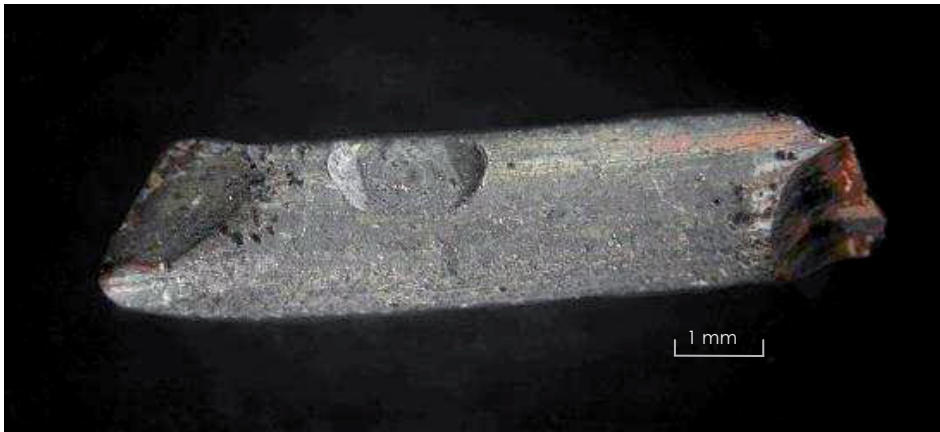
Kupferdraht mit dünner Zinnschicht, Aufnahme unter dem Auflichtmikroskop, 12-fache Vergrößerung, GRUBER 2009.
