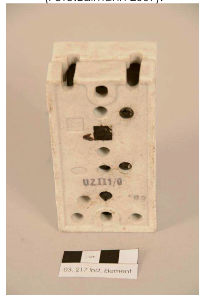
03.317/11 Schmelzsicherung SIEMENS- SCHUCKERTWERKE (Foto:Edlmann 2009).
