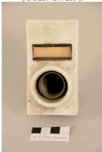
03.317/10 Schmelzsicherung SIEMENS- SCHUCKERTWERKE (Foto:Edlmann 2009).
