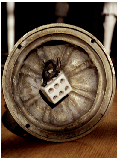
05.121/3 Lüsterklemme im Fuß der Kugellampe aus der Toilette (Foto: Edlmann 2009).
