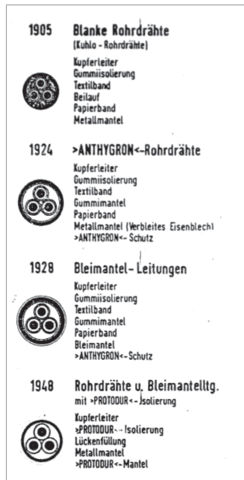
Abb. 26: Rohrdrähte und Bleimantelleitungen (GEYLER 1971, S. 322).
