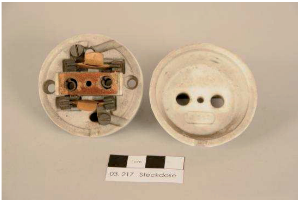
03.317/7 Steckdose Typ S512 der SIEMENS-SCHUCKERTWERKE (Foto:Edlmann 2009).
