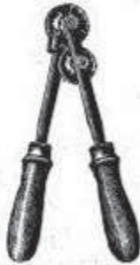
Werkzeug zum Biegen von Rohrdrähten. Abb. 31.
