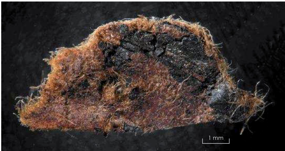
Papierisolierung mit schwarzer Imprägniermasse (möglicherweise öl- und teerhaltig) aus Papier-Mischgarn (?), Aufnahme unter dem Auflichtmikroskop, 12-fache Vergrößerung, GRUBER 2009.
