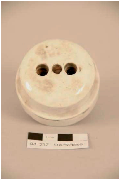
03.317/5 Steckdose Typ S512 der SIEMENS-SCHUCKERTWERKE (Foto:Edlmann 2009).
