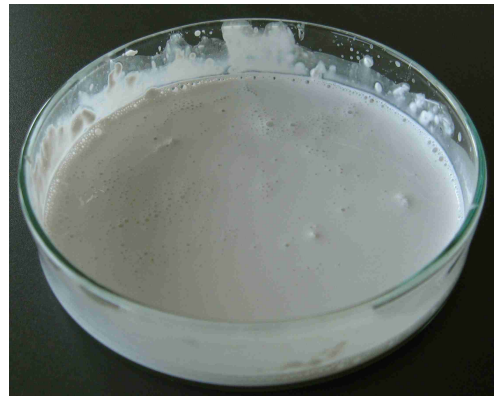
Abb. 26: Durch ständiges Rühren ist eine stufenlose Verdünnung mit Wasser möglich.
