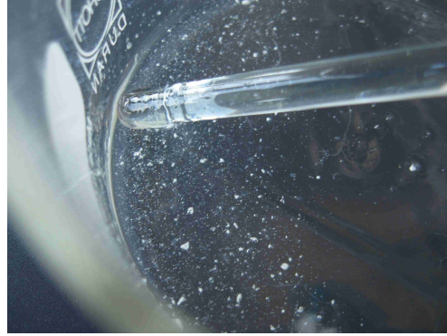
Abb. 38: Durch das Mischen von Polymer und Kieselsäure erhält man wieder eine durchsichtige, allerdings nicht vollständig transparente Masse. Diese Färbung behält der fertige Siliconkautschuk bei.
