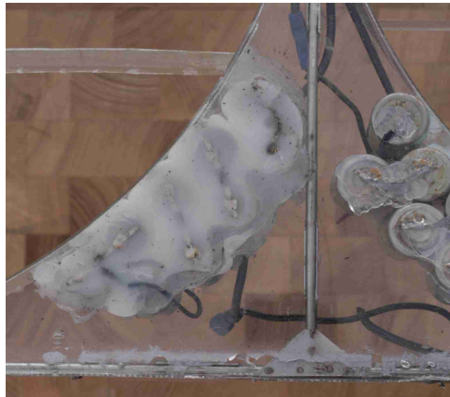
Abb. 74: Ergänzungsklebung aus weißem Siliconkautschuk (links), rechts daneben vom Künstler ausgeführte Klebung.
