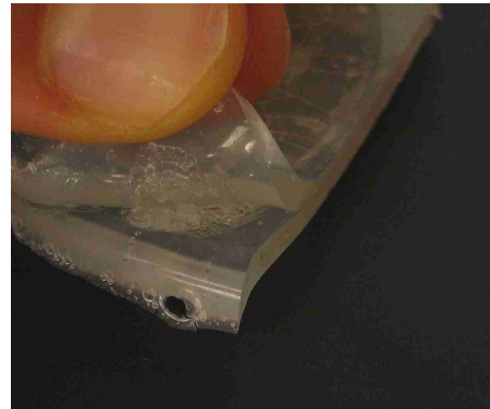
Abb. 22: Eine mechanische Lösung der Klebung ist nur unter Beschädigung der Fügeiteile möglich.
