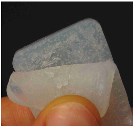
Abb. 24: Die Haftung des Klebstoffs am Siliconkautschuk übersteigt dessen Reißfestigkeit.
