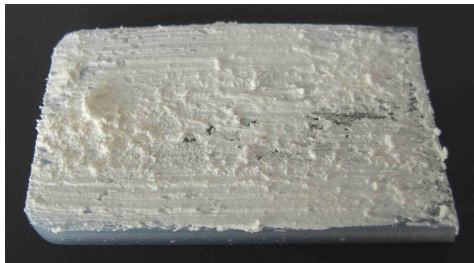
Abb. 32: Unverdünnter Aufstrich des wässrig dispergierten Siliconkautschuks. Ein gleichmäßiger Auftrag ist nicht möglich.
