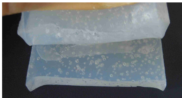
Abb. 63: Bei der mechanischen Lösung der Klebung verbleiben transparente Schleier auf dem Fügeiteil (K4).
