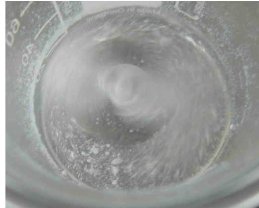
Abb. 47: Mischen der Komponenten mittels Magnetrührer.
