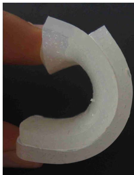
Abb. 35: Der Klebstoff kann die elastische Verformung der Fügeiteile nachvollziehen ohne an Klebkraft zu verlieren.
