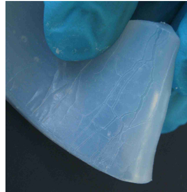
Abb. 85: Auf dem anderen Probekörper verbleibt der ausgehärtete Klebstoff.
