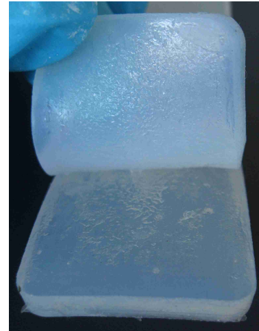
Abb. 87: Kohäsionsbruch des Klebstoffs nach der Prüfung.
