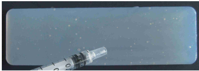
Abb. 83: Auftragen des Klebstoffs, hier der additionsvernetzende Siliconkautschuk (Ansatz A2) auf den Probekörper.
