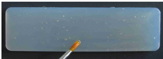
Abb. 84: Mit dem Pinsel kann dieser Klebstoff verteilt werden. Anschließend werden beiden Probekörper zu einem Prüfkörper zusammengefügt.
