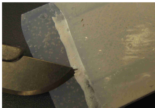
Abb. 36: Eine mechanische Abnahme ist mühsam und nicht immer erfolgreich, da sich die elastischen Siliconkautschuke sich sehr stabil verbinden.
