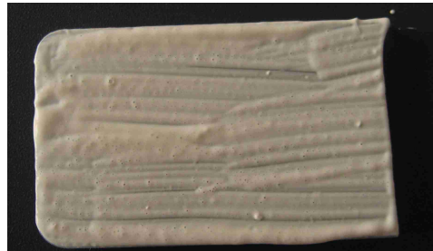
Abb. 31: Aufstrich mit 20 %iger Verdünnung mit Wasser. Die geringere Viskosität erleichtert den Auftrag.
