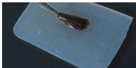
Abb. 57: Aufstreichen des Klebstoffs (K1).
