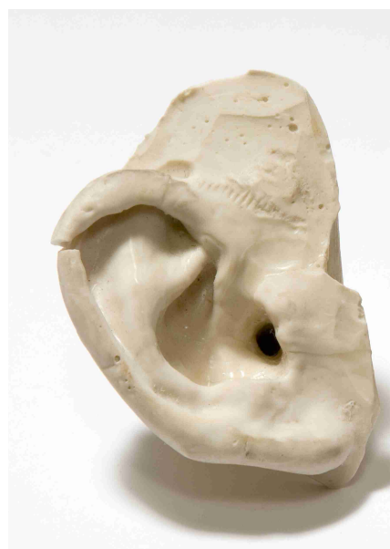
Abb. 6: Detail des Ohres: Riss im Siliconkautschuk. [© Deutsches Museum München, Bild Nr. L_6278_26]
