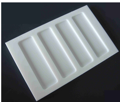
Abb. 81: Gussform der Probekörper.
