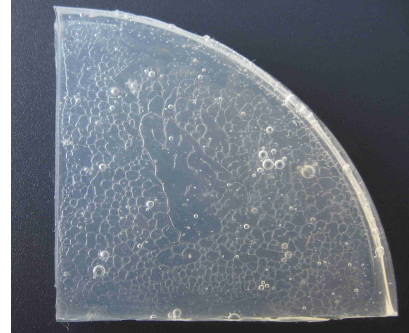
Abb. 10: Nach der Trocknung des PVAc ist ein deutliches Rissbild in der Klebeschicht sichtbar, die Klebung aber relativ stabil.
