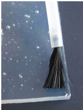
Abb. 17: Auftrag des Primers.
