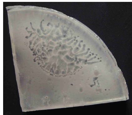
Abb. 29: Nach der Vernetzung des Klebstoffs zeigen sich bei einigen Probekörpern Benetzungsprobleme.
