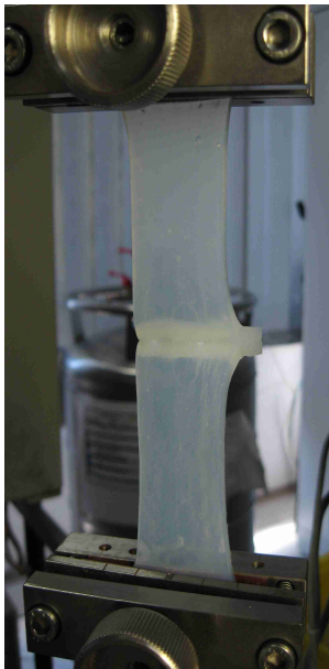
Abb. 88: KSE-Klebstoff während der Prüfung, der Probekörper wird auf Grund der höheren Zugkräfte stark gedehnt.
