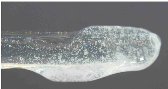
Abb. 52: Die hohe Viskosität des Polymers bewirkt einen ebenfalls hochviskosen Silcionkatuschuk (hier Ansatz P1).
