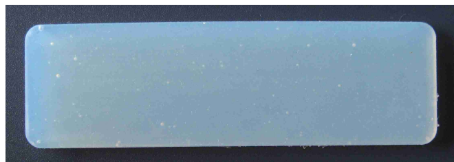
Abb. 82: Probekörper aus Elastosil M 4600.
