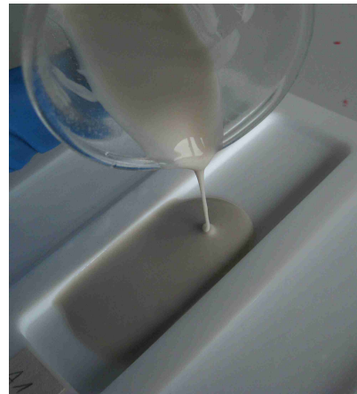
Abb. 51: Ansätze mit dem niedrigviskosen Polymer der Additionsvernetzung sind deutlich flüssiger.
