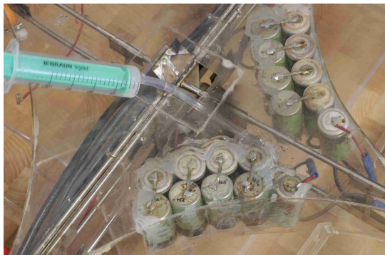
Abb. 79: Applizieren des additionsvernetzenden Siliconkautschukes zwischen Polycarbonat und vorhandener Klebung.
