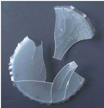
Abb. 60: Ansatz K3 (2,5 RT Polymer) ist deutlich spröder.
