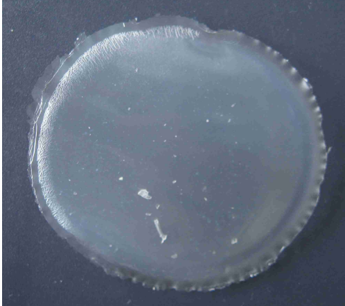
Abb. 58: Ansatz K1 (5 RT Polymer) nach der Aushärtung.
