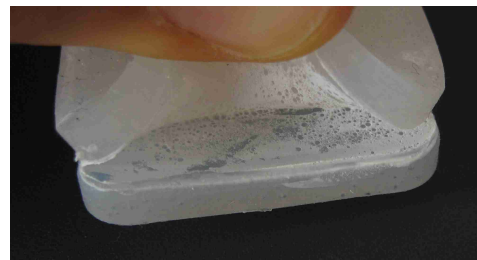
Abb. 34: Der verdünnte Siliconkautschuk haftet gleichmäßiger am Fügeiteil.
