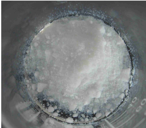
Abb. 46: Additionsvernetzender Siliconkautschuk (A1): Polymer und aktiver Füllstoff.
