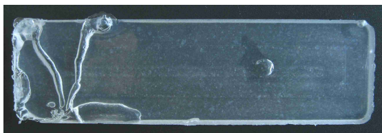
Abb. 54: Unregelmäßige Vernetzung des additionsvernetzenden Siliconkautschuks (A2).
