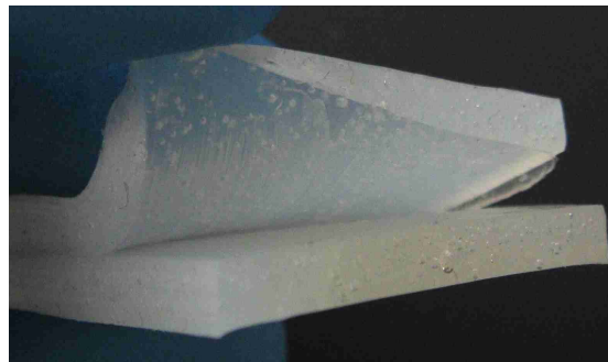
Abb. 14: Nach dem Erstarren des Ethylenacetat-Ketonharzes lösen sich die Füge­teile bereits bei geringer mechanischer Belastung voneinander.
