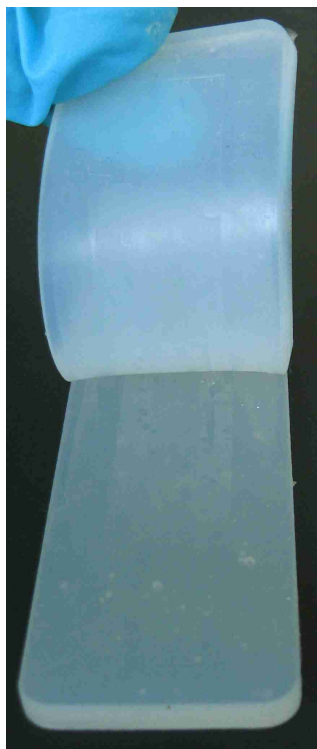
Abb. 91: Prüfkörper Nr. 1 nach der Prüfung.
