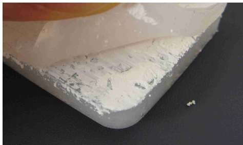
Abb. 33: Die Haftung des unverdünnten Aufstrichts ist nach dem Vulkanisieren beeinträchtigt, da ein Fügeiteil nicht vollständig benetzt wurde.
