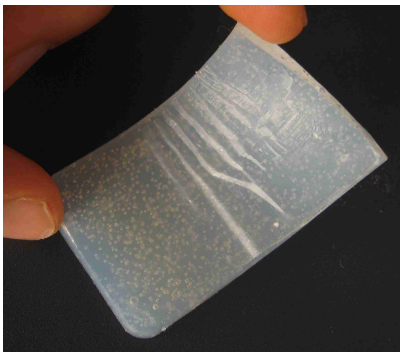
Abb. 15: Das ausgehärtete Harz löst sich vom Probekörper.
